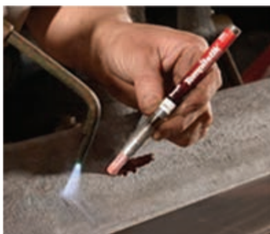
شکل ۴-۱۸- اندازه‌گیری دما توسط گچ‌های حرارتی
