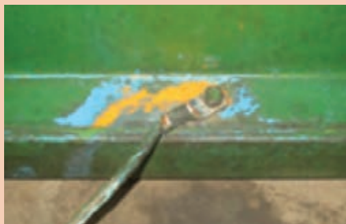
شکل ۱-۲۳- نمونه‌ای از سیم ارت در گیوتین
