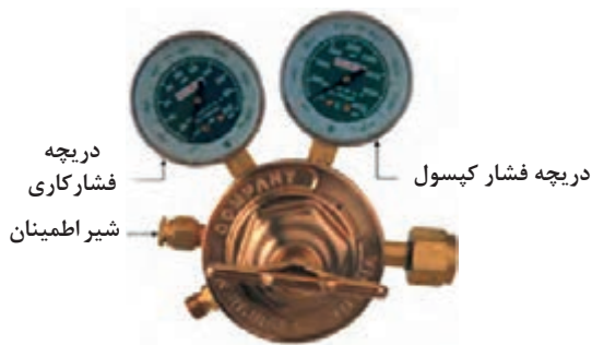
شکل ۳-۱۵- شیرهای اطمینان در رگولاتور اکسیژن
