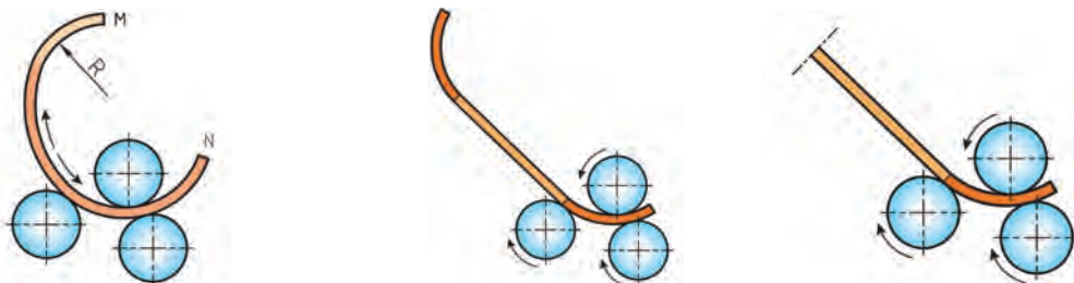
شکل ۷-۲- مراحل رول کاری با دستگاه نورد صاف‌کننده ساده
