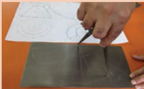
شکل ۳۷-۱- خط کش ورق فلزی با خط کش و پرگار فلزی
