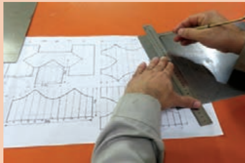
شکل ۳۳-۱- خط کشی ورق فلزی با خط کش فلزی
