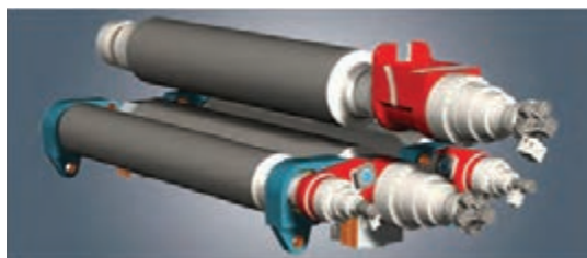
شکل ۲-۹- نمایی از نحوه قرارگیری غلتک‌ها در نورد صاف کننده چهار غلتک
