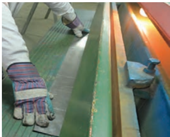
شکل ۷-۱- تنظیم خط برش با چشم توسط اپراتور
