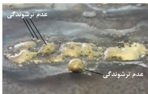
شکل ۴-۲۱- عدم ترشوندگی سطح فلز را به دلیل سرد بودن درز اتصال، نشان می‌دهد.
