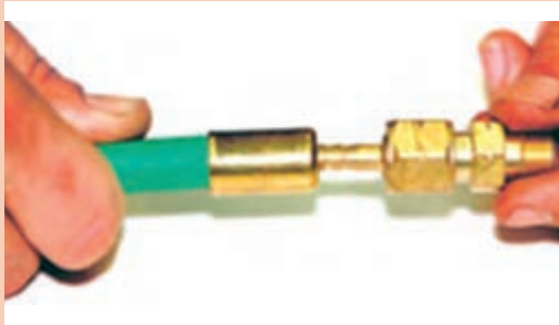
شکل ۳-۳۵- پیچ کردن سرپیچ به درون شیلنگ و فشار دادن پستانک داخل شیلنگ
