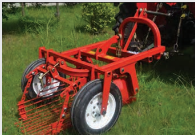
شکل ۱۳- اتصال سیب زمینی کن لرزان به تراکتور
