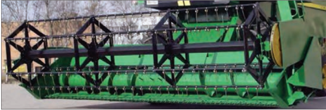
شکل ۱۰- پلاتنفرم مجهز به چرخ و فلک انگشتی دار
