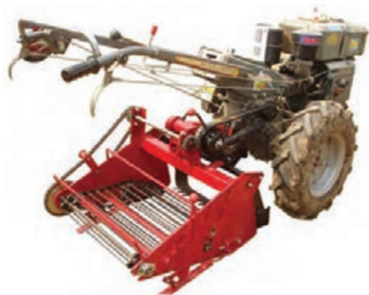
شکل ۷- سیب‌زمینی‌کن نقاله‌ای مخصوص تراکتور دو چرخ
