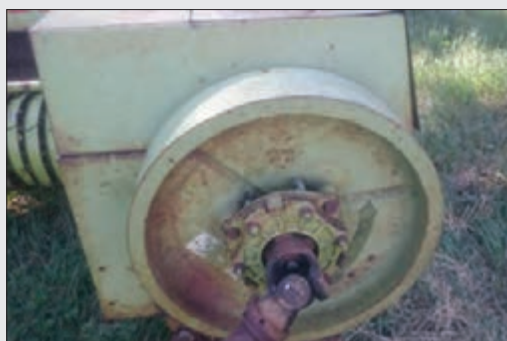
شکل ۸۵- پیکان نشان دهنده جهت چرخش چرخ لنگر
