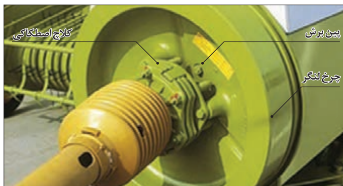
شکل ۸۰- چرخ لنگر و کلاچ ایمنی
