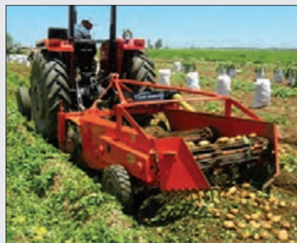
شکل ۱۷- برداشت سیب‌زمینی با سیب‌زمینی‌کن نقاله‌ای
