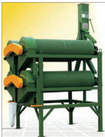
شکل ۱۳- ماشین بوجاری استوانه حفره‌دار
