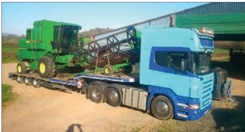
شکل ۳۳- حمل کمباین به وسیله یدک کش
