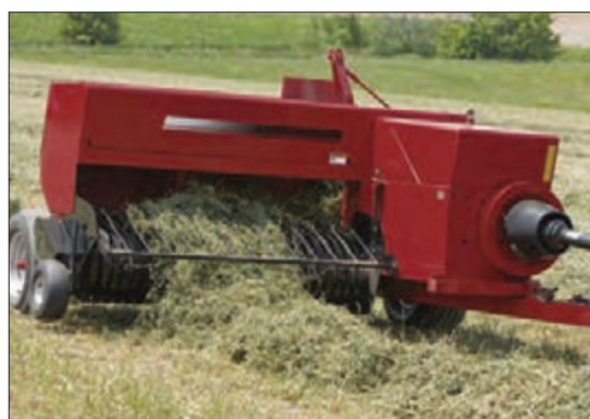
شکل ۷۱- واحد بردارنده بسته‌بند
