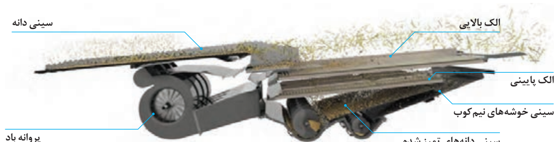
شکل ۲۵- مسیر حرکت محصول در واحد تمیز کننده
