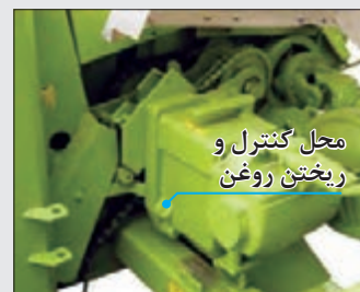
شکل ۴۵- جعبه دنده باردهی غلتک‌های تغذیه
