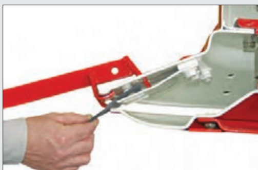
شکل ۲۲- شکل شماتیک از تعویض تیغه دروگر استوانه‌ای
