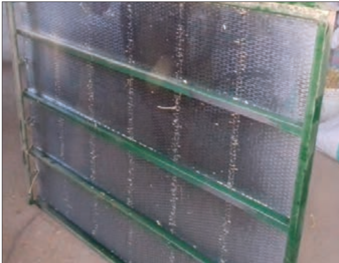
شکل ۳۹- قرار دادن غربال به صورت آویزان
