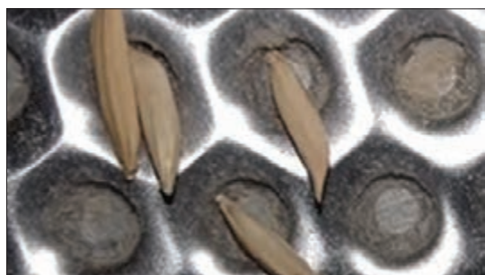
شکل ۱۶- قرار گرفتن دانه‌ها در سوراخ‌های استوانه حفره‌دار
