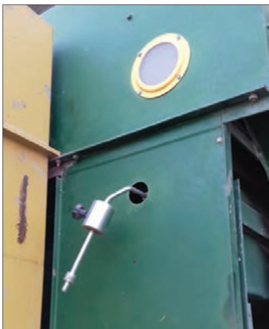
شکل ۳۳- وزنه تنظیم ضربه زن غربال بالایی
