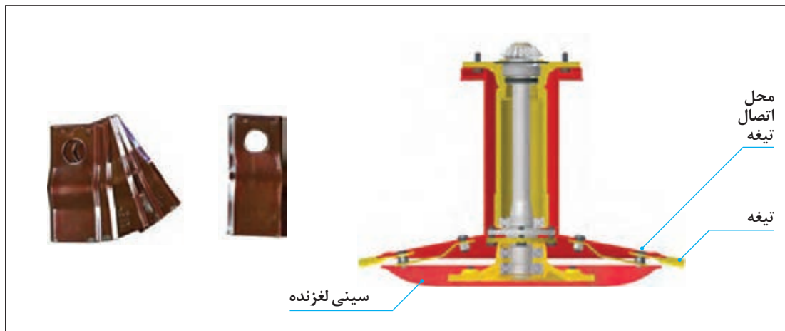
شکل ۴- تیغه و محل قرارگیری آن روی استوانه
