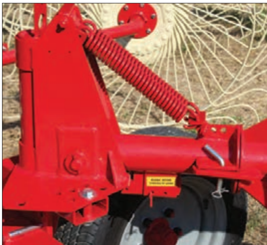
شکل ۶۰- فنرهای شناوری شانه خورشیدی
