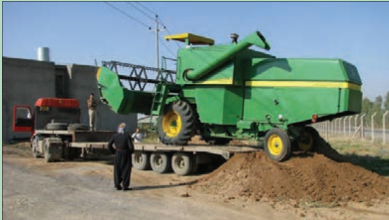
شکل ۳۵- نحوه قرار گرفتن کمباین روی یدک کش
