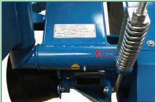
شکل ۲۱- شاخص تنظیم کشش تسمه دروگر استوانه‌ای
