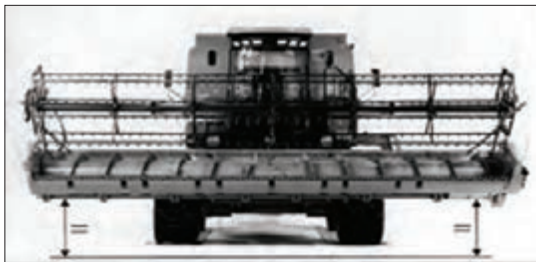
شکل ۳۷- اندازه‌گیری تراز بودن پلاتفرم
