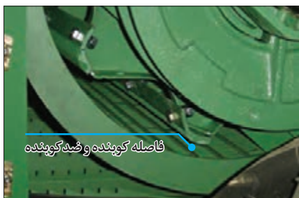
شکل ۴۳- تنظیم فاصله کوبنده
