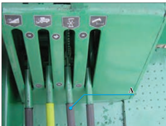
شکل ۳۹- اهرم تنظیم سرعت پروانه چرخ و فلک
