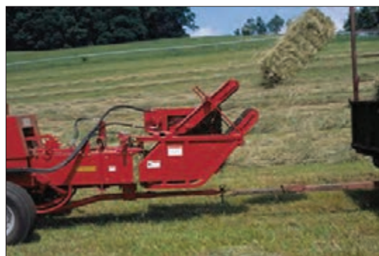
ب) بسته‌بند مجهز به بسته پرتاب کن
