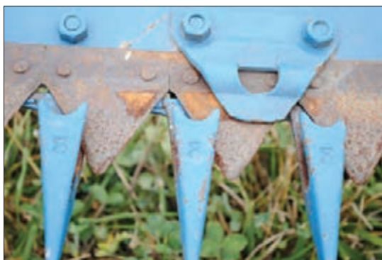
شکل ۱۰- موقعیت انگشتی و تیغه در دروگر شانه‌ای
