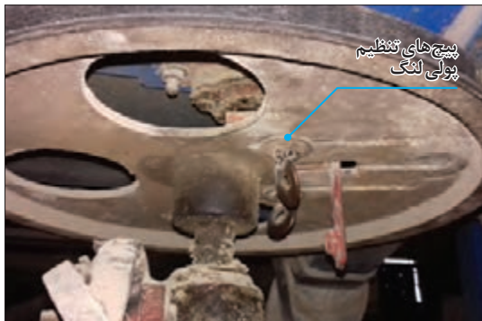
شکل ۳۴- پیچ تنظیم کورس غربال کابلی
