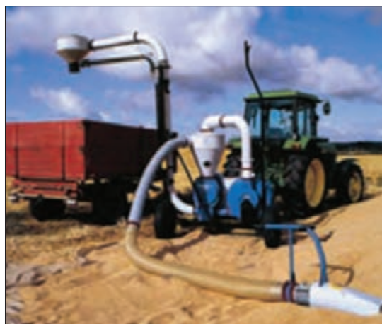
شکل ۲۹- نقاله بادی و طرز کار آن
