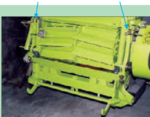
شکل ۲۸- اهرم‌های تنظیم تیغه ثابت در چاپر خودگردان
