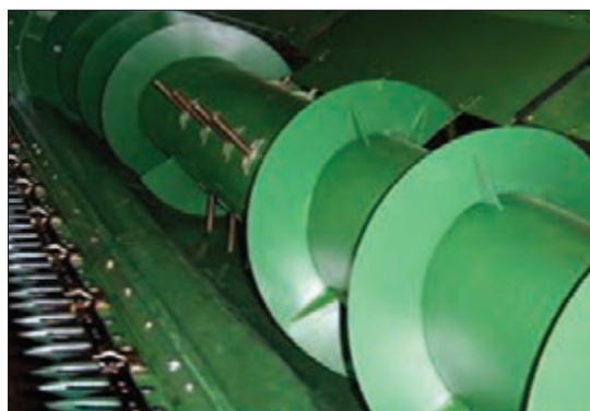
شکل ۸- نقاله پیچی واحد برش
