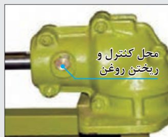
شکل ۴۶- جعبه دنده زانویی تیغه درو
