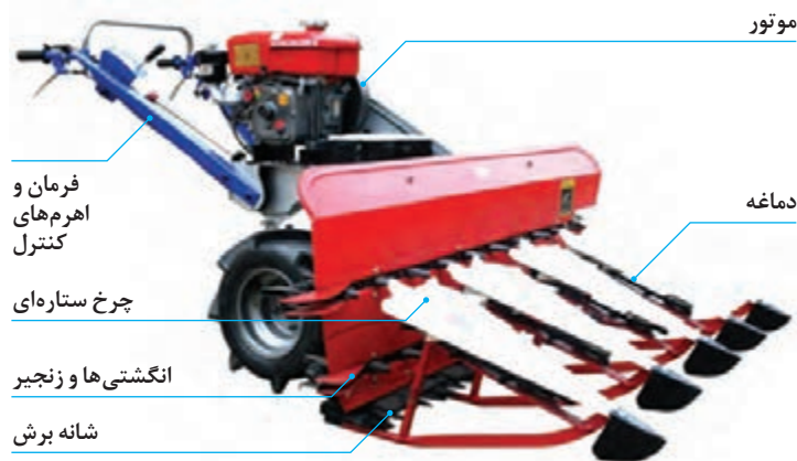
شکل ۱- درو ردیف‌کن و کاربرد آن
