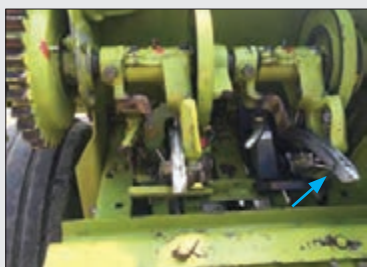
شکل ۹۳- تحویل نخ به نخ‌گیر
