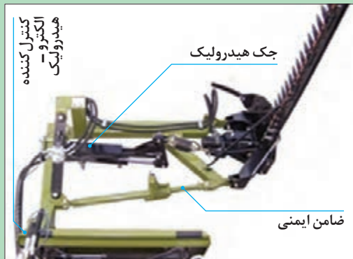
شکل ۱۷- دروگر شانه‌ای با سیستم محرک ارتعاشی
