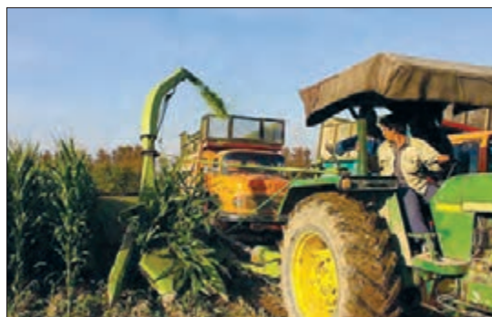
شکل ۳۲- تناسب لوله تخلیه با ماشین حمل
