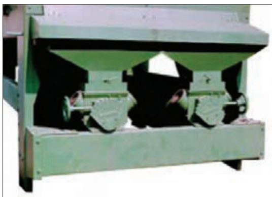
شکل ۳۶- تنظیم کننده‌های استوانه حفره‌دار
