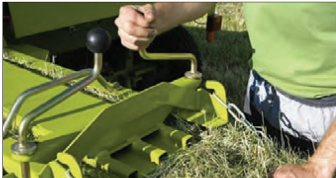
شکل ۱۰۱- تیرک‌های فشاردهنده و تنظیم آن
