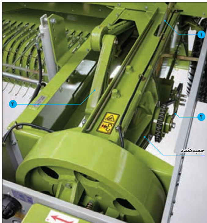
شکل ۸۲- مسیر انتقال توان در بسته‌بند
