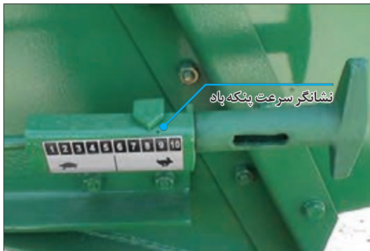
شکل ۴۴- اهرم تنظیم سرعت پنکه
