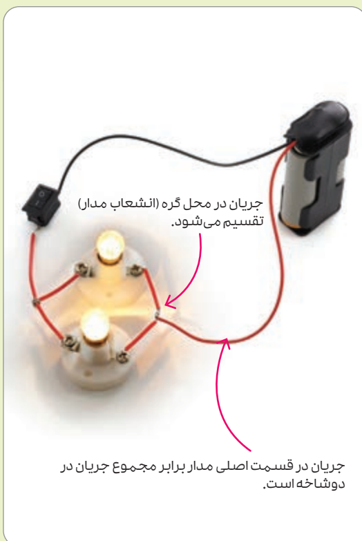
⚡ (ب) در این مدار لامپ‌ها و باتری به طور موازی به هم وصل شده‌اند.
