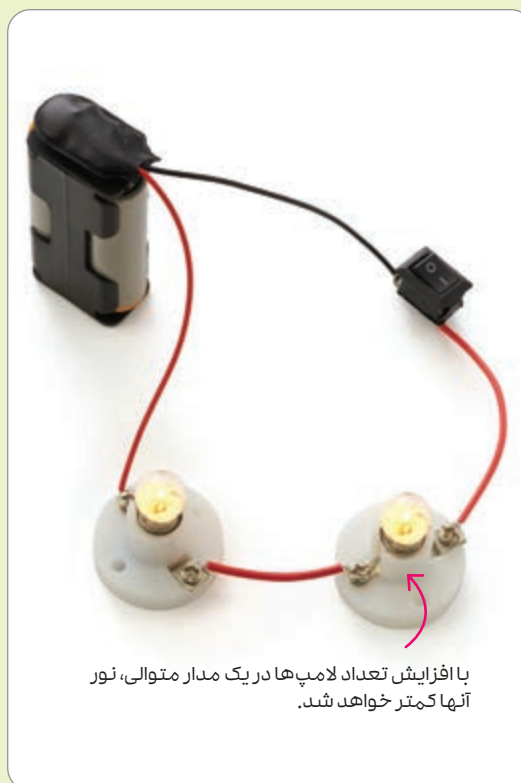
⚡ (الف) در این مدار کلید، لامپ‌ها و باتری به طور متوالی به هم وصل شده‌اند.
