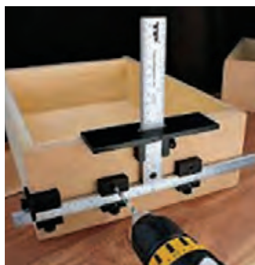
شکل ۱۳۴- چند نوع شابلون سوراخ کاری محل دستگیره
