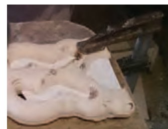
شکل ۲۲- ثابت کردن رحل چوبی به میز کار
