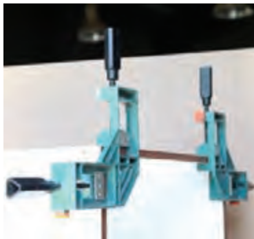
شکل ۵۲ - فیکس کردن قطعات
