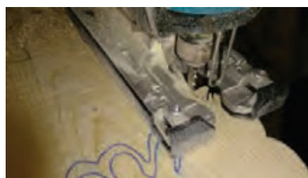
شکل ۱۶- انتقال طرح شابلون روی چوب
