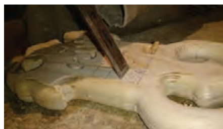
شکل ۲۳- مغارکاری مفصل‌ها به صورت غلط
