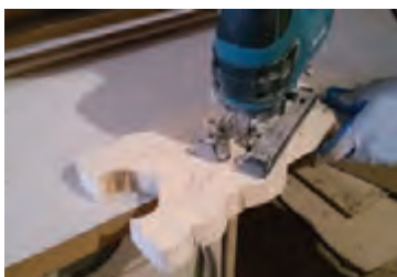
شکل ۱۹- قرارگیری تیغه داخل سوراخ مته
