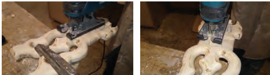
شکل ۲۶- برش طولی مفصل با اره عمودبر
