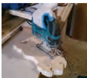
شکل ۱۷- عملیات برش کاری با اره عمودبر
