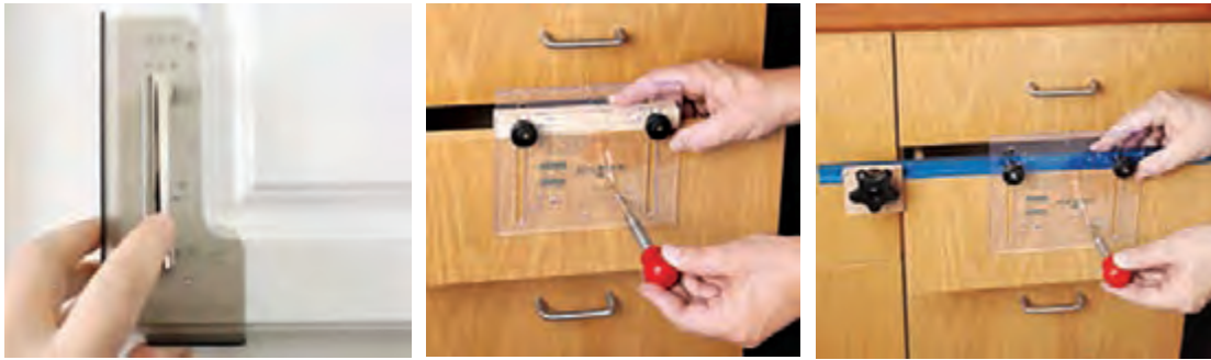
شکل ۱۳۵- چند نوع شابلون سوراخ کاری محل دستگیره
