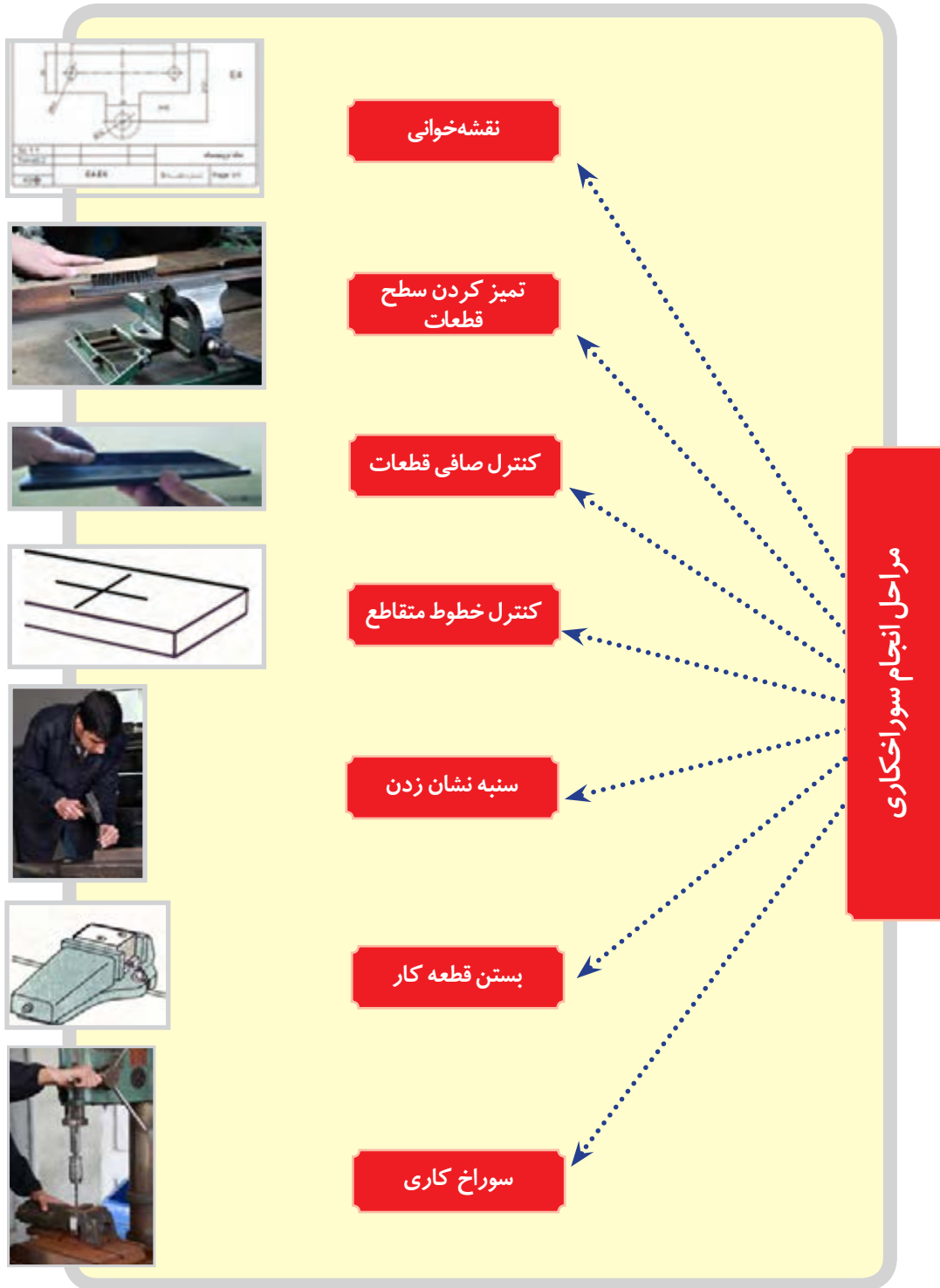
نمودار ۲-۳ مراحل انجام کار در سوراخ کاری
