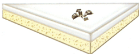
شکل ۳-۲۵ اتصال قطعات غیر فلزی با میخ پرچ افشان
