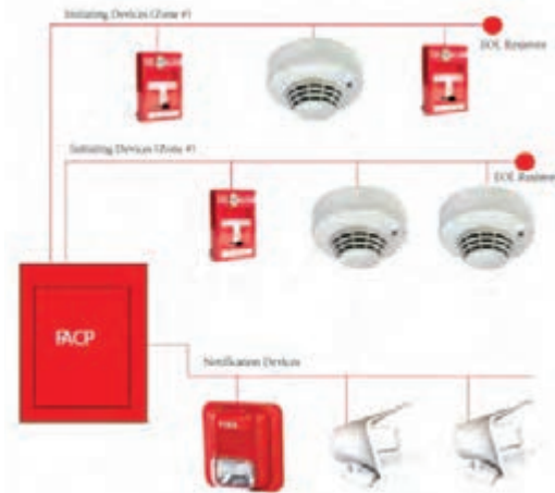
اعلام حریق متعارف
