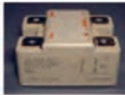
بل دیود با قدرت بالا با بسته سرامیکی
