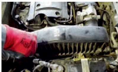
شکل ۲۸-۳ روش عوض کردن فیلتر هوای موتور
