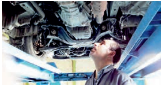
شکل ۴-۶- قرار گرفتن خودرو روی جک بالا بر و دیدن محل های احتمالی نشتی
