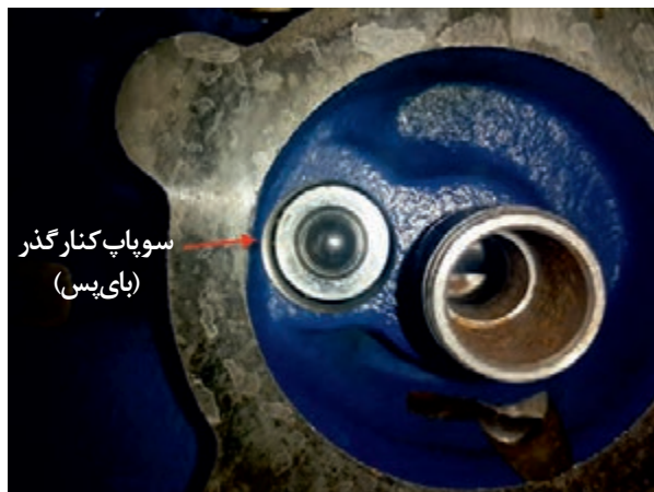
شکل ۳-۱۶- سوپاپ کنار گذر قرار داده شده در مدار روغن کاری موتور
