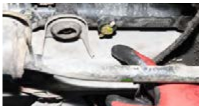
شکل ۷-۲۹- تخلیه مایع خنک کننده موتور به روش دستی
