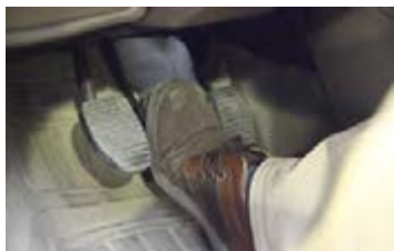
۳ پدال ترمز چندین بار فشرده می‌شود تا پدال زیر پا سفت شود.
