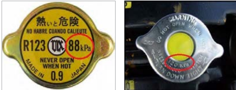
شکل ۷-۲۵- محل نوشته شدن فشار کارکرد روی در چند رادیاتور
