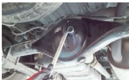
شکل ۴-۵- روش بررسی سطح و رنگ روغن دیفرانسیل عقب محرك
