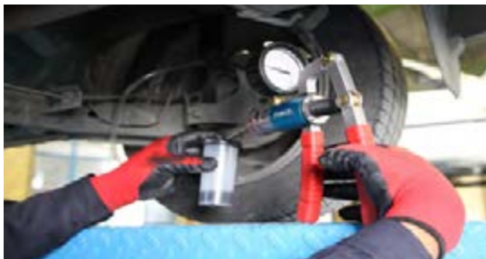
شکل ۱۲-۶- نمونه‌ای از دستگاه خلأیی هواگیری سیستم ترمز
