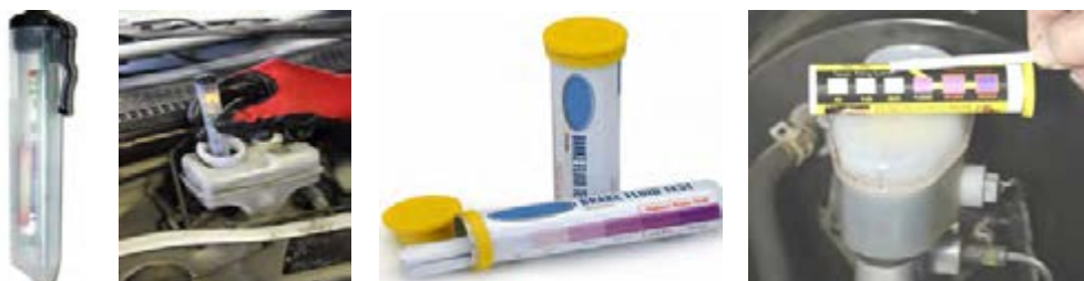
شکل ۶-۶- آزمایش کیفیت مایع هیدرولیک ترمز
