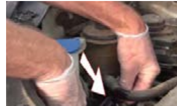
۱ لوله برگشت مایع هیدرولیک به مخزن جدا شده و مجرای ورودی به مخزن مسدود شود.
