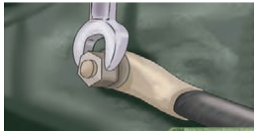
شکل ۱۱-۹- اتصال منفی یا اتصال بدنه قسمت موتور
