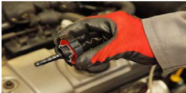
شکل ۷-۵ - شاخص‌های روی درپوش مخزن مایع هیدرولیک فرمان
