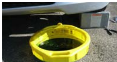
شکل ۷-۲۹- تخلیه مایع خنک کننده موتور به روش دستی
