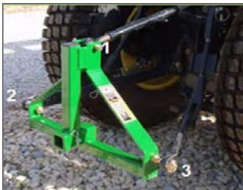
شکل ۸- نقاط اتصال سه‌گانه تراکتور
