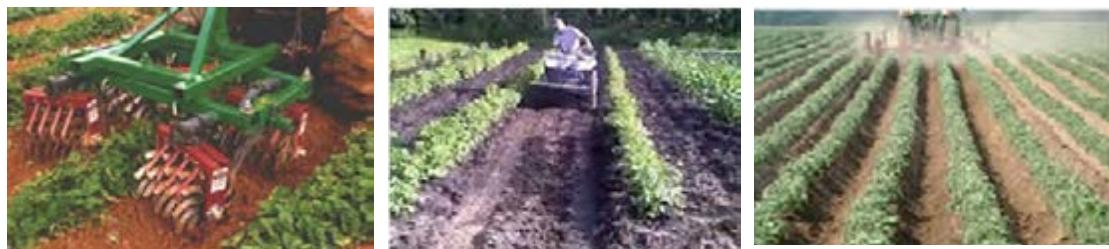
ماشین‌ها اغلب به پشت تراکتور متصل‌اند؛ اما گاهی نیز از بیل جلو تراکتور برای خاکدهی استفاده می‌شود.
