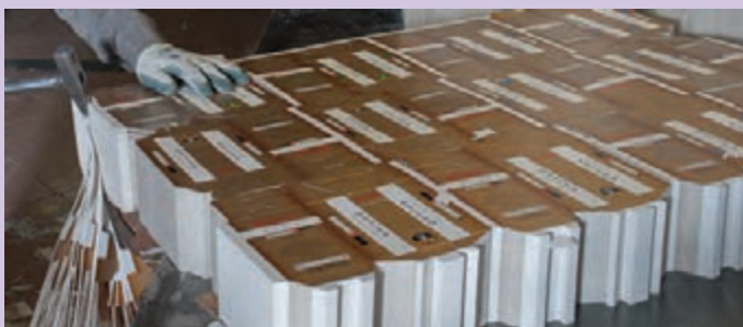
تصویر ۱۳ پوشال گیری و جداسازی محصولات چاپی (جعبه) از اضافه های چاپ
