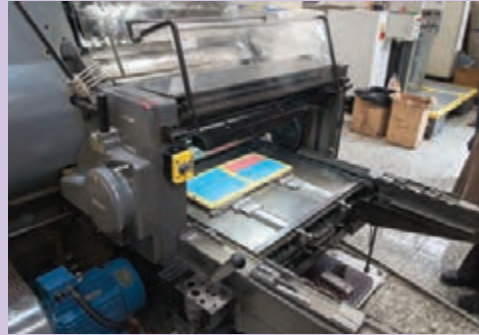
تصویر ۱۰ نصب قالب روی ماشین لترپرس
