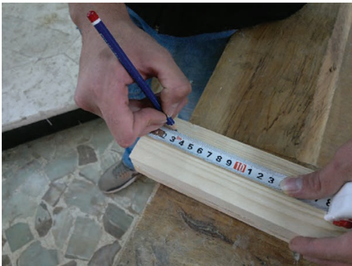
اندازه‌گیری و اندازه‌گذاری صحیح قطعه کار
