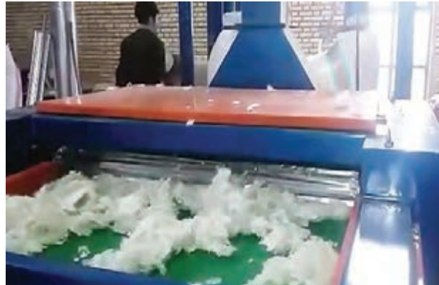
حلاجی پنبه به روش ماشینی
