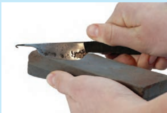
تیز کردن قلاب با سنگ نفت
