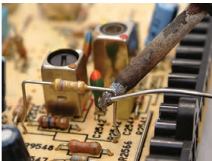
شکل ۲-۳۰- لحیم‌کاری مجدد پایه قطعه شده پس از اتمام کار
