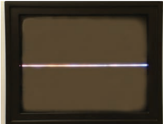
شکل ۲-۸۶- اسیلاتور عمودی از کار افتاده است.
