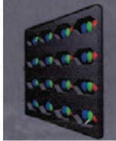
شکل ۱-۲۴- ماسک مشبک در مقیاس بزرگ تر
