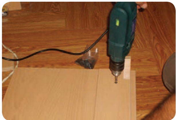
شکل ۱۴۶-۵- آماده‌سازی بدنه کمد لباس و نصب مانع
