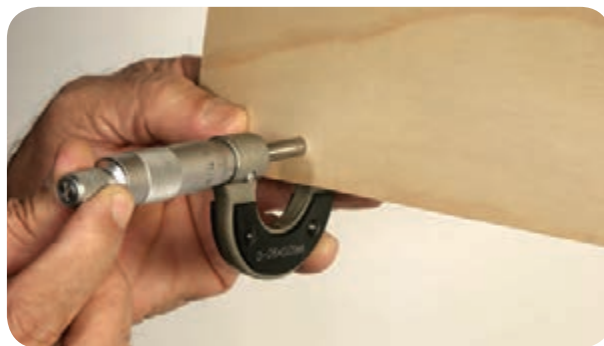
شکل ۷۲-۵ اندازه‌گیری ضخامت روکش با میکرومتر
