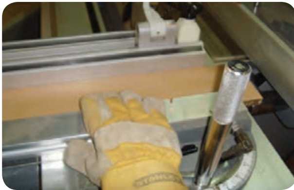
شکل ۱۰۷-۵- استفاده از گونیای کشویی میز متحرک ماشین اژه پانل‌پر
