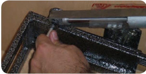
شکل ۵-۱۳۶ محکم کردن پایه‌های جک‌های تختخواب
