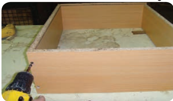
شکل ۱۵۳-۵- پیچ کردن جلو و عقب داخل جعبه کشو به بدنه‌ها
