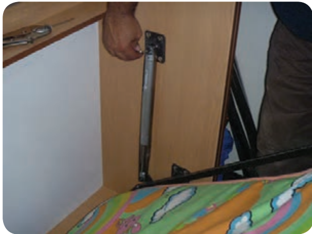
شکل ۵-۱۳۷ تنظیم فشار گاز سیلندر برای تعادل تختخواب
