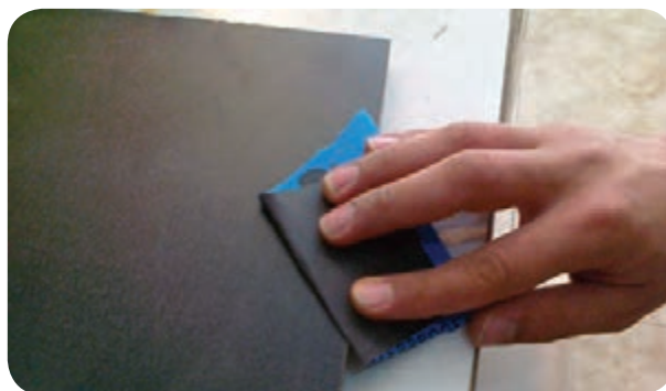
شکل ۴-۳۰ - پرداخت لبه لبه‌های نوار شده با سنباده
