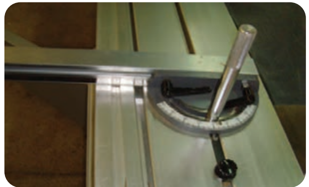
شکل ۵-۵۲- گونیای کوچک قابل تنظیم برای برشکاری
