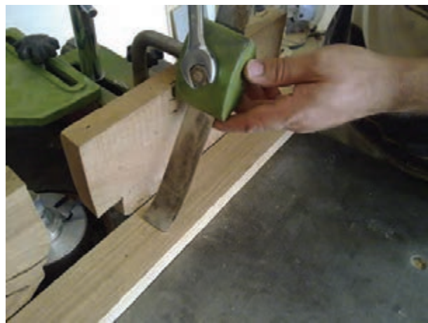
شکل ۲-۲۹- بستن حفاظ فیزی
