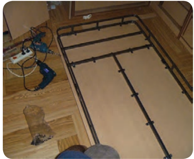
شکل ۱۳۰-۵- استقرار کلاف فلزی روی صفحه جلو تختخواب
