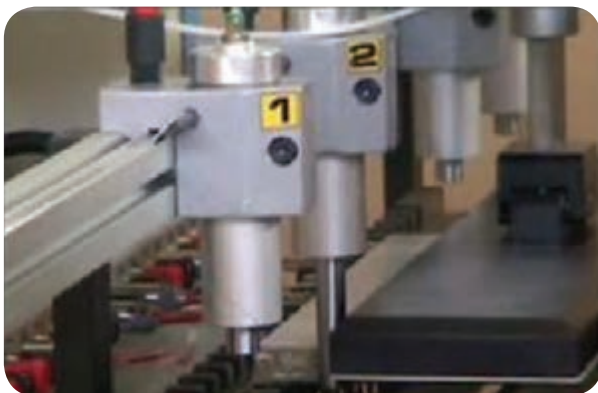
شکل ۳-۷ - قطعه کار، توسط جک‌ها گونیا شده است.
