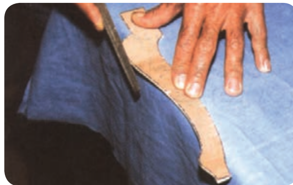
شکل ۵-۲۱- تهیه شابلن خط‌کشی برای ساخت پایه
