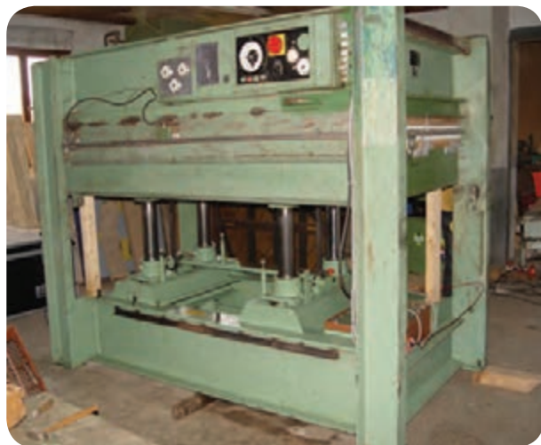
شکل ۷۴-۵ پرس گرم المنتی دو طبقه هیدرولیکی
