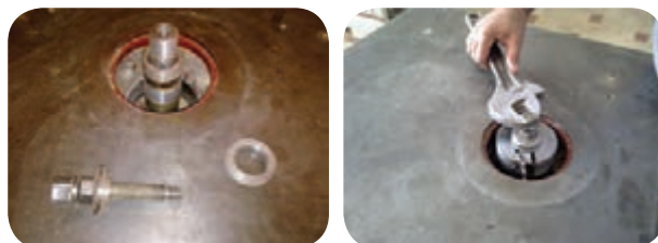
شکل ۲۸-۲- تنظیم کردن تویی در دستگاه فرز
