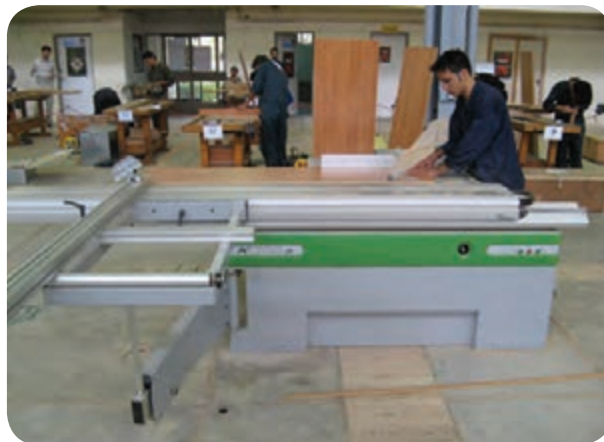
شکل ۱۱۵-۵- برشکاری قطعات سقف و کف
