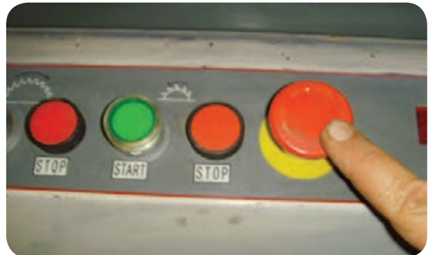
شکل ۵-۶۷- کلید خاموش کردن کلی ماشین دور کن
