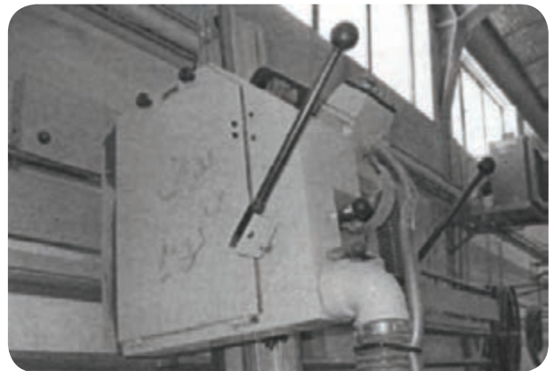
شکل ۳۹-۵- اهرم حرکت اره برای برش
