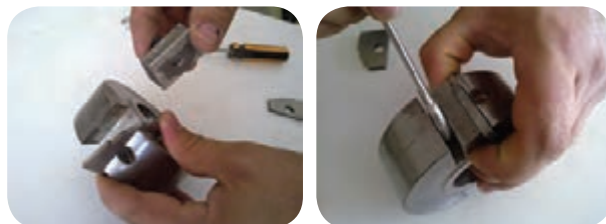
شکل ۲۷-۲- تنظیم و محکم کردن تیغه داخل تویی
