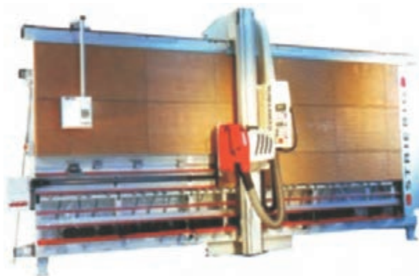
شکل ۳۶-۵- اره صفحه بر یا پانل بر اتوماتیک
