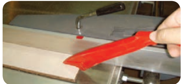
شکل ۱۰۵-۵- هدایت قطعه باریک به وسیله کمکی
