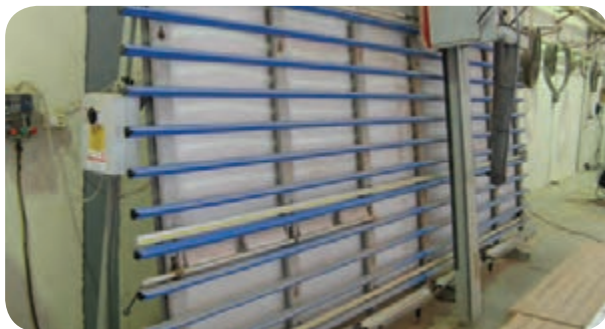
شکل ۳۷-۵- پانل بر عمودی ساده
