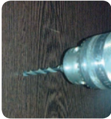
شکل ۱-۶ سوراخکاری دکور با مته چوب یا آهن
