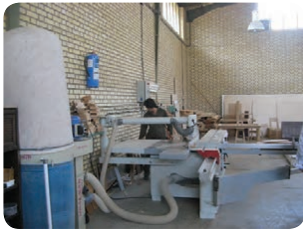
شکل ۵-۵۹- مکنده مناسب ماشین دورکن
