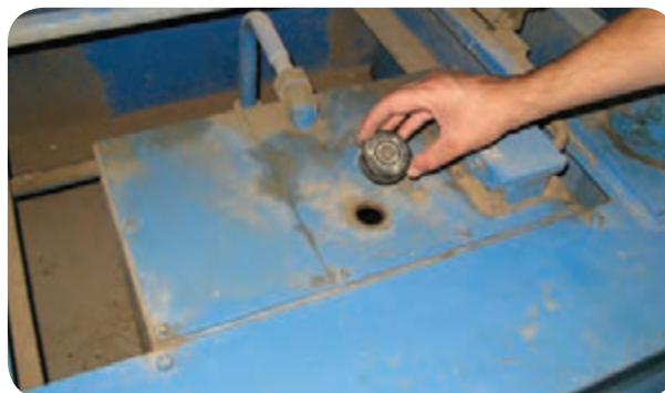
شکل ۸۸-۵- کنترل و تعویض روغن هیدرولیک مخزن
