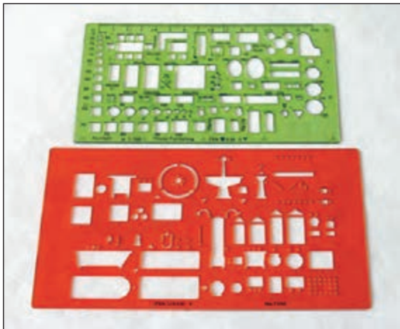
شکل ۱۰۱-۱ انواع شابلن‌های مبلمان و تأسیسات
