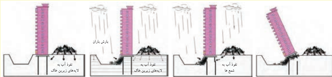
۱- حفاری قسمت جنوبی و دپوی خاک در قسمت شمالی ساختمان
