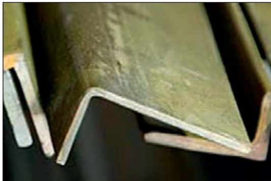
شکل ۲-۳۶ نبشی دو بال نامساوی
