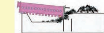
۵- سقوط ساختمان به طور یکپارچه و بدون از هم گسیختگی ترکیب ساختمان
