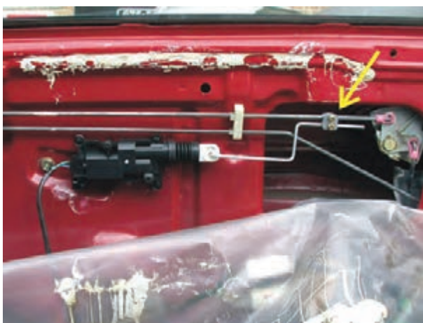
شکل ۳۱-۲ اتصال میله‌ی رابط عملگر الکتریکی به اهرم‌بندی قفل در خودرو
