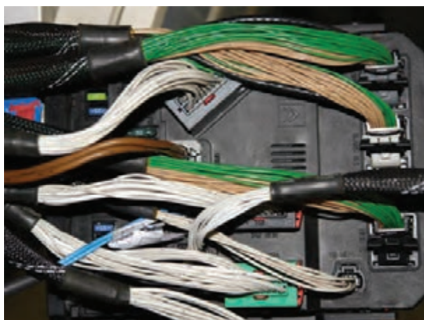
شکل ۱-۱۳۶- اتصال سیم‌کشی به جعبه‌ی فیوز در یک نوع خودرو
