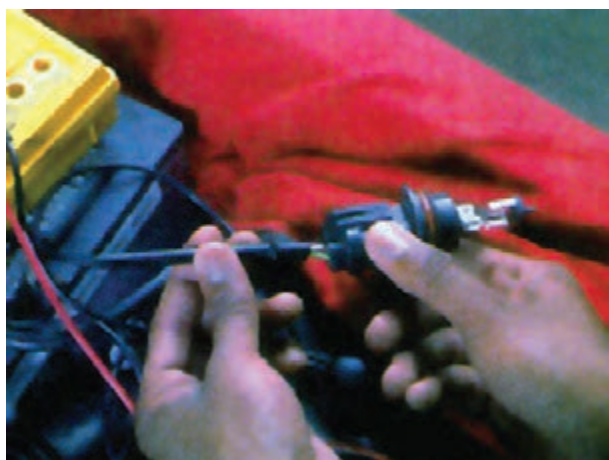
شکل ۱۴۲-۱- آزمایش لامپ چراغ‌های بزرگ جلو
