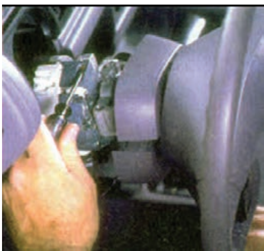
شکل ۱-۹۵- باز کردن پیچ بدنه سوئیچ روشنایی
