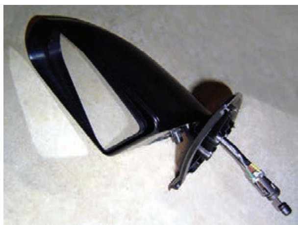
شکل ۱۵۶-۲- آینه‌ی جانبی و مکانیزم حرکت آن
