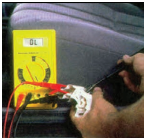
شکل ۹۸-۱- آزمایش حالت استپ موقت دسته‌ی راهنما
