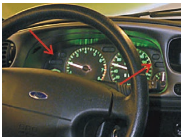
شکل ۱-۲۰۱- محل چراغ‌های اخطار روی صفحه‌ی نشان‌دهنده‌های یک نوع خودرو
