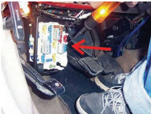
شکل ۱۲۰-۱- آزمایش جعبه‌ی فیوز با چراغ آزمایش
