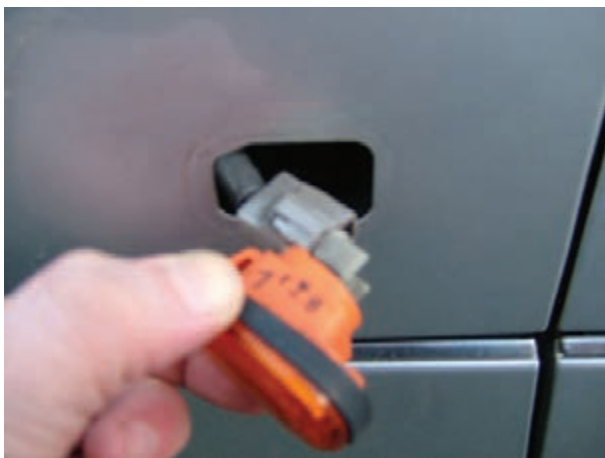
شکل ۶۷-۱- خارج کردن چراغ راهنمای بغل از محل خود در روی بدنه‌ی خودرو
