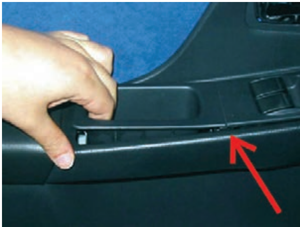
شکل ۱۸۳-۲ خارج نمودن قاب سوئیچ‌ها
