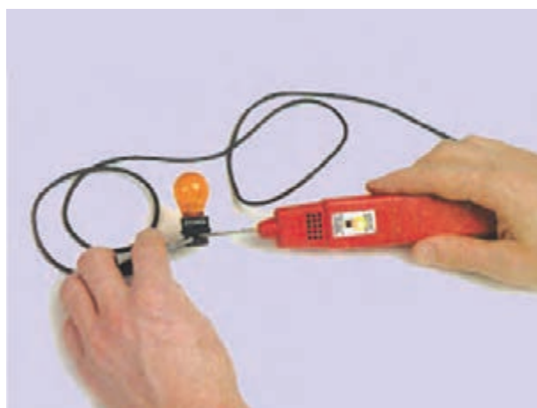
شکل ۱۸۲-۱- آزمایش لامپ چراغ راهنما
