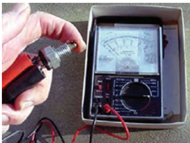
شکل ۱۰۵-۱- آزمایش سوئیچ چراغ‌های دنده عقب
