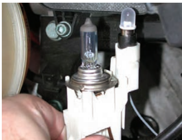
شکل ۱-۴۹ - پایه‌ی مشترک لامپ‌های چراغ روشنایی و پارک
