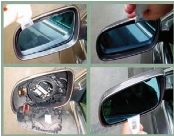
شکل ۱۶۷-۲- بیرون آوردن آینه از داخل قاب آن
