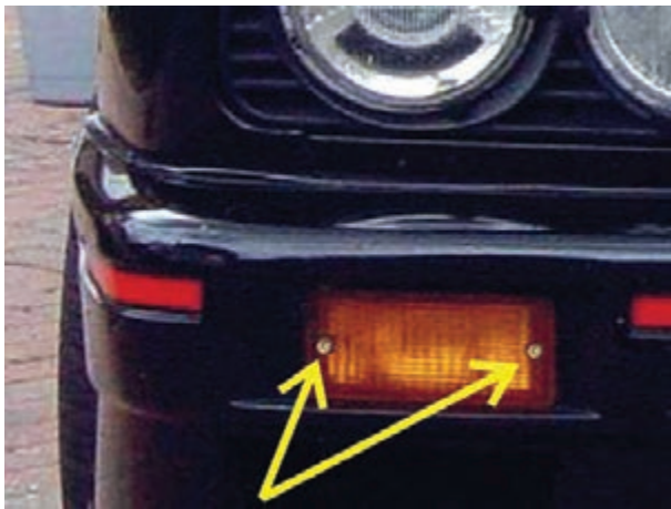
شکل ۱-۵۰ پیچ‌های اتصال تلق چراغ راهنما
