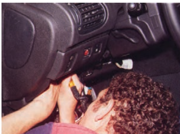
شکل ۲-۹۵- آزمایش برقراری جریان الکتریکی مدار
