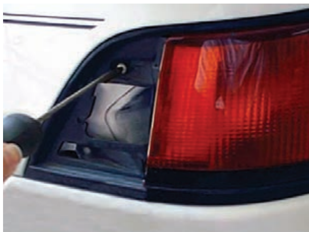
شکل ۱-۵۶- باز کردن پیچ‌های قاب چراغ
