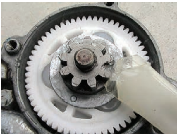
شکل ۱۳۰-۲- روغن کاری چرخ دنده ها
