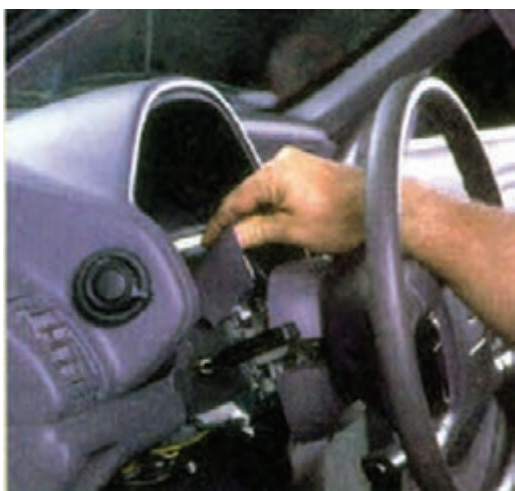
شکل ۹۱-۱- بیرون آوردن قاب سوئیچ روشنایی
