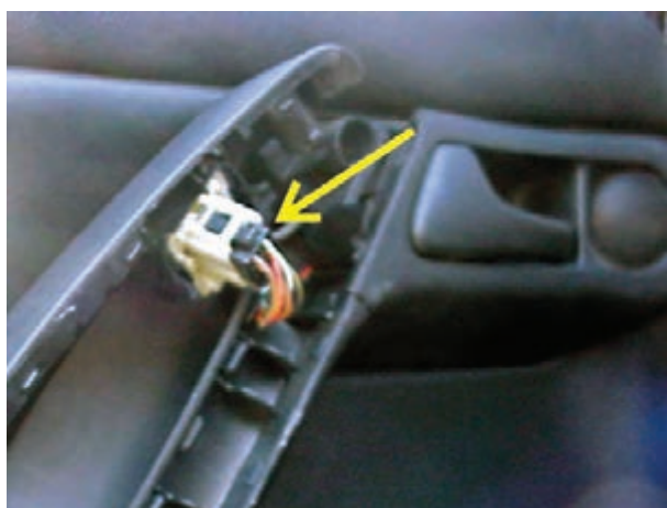
شکل ۲-۱۱۱- سوکت سوئیچ شیشه بالابر
