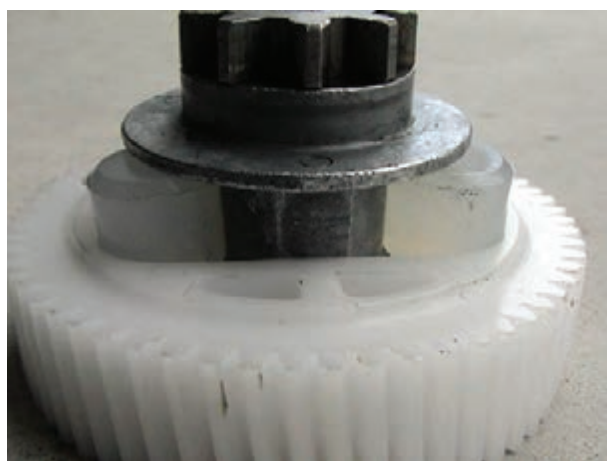
شکل ۱۲۸-۲ سوار کردن چرخ دنده‌ی فلزی
