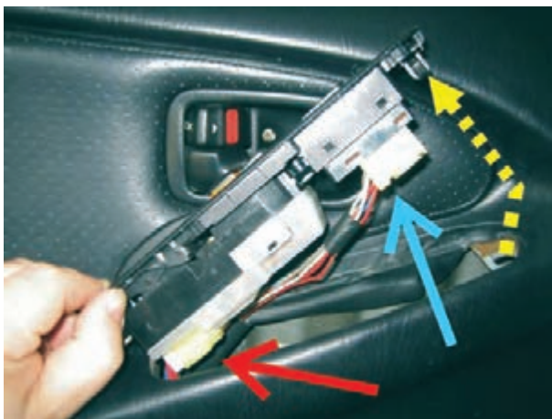
شکل ۱۸۶-۲- اتصال سیم‌کشی مدار الکتریکی به سوئیچ‌های روی پانل در سمت راننده در یک نوع خودرو
