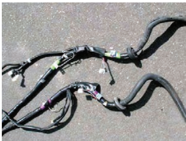
شکل ۱۳۷-۱- کلاف سیم کشی یک نوع خودرو
