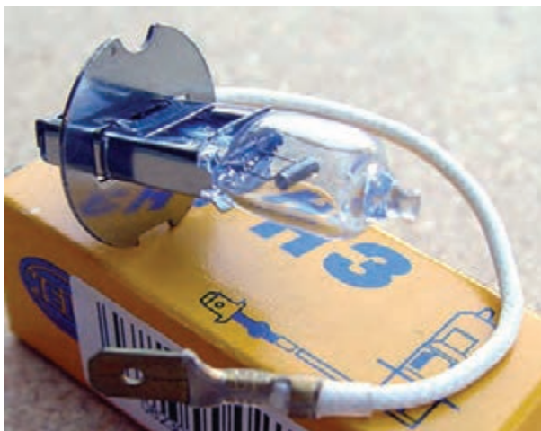
شکل ۱-۳۱- لامپ مورد استفاده در چراغ‌های مه‌شکن، نورافکن‌ها
