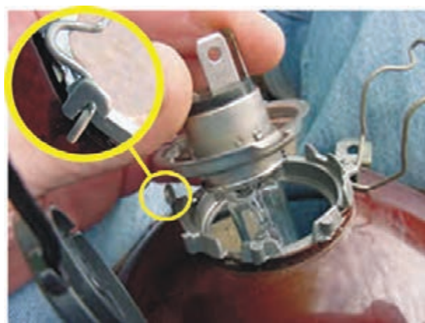
شکل ۱-۴۳- نحوه‌ی ثابت شدن لامپ درون کاسه‌ی چراغ
