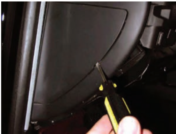
شکل ۱۱۸-۱- آزاد کردن خار پوشش محافظه‌ی جعبه‌ی فیوز
