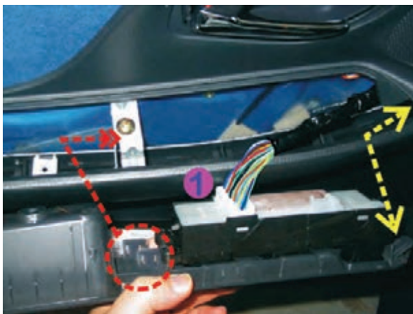
شکل ۱۸۴-۲ خارهای فلزی روی قاب سوئیچ‌ها و محل قرار گرفتن آنها
