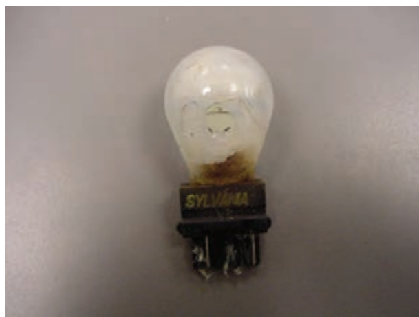
شکل ۱۴۱-۱- اثر عوامل فیزیکی در معیوب شدن لامپ
