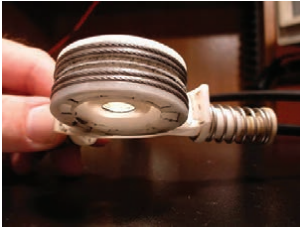
شکل ۱۰۷-۲- پولی اصلی مکانیزم شیشه بالابر یک نوع خودروی سواری
