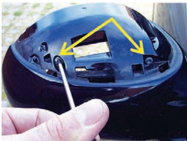
شکل ۱۷۴-۲- باز کردن پیچ‌های قاب بیرونی آئینه
