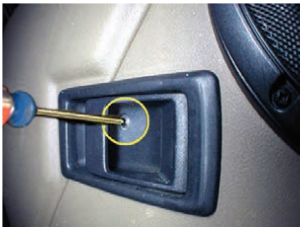
شکل ۳۶-۲- باز کردن قاب دستگیره‌ی قفل در
