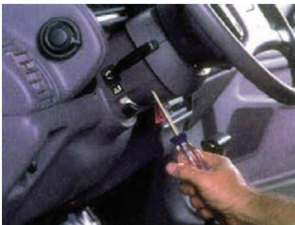
شکل ۱-۹۰- باز کردن پیچ‌های قاب سوئیچ روشنایی
