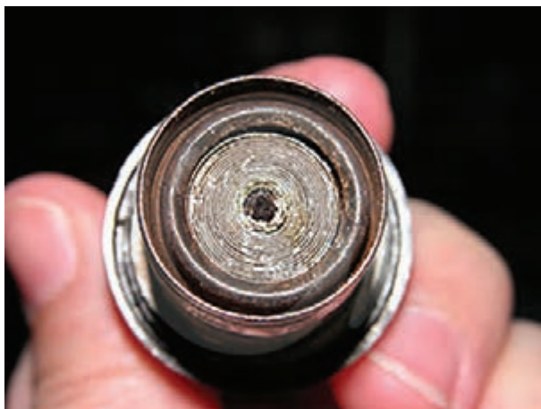
شکل ۱-۲۲۵- المنت حرارتی داخل سوئیچ فشاری
