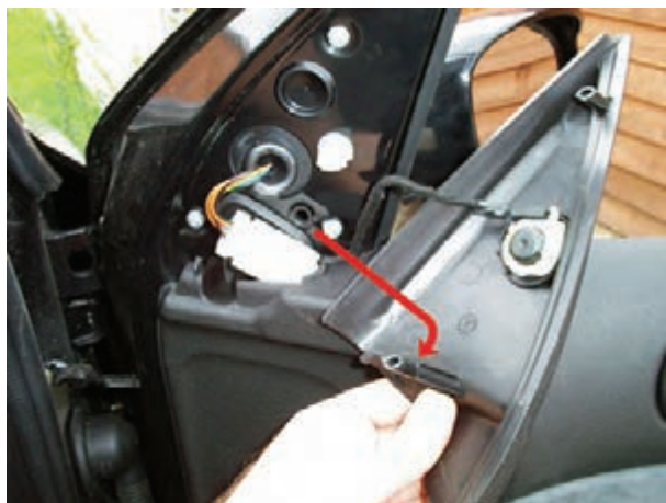
شکل ۱۶۵-۲ خارهای روی قاب و محل نصب آن
