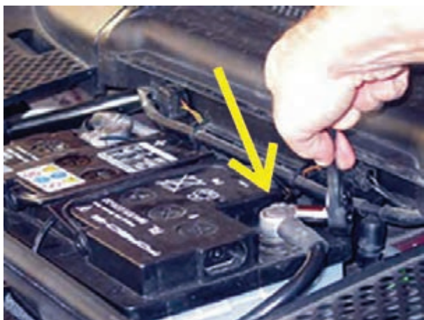
شکل ۱۴۱-۲- باز کردن کابل اتصال بدنه‌ی باتری
