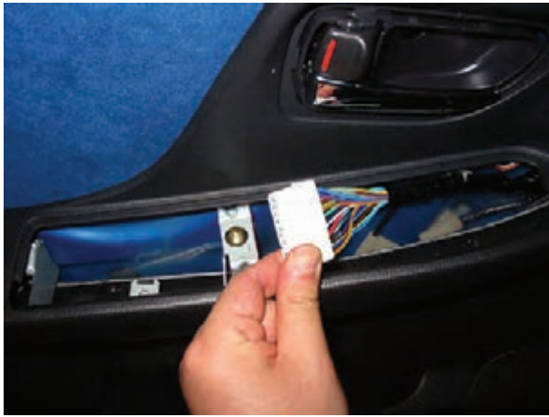
شکل ۱۸۵-۲- سوکت اتصال دسته سیم به سوئیچ‌ها
