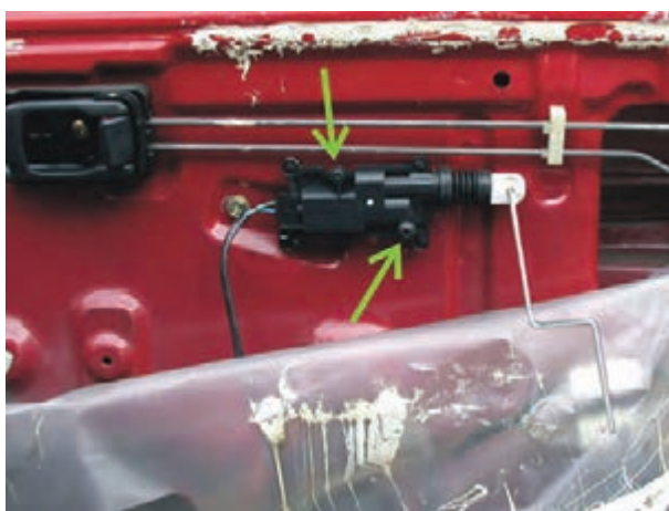
شکل ۲-۲۹ - اتصال عملگر الکتریکی در روی در خودرو
