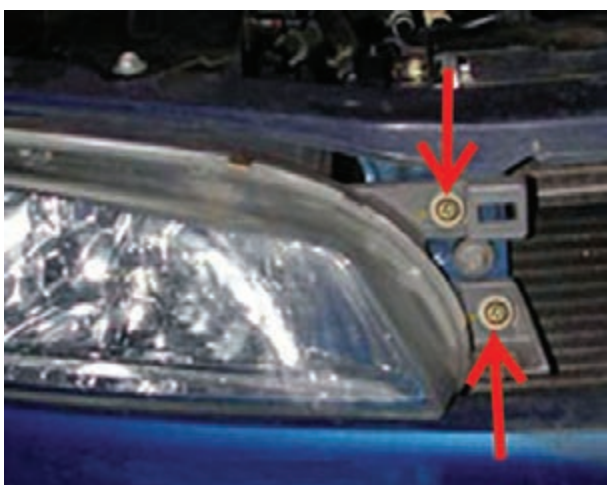
شکل ۱-۴۰- پیچ‌های نگه‌دارنده‌ی چراغ‌های بزرگ جلو
