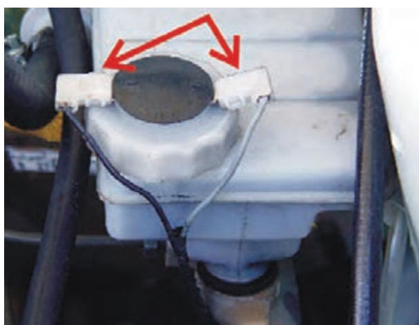
شکل ۲۰۳-۱- سوکت های اتصال پلاتین ها
