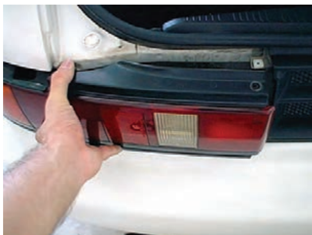
شکل ۱-۵۸- جدا کردن چراغ عقب از بدنه‌ی خودرو
