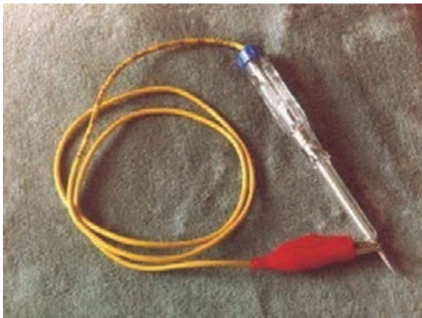
شکل ۱-۱۲۱- چراغ آزمایش بدون باتری
