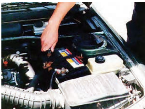
شکل ۱۶۴-۲ بازکردن کابل اتصال بدنه‌ی باتری
