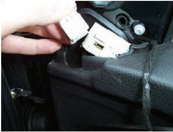
شکل ۱۶۶-۲- جدا کردن سوکت سیم کشی آینه
