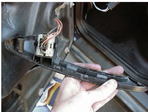
شکل ۱۱۸-۲- اتصال سوکت سوئیچ شیشه بالابر
