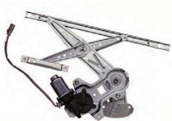
شکل ۲-۹۹- مکانیزم شیشه بالابر یک نوع خودرو
