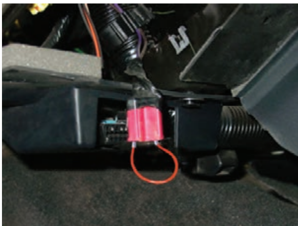
شکل ۱۲۹-۱- یک‌سره کردن مدار راهنما
