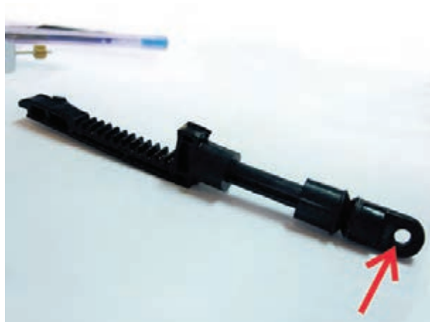
شکل ۱۸-۲- شانه‌ی دندانه‌دار دو قسمتی (محور عملگر)
