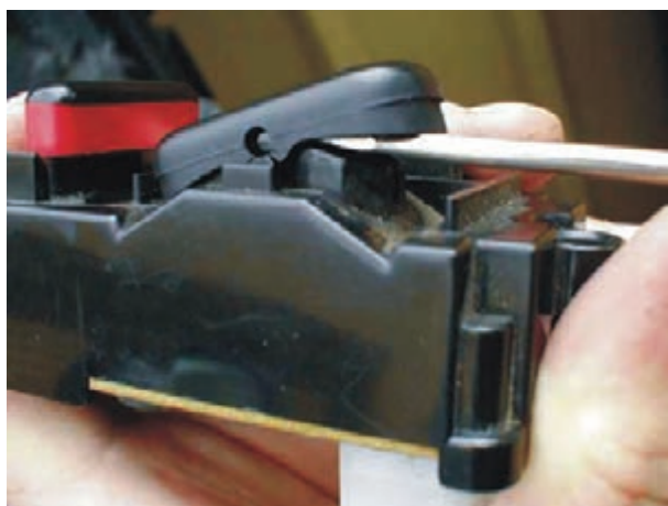
شکل ۲-۱۴۵- تعویض شستی معیوب
