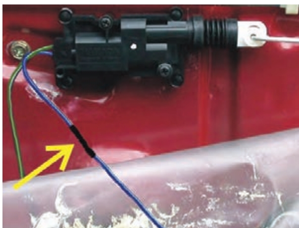
شکل ۲-۴۹- عایق کاری محل اتصال سیم‌ها به یکدیگر
