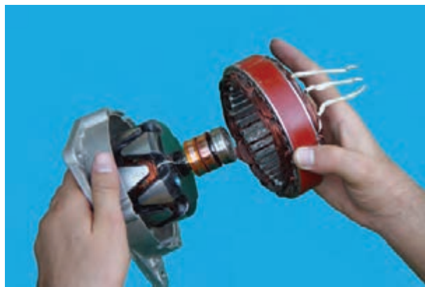
شکل ۶۲-۷ - جدا کردن استاتور
