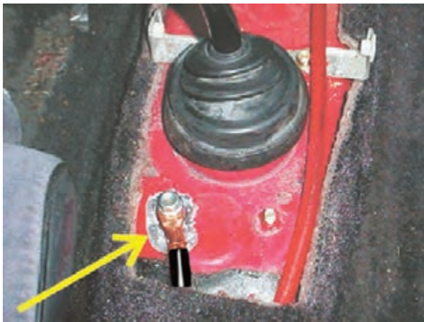
شکل ۲-۲۵- اتصال بدنه‌ی باتری در داخل اتاق خودرو
