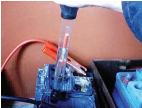
شکل ۱-۵۳- کنترل غلظت الکترولیت
