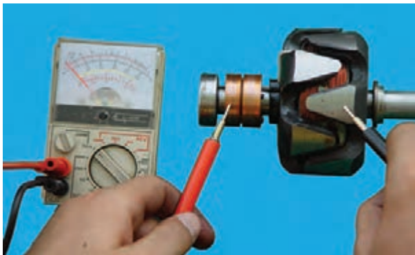
شکل ۷۴-۷- آزمایش اتصال بدنه نبودن سیم پیچ روتور
