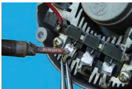
شکل ۵۶-۷- جدا کردن سیم‌های استاتور از یک‌سوکننده
