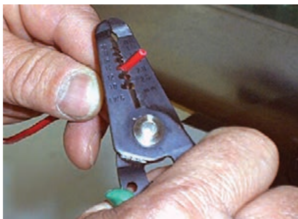
شکل ۴-۶۴- جدا کردن عایق سیم‌ها
