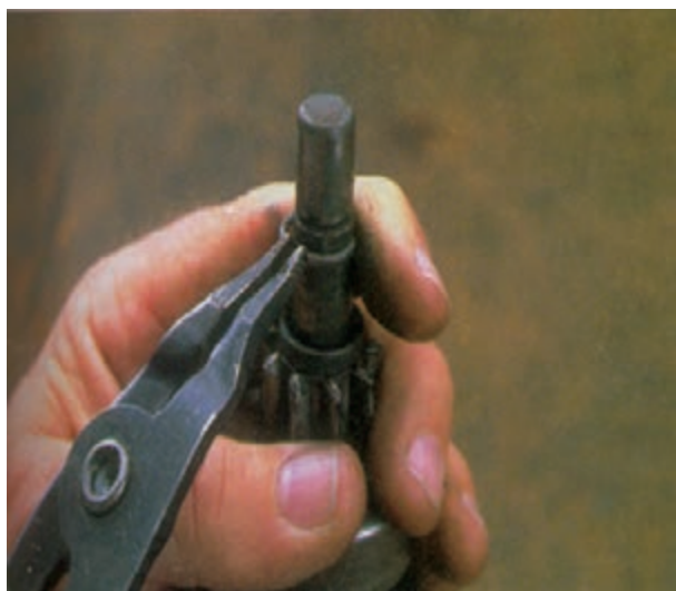
شکل ۸-۶۱ – درآوردن خار رینگی
