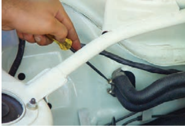
شکل ۴-۳۱- باز کردن لوله های آب رادیاتور بخاری
