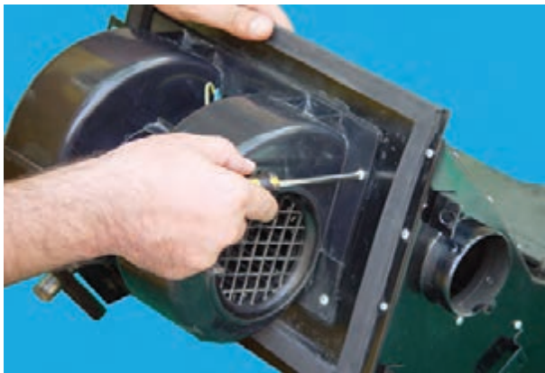
شکل ۴-۳۶– باز کردن پیچ‌های محافظه‌ی موتور
