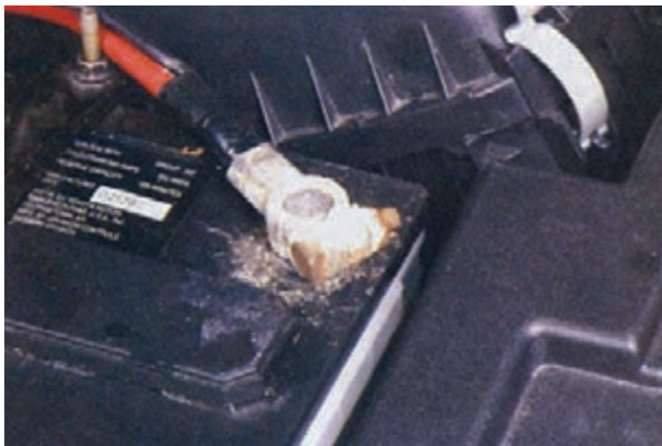
شکل ۳۱-۸ سولفات‌شدن اتصال قطب باتری
