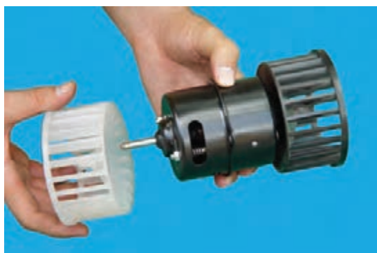
شکل ۴-۴۳- موقعیت فن‌ها (به موقعیت شکاف پوسته‌ی موتور و فن سفید رنگ توجه کنید).
