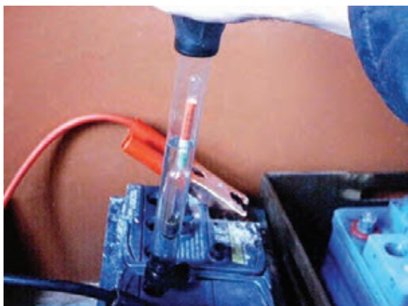
شکل ۱-۶۲- کنترل غلظت الکترولیت
