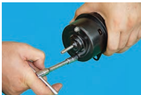
شکل ۴-۴۴- باز کردن پیچ‌های پوسته‌ی موتور
