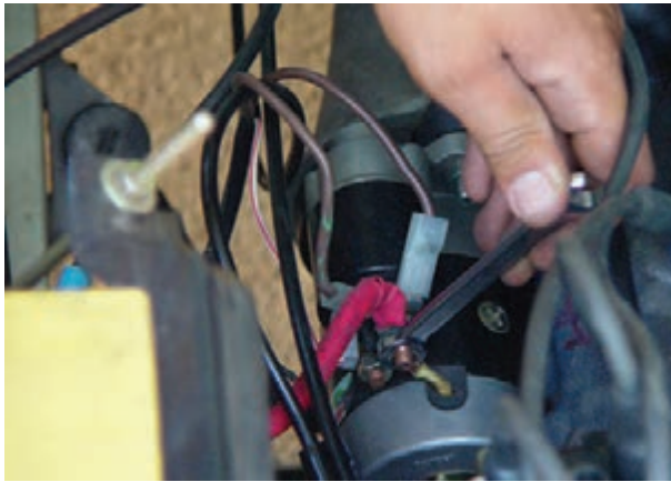
شکل ۸-۴۸- جدا کردن اتصالات الکتریکی استارت
