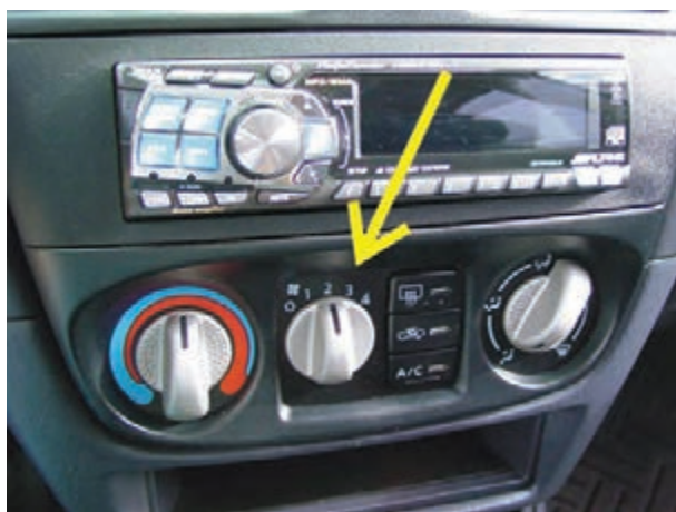
شکل ۴-۵۲- سوئیچ فن چهار وضعیت
