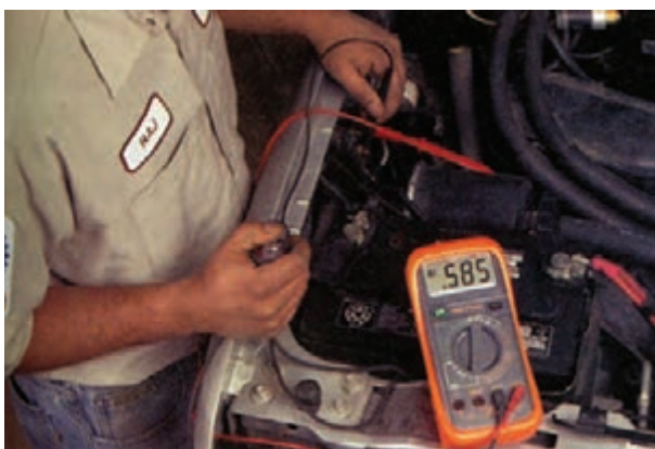
شکل ۸-۴۴- اندازه‌گیری افت ولتاژ پلاتین‌های سولونویید استارتر
