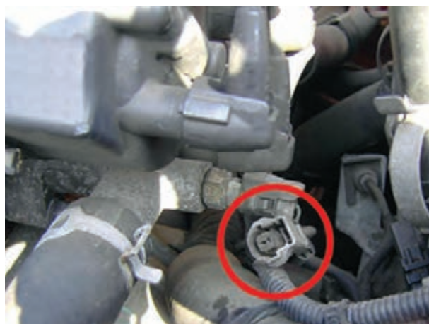
شکل ۱۶-۶- جدا کردن سوکت اتصال
