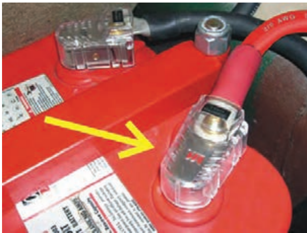
شکل ۱۹-۲- مورد استفاده تلق محافظ قطب‌های باتری
