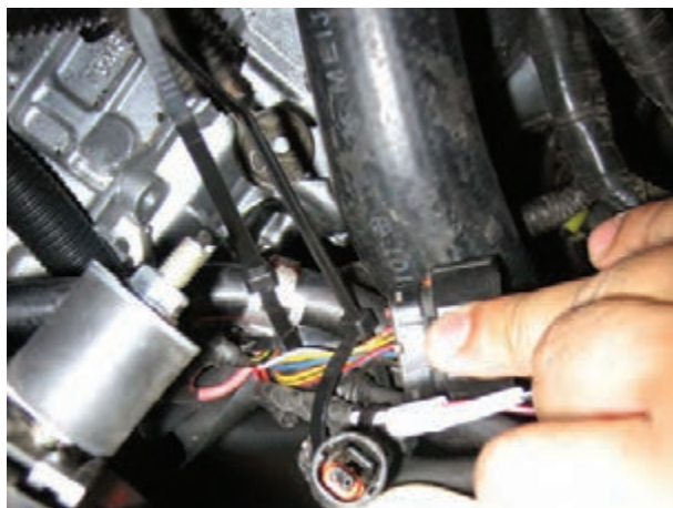
شکل ۴۵-۵ بررسی اتصالات الکتریکی سیم‌کشی
