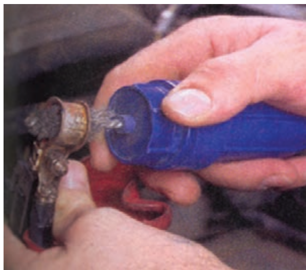
شکل ۹۱-۱ - پاک کردن بست‌های باتری با برس سیمی
