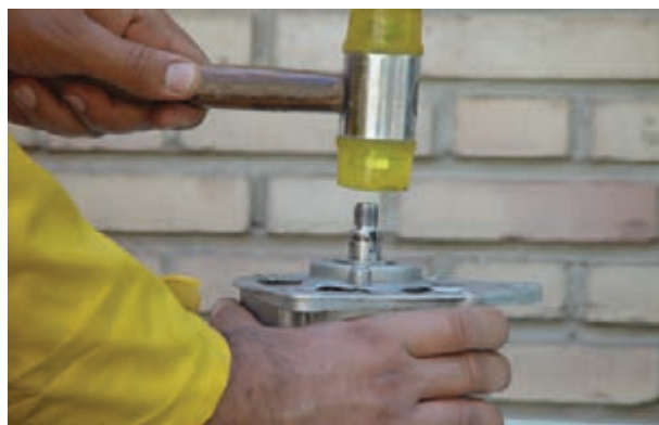
شکل ۶۳-۷ - بیرون آوردن روتور از درپوش
