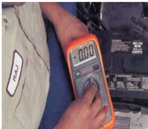
شکل ۸-۳۵- تنظیم مولتی متر روی شاخص ولتاژ
