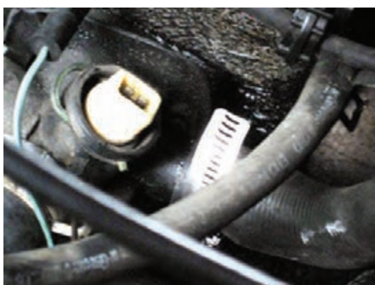
شکل ۲۵-۶- ترمینال‌های سنسور حرارتی مدار خنک‌کاری
