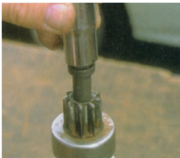
شکل ۸-۶۰ – خارج کردن حلقه رینگی از شیار شافت
