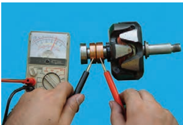
شکل ۷۵-۷- آزمایش سالم بودن سیم پیچ روتور
