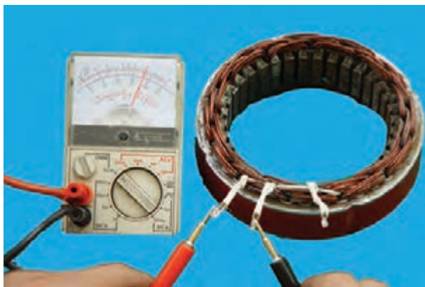
شکل ۷۹-۷- آزمایش سالم بودن سیم پیچ استاتور
