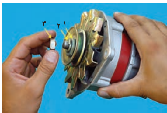
۱- واشر شش گوش ۲- واشر فنری ۳- مهره شکل ۵۷- ۷- باز کردن مهره ی پولی
