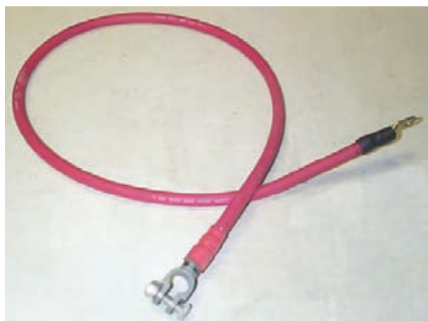
شکل ۳۲-۲- کابل اتصال مثبت باتری
