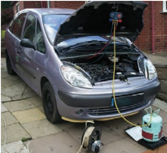
شکل ۳۵-۵ شارژ گاز کولر
