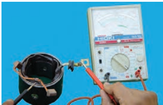
شکل ۸-۷۵- آزمایش اتصال بدنه‌ی بالشتک
