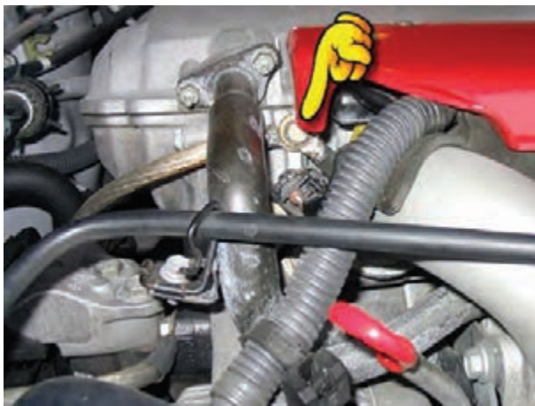
شکل ۲-۲۶- محل اتصال کابل منفی باتری به بدنه‌ی موتور
