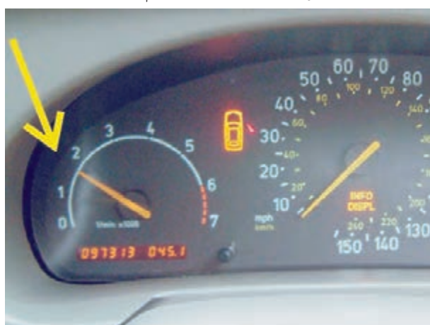
شکل ۷-۱۰۱- افزایش دور موتور برای آزمایش
