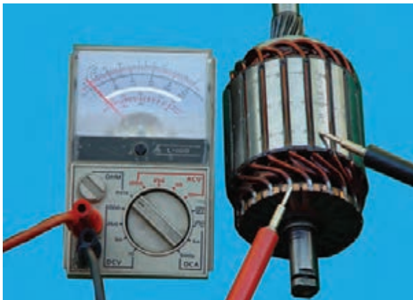
شکل ۸-۶۷- آزمایش اتصال کوتاه شدن آرمیچر
