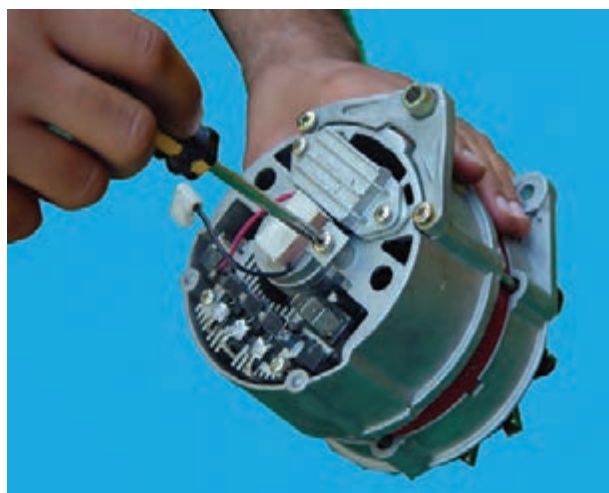
شکل ۷-۵۳- بازکردن پارازیت گیر
