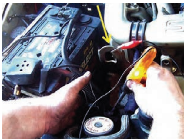
شکل ۴۳-۵- نحوه ی آزمایش سالم بودن سیم کشی
