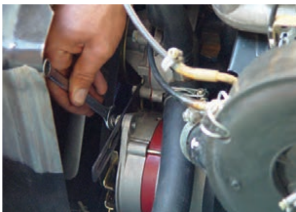
شکل ۷-۴۹ - باز کردن پیچ کشش تسمه پروانه
