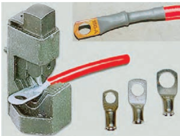
شکل ۸۰-۸- اتصال بست به کابل باتری
