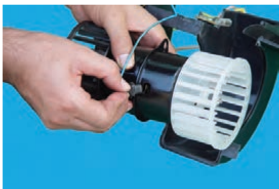
شکل ۴-۴۱- جدا کردن سیم از زغال‌ها
