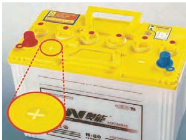
شکل ۲-۹- کاربرد علائم برای تشخیص قطب‌های باتری
