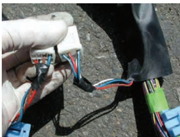
شکل ۳-۲۳- مقایسه و تطبیق سوکت‌های کلاف سیم‌کشی
