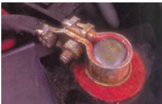
شکل ۱-۹۷- گریس زدن بست قطب‌ها
