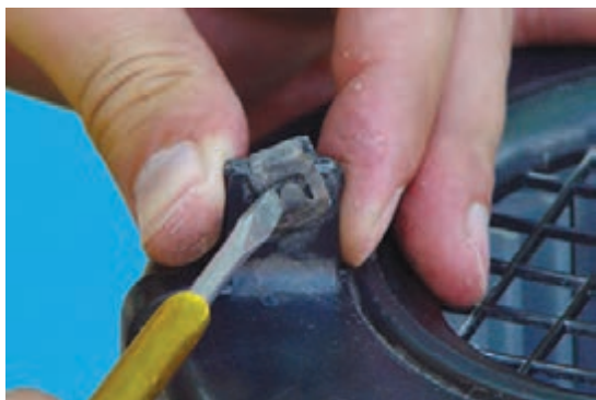
شکل ۴-۳۸- باز کردن ضامن خار
