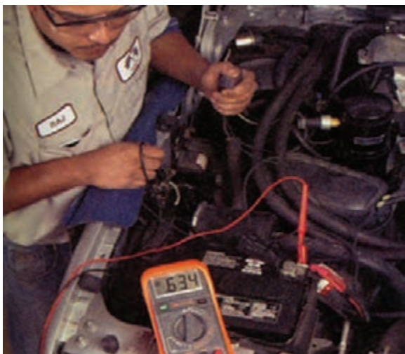
شکل ۸-۳۹- آزمایش افت ولتاژ باتری به خروجی رله
