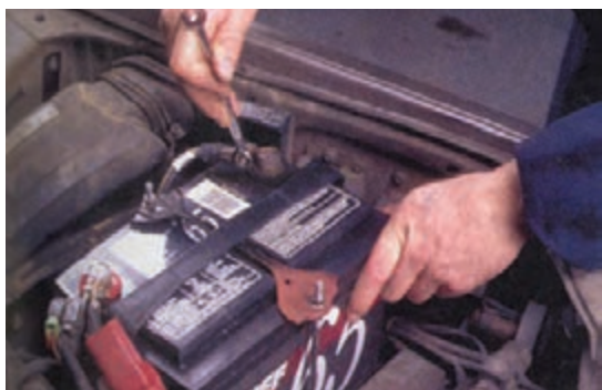
شکل ۱-۹۵- اتصال کابل‌های مثبت و منفی باتری
