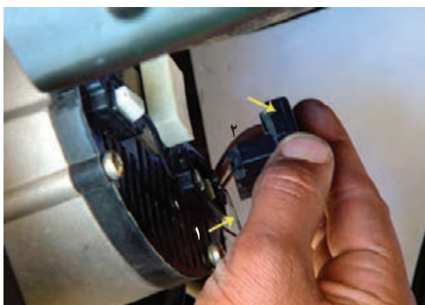
۱- خار ۲- مغزی اتصال سیم شکل ۷-۵۰ - جدا کردن خار و مغزی اتصال سیم از آلترناتور
