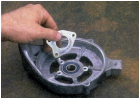
شکل ۶۸-۷ - در آوردن نگه‌دارنده‌ی بلبرینگ
