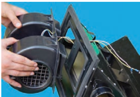
شکل ۴-۳۷- جدا کردن محفظه‌ی موتور از بخاری
