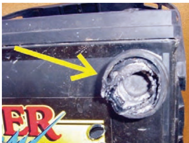
شکل ۳۶-۲- معیوب بودن ترمینال باتری
