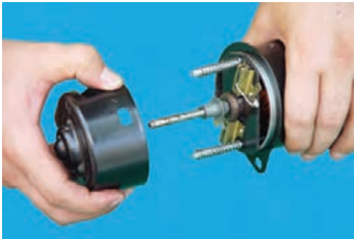
شکل ۴۵-۴ جدا کردن پوسته‌ی موتور
