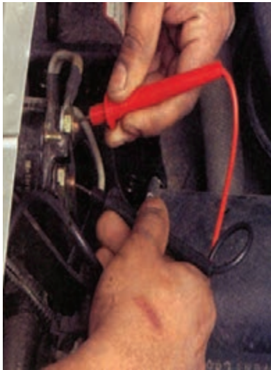
شکل ۸-۴۲- اتصال فیض‌های ولت‌متر به اتومات استارتر
