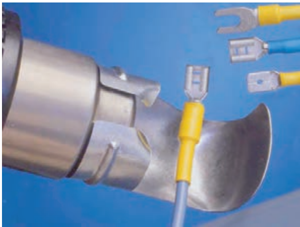
شکل ۷۹-۸- عایق‌کاری اتصال سرسیم به سیم
