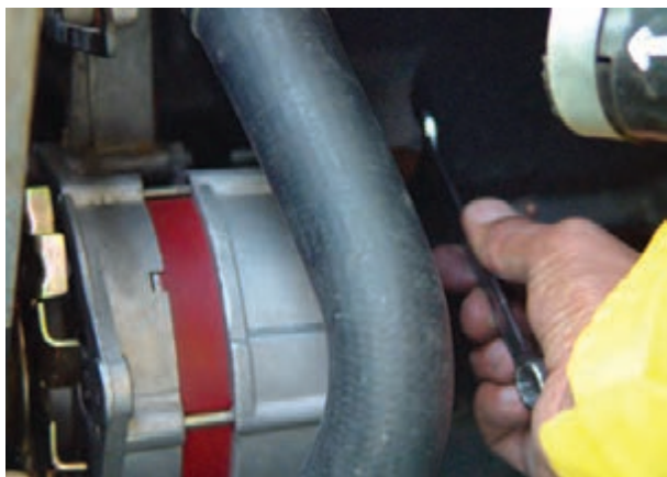
الف - بازکردن پیچ‌های پایه‌ی آلترناتور
