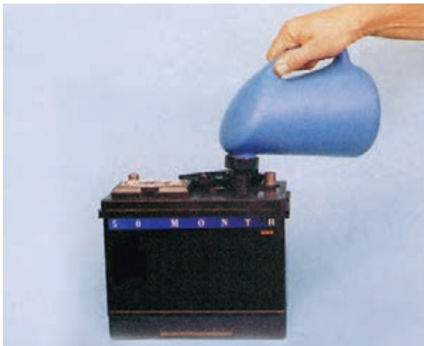
شکل ۱-۲۷ - پر کردن خانه‌های باتری نو با الکترولیت
