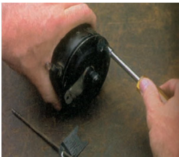
شکل ۸-۵۵ - باز کردن پیچ‌های اتصال درپوش به بدنه
