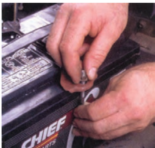
شکل ۹۴-۱- بستن باتری روی خودرو
