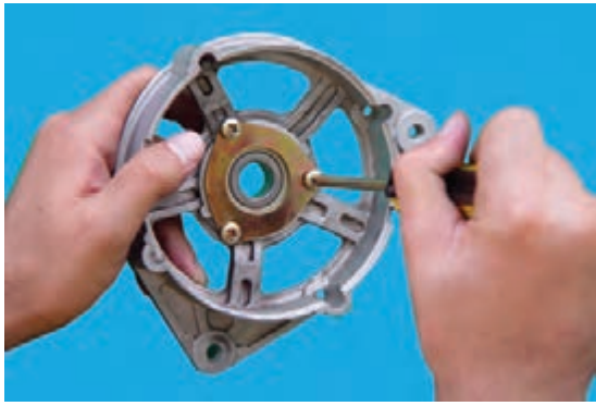
شکل ۶۷-۷ - باز کردن پیچ‌های نگه‌دارنده‌ی بلبرینگ
