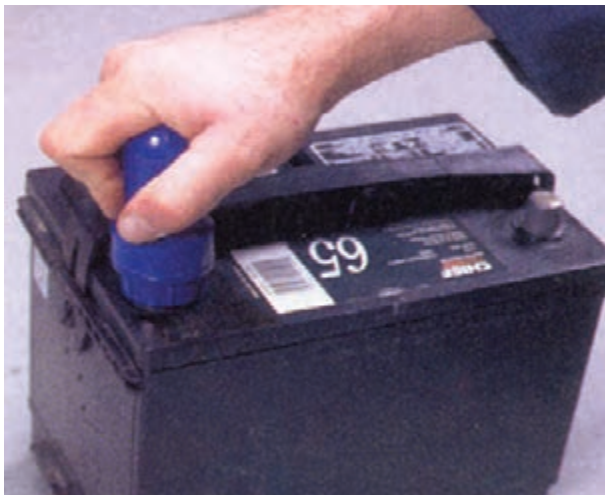
شکل ۸۹-۱ - نحوه‌ی استفاده از ابزار مخصوص باتری
