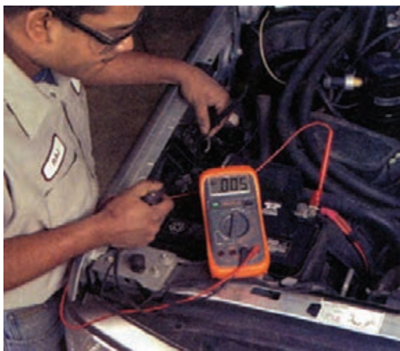
شکل ۸-۴۰- اتصال سیم منفی ولت‌متر به ورودی رله
