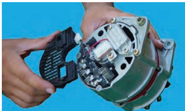
شکل ۷-۵۲- بازکردن درپوش دیودها
