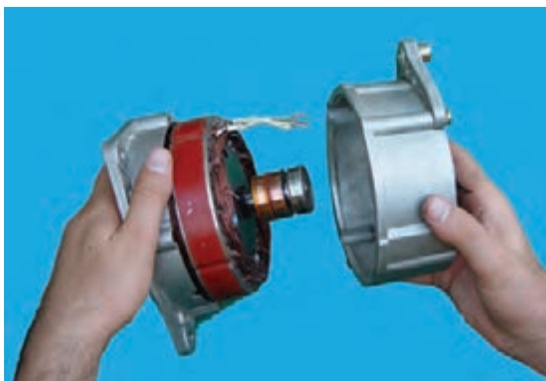
شکل ۶۱-۷ - جدا کردن درپوش‌های آلترناتور
