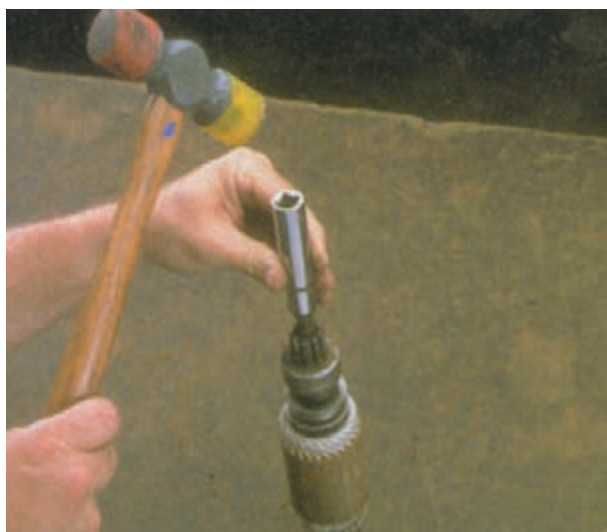
شکل ۸-۵۹ – ضربه زدن با چکش روی خار
