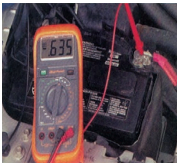
شکل ۸-۳۷ – اندازه‌گیری افت ولتاژ جریان ورودی کابل استارتر
