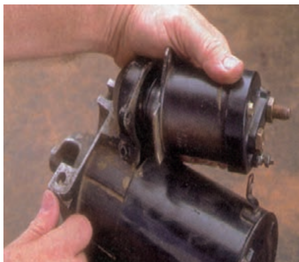
شکل ۸-۵۴ - خارج کردن اتومات
