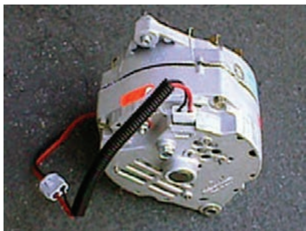
شکل ۳-۱۶- آلترناتور مجهز به آفتامات الکترونیکی
