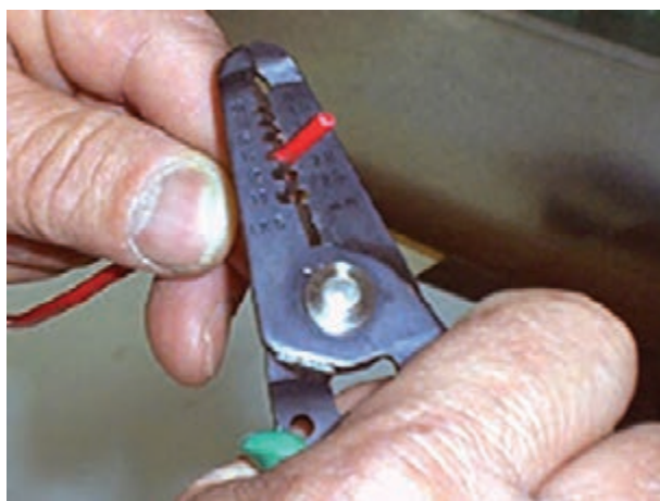
شکل ۳-۳۸- جدا کردن عایق سر سیم ها
