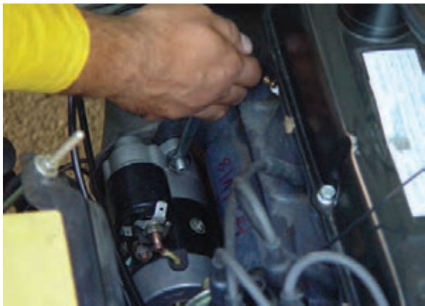
الف- باز کردن پیچ‌های استارتر
