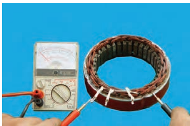
شکل ۷-۷۸ - آزمایش اتصال بدنه نبودن سیم پیچ استاتور
