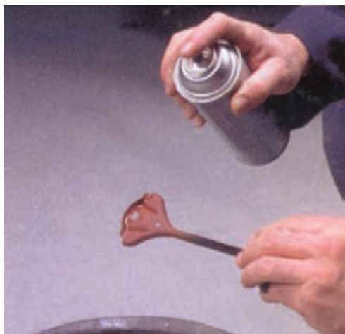
شکل ۹۳-۱- اسپری ضد خوردگی روی بست نگه‌دارنده‌ی باتری
