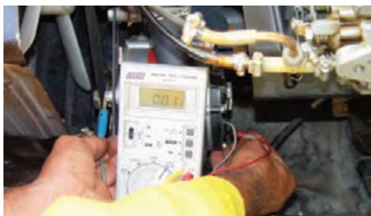
شکل ۷۲-۷ - اتصال ولت‌متر بین ترمینال B و بدنه
