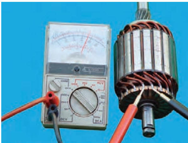
شکل ۸-۶۶- آزمایش سیم پیچ‌های آرمیچر – سالم بودن سیم‌ها و اتصال به لامل‌ها
