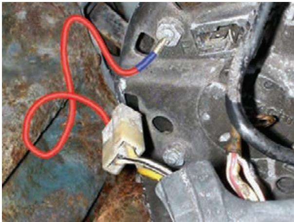
شکل ۳-۳۶- آزمایش مدار لامپ شارژ
