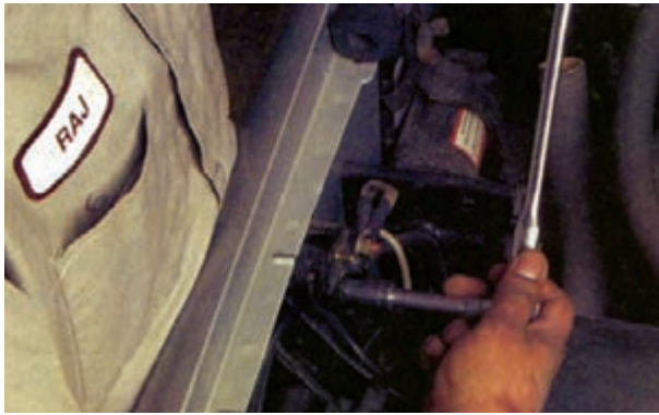
شکل ۸-۴۵ - اندازه‌گیری افت ولتاژ رله‌ی استارتر
