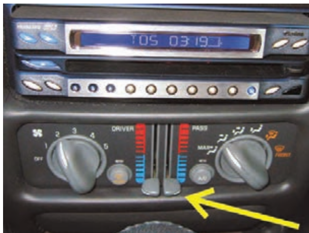
شکل ۴-۵۴- اهرم‌های تنظیم هوای ورودی
