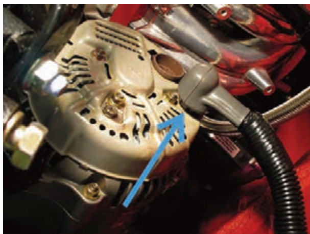
شکل ۳-۲۴- عایق اتصال الکتریکی ترمینال آلترناتور
