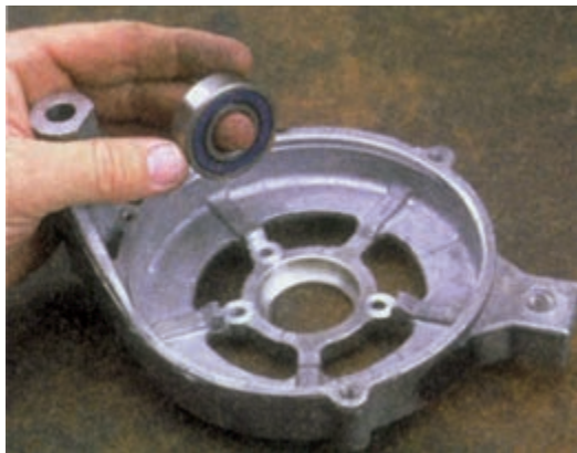
شکل ۷۰-۷ - خارج کردن بلبرینگ و آزمایش آن
