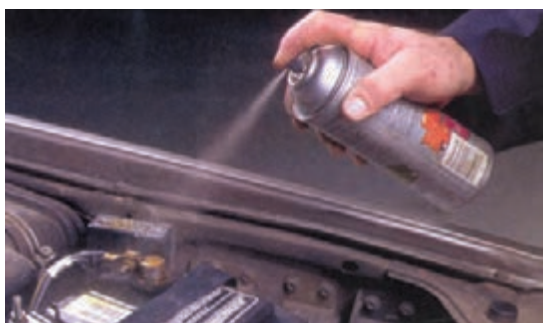
شکل ۱-۹۶- پاشیدن محلول ضد خوردگی روی بست
