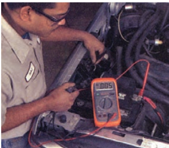
شکل ۸-۴۱- اندازه‌گیری افت ولتاژ کابل متصل به رله
