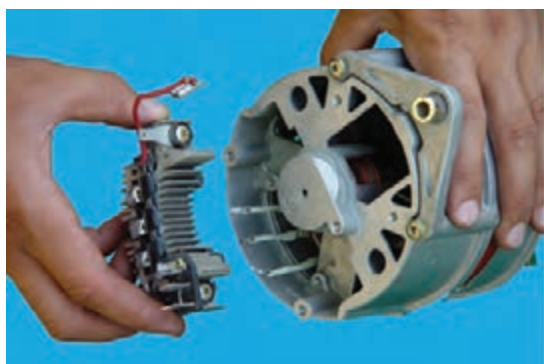
شکل ۵۵-۷- باز کردن یک‌سوکننده‌ها
