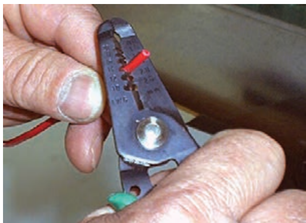
شکل ۳۰-۶ جدا کردن عایق سیم
