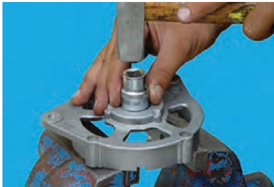
شکل ۶۹-۷ - بیرون آوردن بلبرینگ
