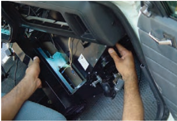
شکل ۴-۳۴– خارج کردن بخاری از محل نصب آب
