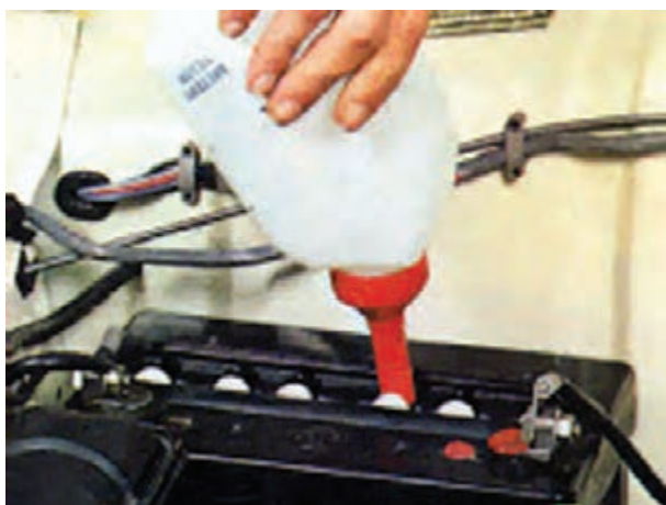
شکل ۱-۷۴- کنترل سطح الکترولیت
