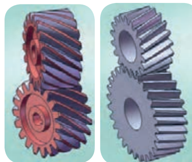
انتقال دور در دو محور متنافر با چرخ‌دنده‌های مارپیچ
