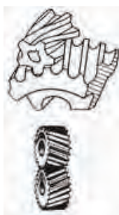
درگیری دو چرخ‌دنده مارپیچی
