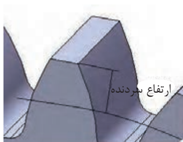
معرفی ارتفاع سر دنده در چرخ دنده ساده
