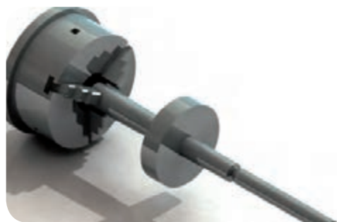
سوار کردن درن بر روی دستگاه تقسیم
