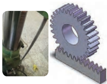
کاربرد چرخ و شانه در ماشین‌های مته
