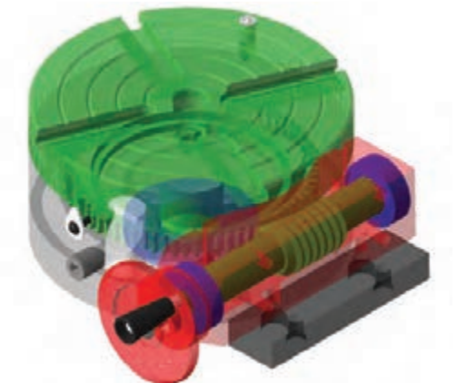
نمایش سیستم داخلی میزگردان
