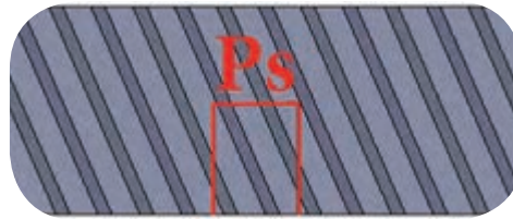
معرفی گام ظاهری در چرخ‌دنده شانه‌ای مایل
