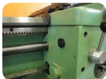
کاربرد چرخ و شانه در ماشین‌های تراش
