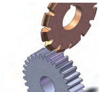
نمایش تیغه فرز مدولی و قطعه کار
