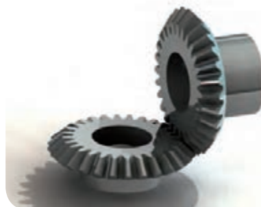
درگیری دو چرخ دنده مخروطی با یکدیگر
