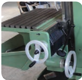
مکانیزم جابجایی میز ماشین
