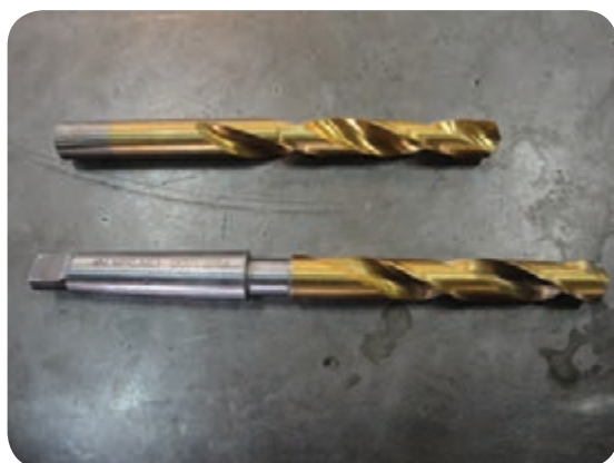
دنباله استوانه‌ای و مخروطی در مته‌ها
