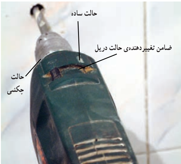
شکل ۲۱۲-۳ سوراخ کردن محل علامت‌گذاری شده
