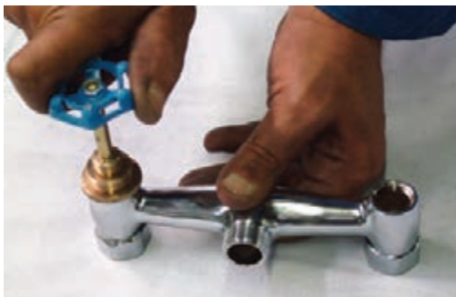
شکل ۲-۶۸- شیر تراش در حال کار شیر تراش
