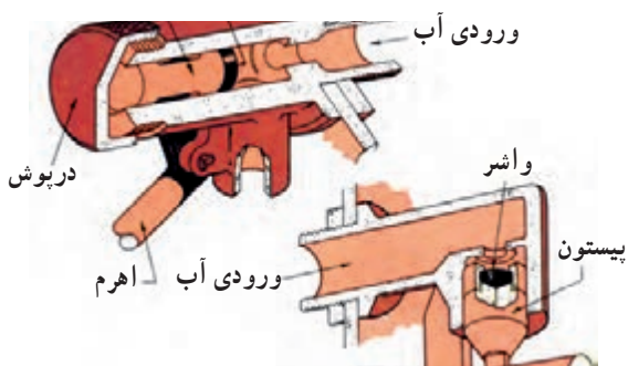
شکل ۱۱۳-۲ اجزای شیر شناور
