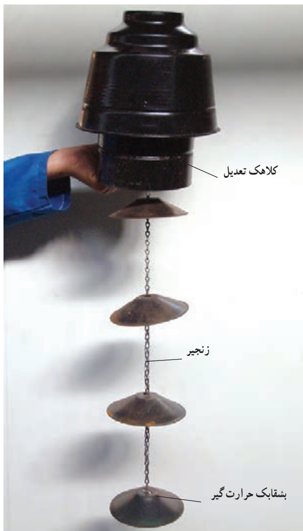
شکل ۹۴-۱- حرارت گیر آب گرمکن مخزنی گازسوز
