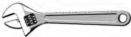
شکل ۱۲۰-۲- نمای ظاهری یک آچار فرانسه
