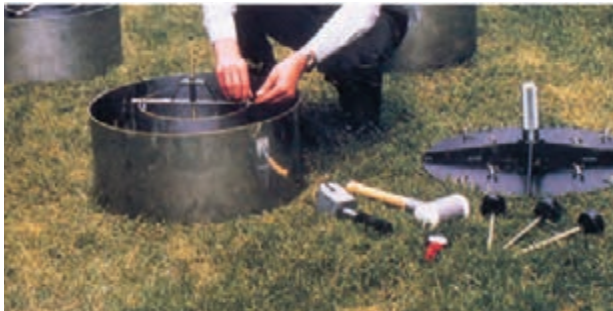
شکل ۳-۱ نحوه کار گذاشتن استوانه مضاعف
