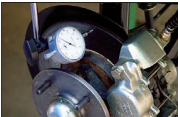
شکل ۱-۱۲۳- بررسی وضعیت دیسک
