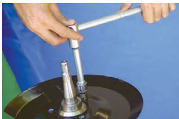
شکل ۳-۹۶- باز کردن صفحه پشت توپی چرخ
