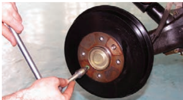
شکل ۱-۸۹ – باز کردن پیچ کاسه چرخ
