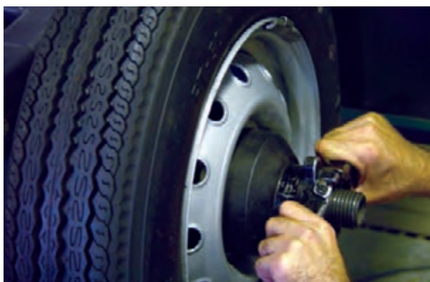
شکل ۲۳۴-۳- نصب چرخ روی دستگاه
