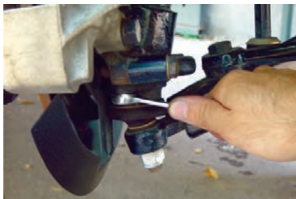
شکل ۳-۷۸- باز کردن سبک زیر کمک فنر
