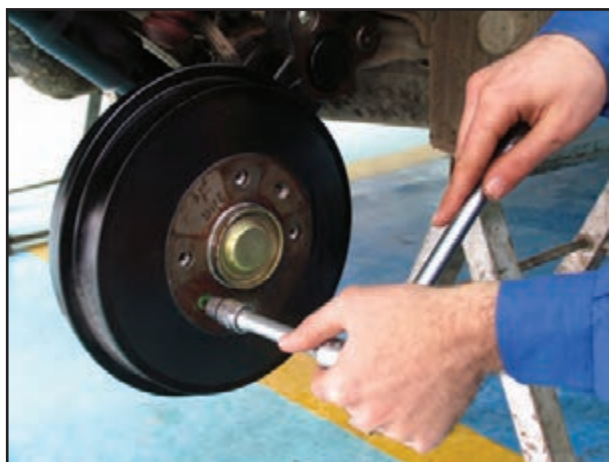
شکل ۱-۱۰۲- بستن پیچ نگه‌دارنده کاسه چرخ
