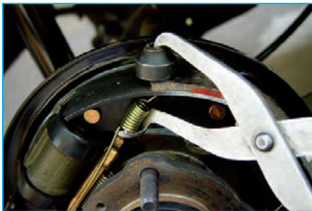
شکل ۹۱-۱- خارج کردن فنر بالایی
