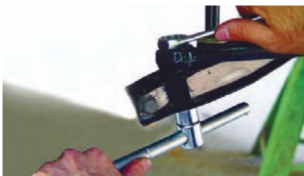
شکل ۳-۸۱ باز کردن میل تعادل از طبق
