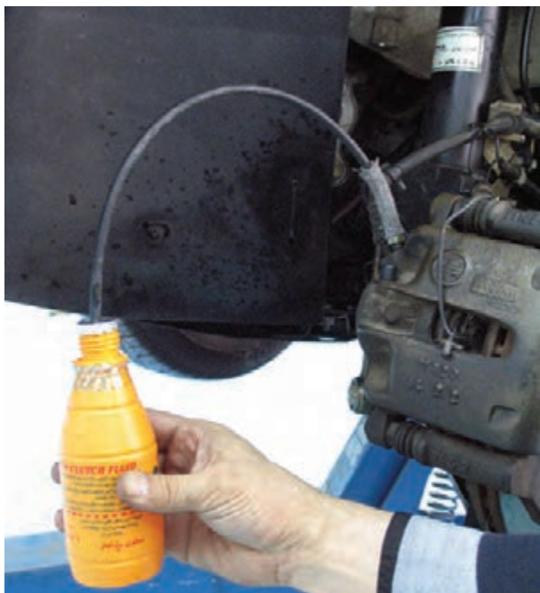
شکل ۱-۷۱- نصب لوله پلاستیکی روی پیچ هواگیری
