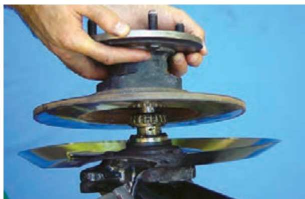
شکل ۳-۹۴- خارج کردن دیسک ترمز و توپی از روی محور چرخ
