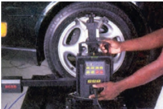
شکل ۳-۲۲۰ - نصب مجموعه حسگر دستگاه اندازه‌گیر رایانه‌ای
