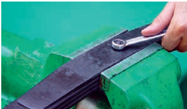
شکل ۳-۶۸- باز کردن پیچ مرکز فنرهای شمش
