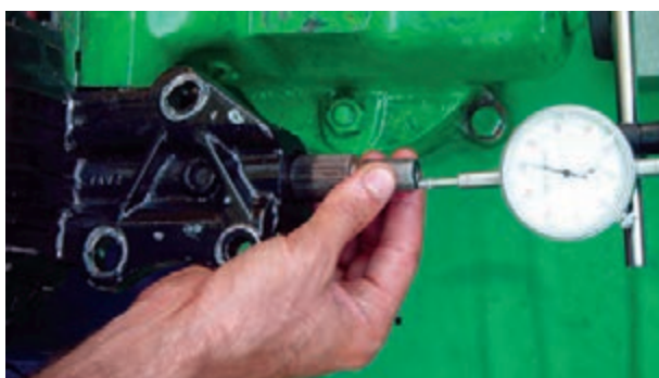
شکل ۷۰-۲- اندازه‌گیری لقی طول محور هزار خار
