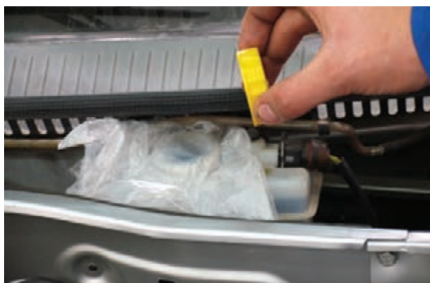
شکل ۱۳۸-۱- مسدود کردن در مخزن مایع ترمز
