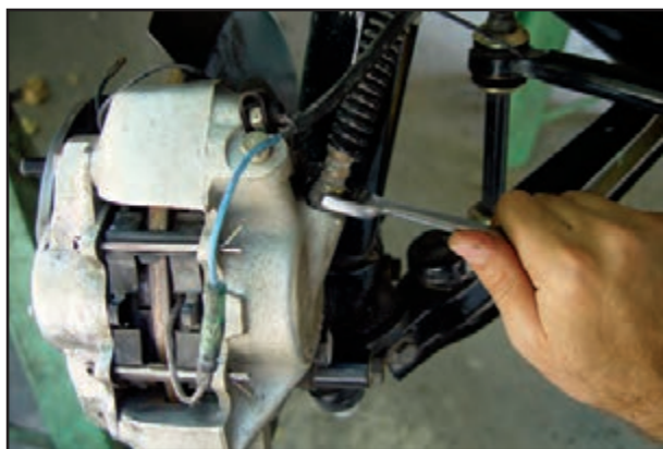
شکل ۱-۱۱۹- باز کردن شیلنگ ترمز
