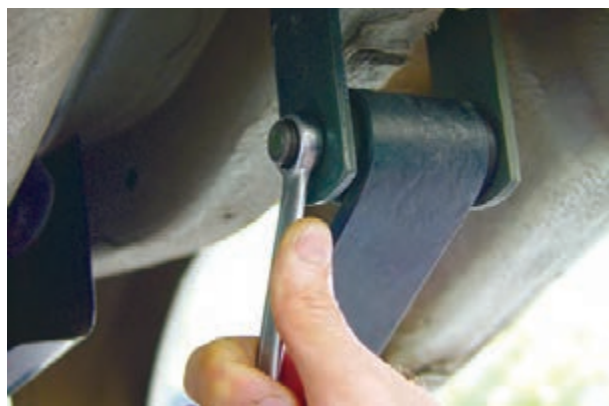
شکل ۳-۶۵ – باز کردن مهره‌های گوشواره فنر شمش
