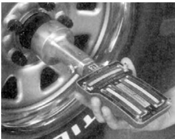
شکل ۲۱۷-۳- دستگاه اندازه‌گیری زوایای مکانیکی (ترازی)
