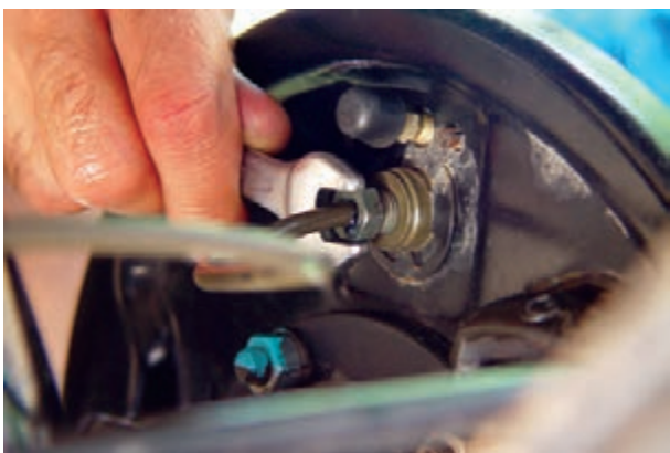
شکل ۱۰۵-۱- باز کردن مهره اتصال لوله ترمز
