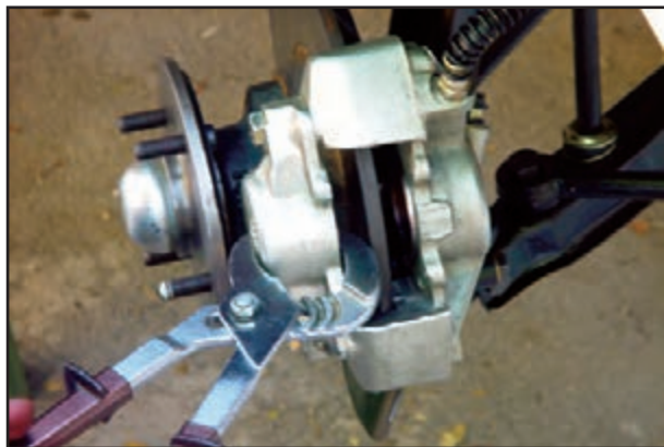
شکل ۱۱۴-۱- عقب راندن پیستون ترمز دیسکی
