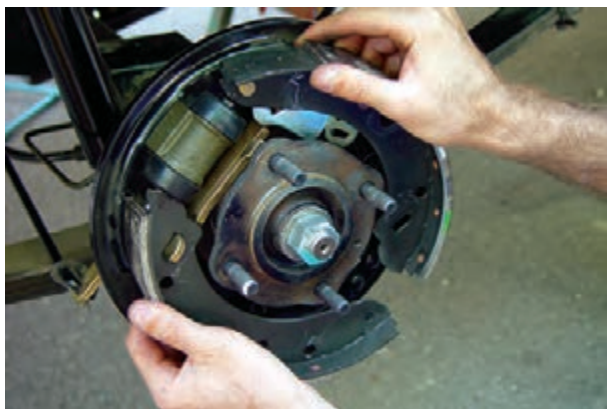
شکل ۹۳-۱- خارج کردن کفشک‌ها
