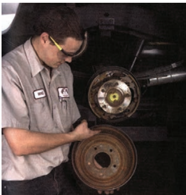
شکل ۹۶-۱- کنترل کاسه چرخ
