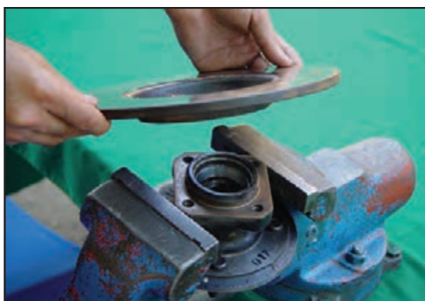
شکل ۱-۱۲۶- بازکردن دیسک ترمز
