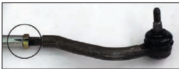
شکل ۲-۷۴ - علامت گذاری سیبک و میل رابط
