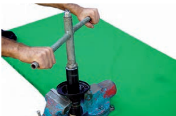
شکل ۳-۹۱- باز کردن مهره نگه‌دارنده کمک فنر
