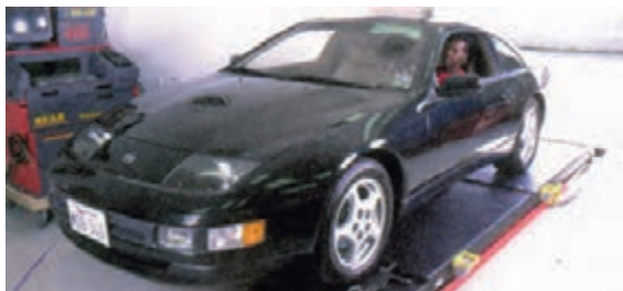
شکل ۳-۲۱۹ - دستگاه اندازه‌گیری زوایای رایانه‌ای (کامپیوتری)
