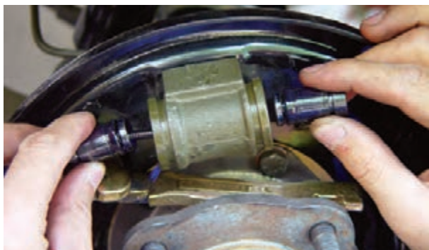
شکل ۹۴-۱- خارج کردن پیستون‌ها
