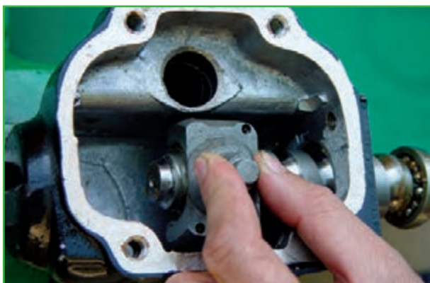
شکل ۲-۶۳- خارج کردن محفظه ساچمه‌ها
