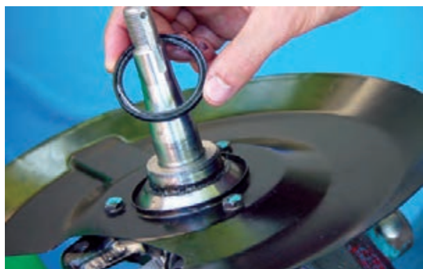
شکل ۳-۹۵- خارج کردن کاسه نمد پشت توپی چرخ
