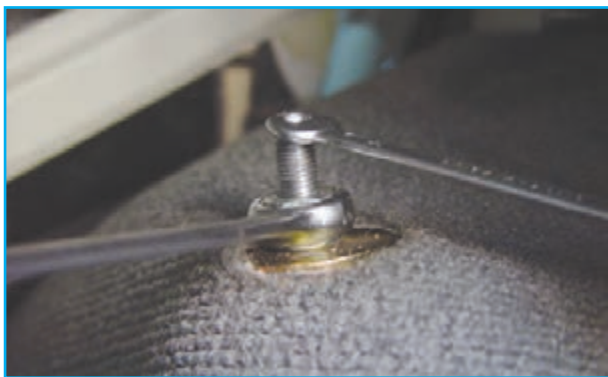
شکل ۳-۶۳- باز کردن مهره اتصال بالای کمک فنر
