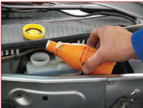
شکل ۱-۶۸- برکردن مخزن مایع ترمز تا حداکثر (MAX)
