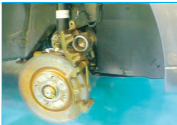
شکل ۱۱۰-۱- باز کردن پوسته نگاه‌دارنده لنت‌ها
