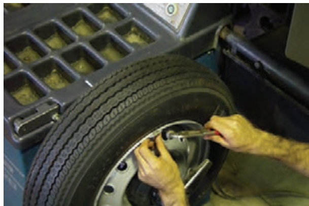
شکل ۲۳۸-۳- نصب وزنه روی قسمت بیرونی رینگ
