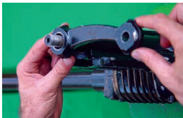
شکل ۲-۵۹- پیاده کردن اهرم هزار خار
