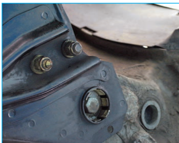
شکل ۳-۱۲۲- باز کردن پیچ های طبق
