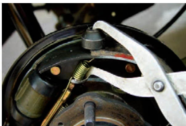
شکل ۱-۱۰۷- جازدن فنر بالایی کفشک
