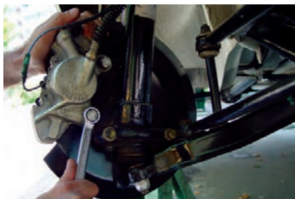
شکل ۳-۷۷- باز کردن کالیبر ترمز
