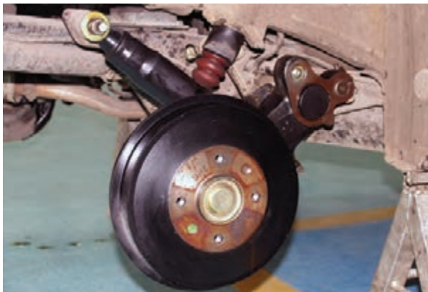
شکل ۱۷۷-۳- نصب کمک فنر
