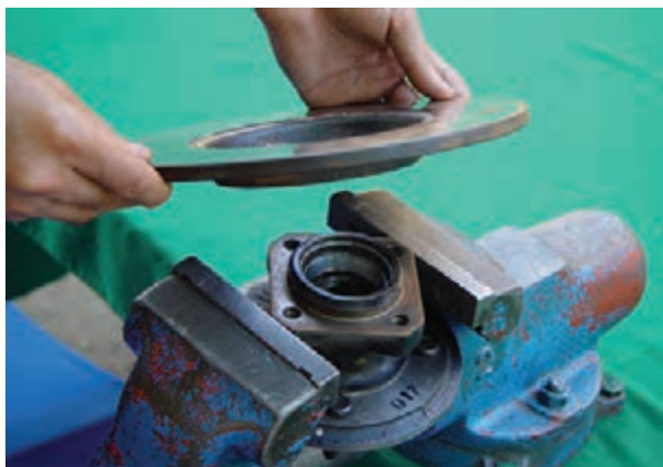
شکل ۳-۹۸- جدا کردن دیسک ترمز از تویی چرخ
