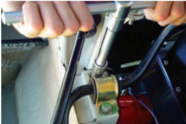
شکل ۳-۸۶- باز کردن میله ضد غلتش (موج گیر)
