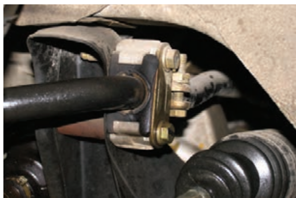
شکل ۱۳۲-۳- نصب بست‌های میل موج گیر بلند
