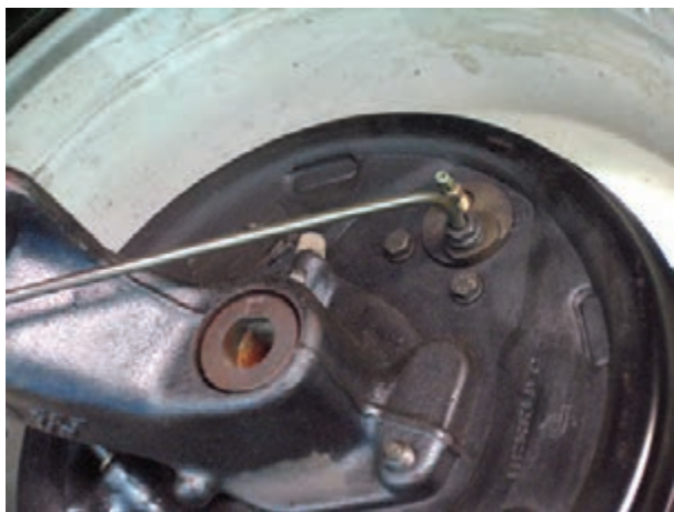
شکل ۱۰۳-۱- پاک کردن اطراف اتصالات
