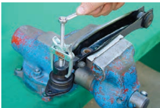
شکل ۳-۸۵- جدا کردن سیبک از بازوی اتصال
