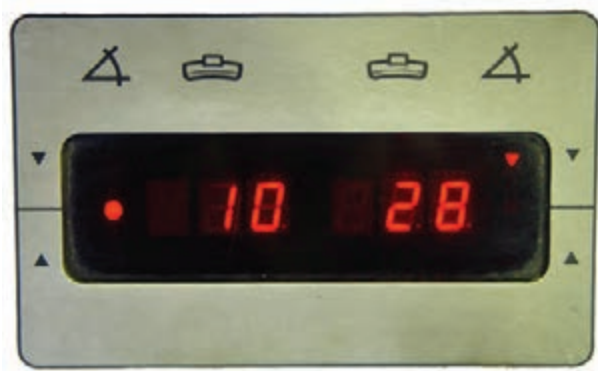
شکل ۲۳۷-۳- تعیین وزنه مورد نیاز در صفحه نشان‌دهنده
