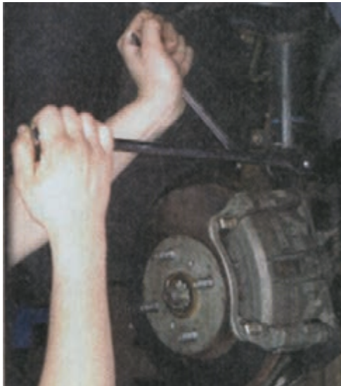
شکل ۳-۱۰۰ نصب مجموعه سیستم تعلیق روی خودرو
