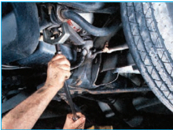
شکل ۲-۴۷- نحوه استفاده از نوعی سیبک کش
