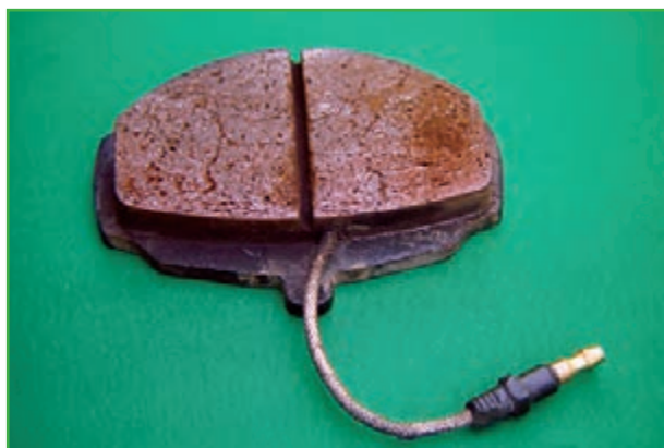
شکل ۱۱۲-۱- لنت ترمز دارای سیم هشدار
