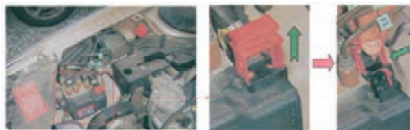
شکل ۱۶۶-۱- کنترل اتصالات الکتریکی سیم ترمز ضدقفل (ABS)
