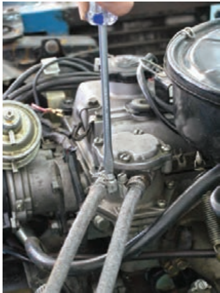
شکل ۱-۳۲ اتصال لوله سوخت به پمپ
