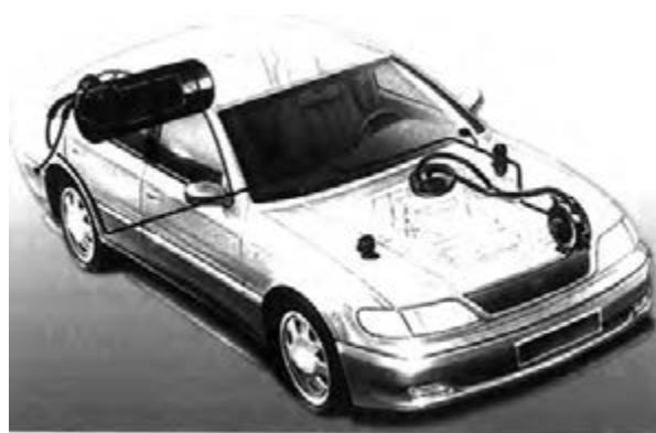
شکل ۱-۱۴ سیستم سوخت‌رسانی گاز خودرو
