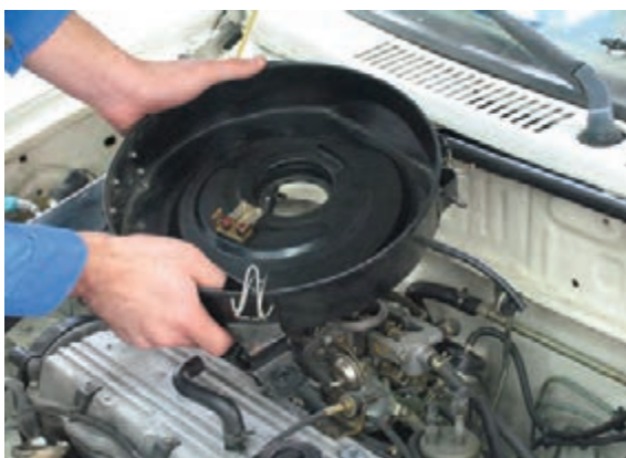
شکل ۱۰۰-۱ پیاده کردن مجموعه هواکش
