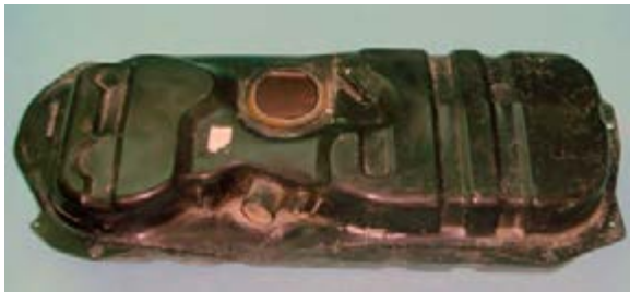
شکل ۱-۲۶ مخزن سوخت آماده نصب
