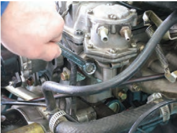
شکل ۴۲-۱ پیاده کردن پمپ
