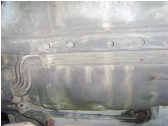
شکل ۱-۳۳ لوله سوخت از مخزن تا پمپ
