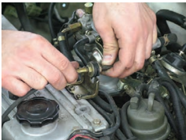
شکل ۱۱۵-۱ پیاده کردن کاربراتور
