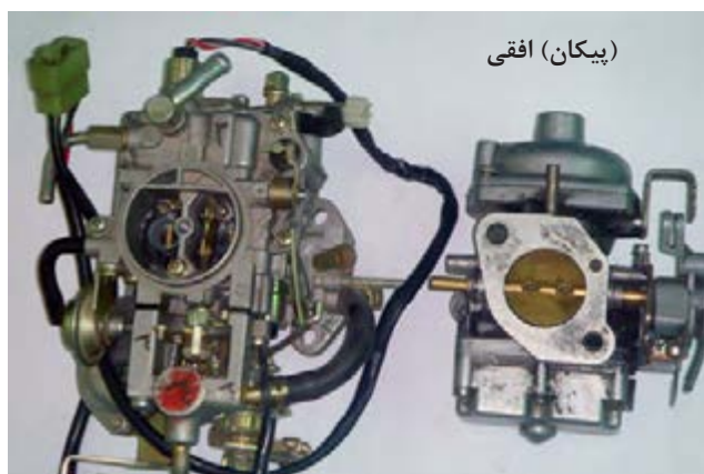
شکل ۱-۶۴ کاربراتورها از نظر حرکت سوخت (نزولی - افقی)
