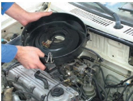
شکل ۱۱۴- ۱ پیاده کردن مجموعه هواکش
