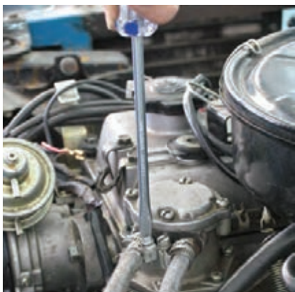
شکل ۱-۴۴-ب: نصب لوله‌ها
