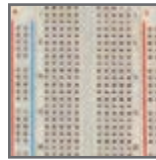
شکل ۲۲- برد بُرد و سوراخ‌های آن
