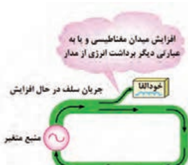
شکل ۲۶ - ذخیره انرژی در سیم پیچ
