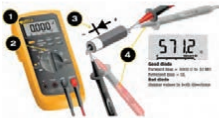
شکل ۳۲- تست دیود ناسالم و اتصال کوتاه
