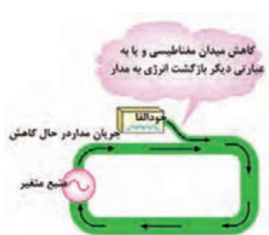
شکل ۲۷ - بازگشت انرژی به مدار
