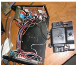
شکل ۱۳۰- جداسازی مولد هوای فشرده (کمپرسور)
