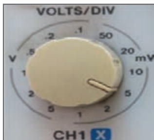
شکل ۵۹ - کلید Volt/DIV و موج روی صفحه‌نمایش
