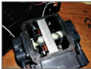
شکل ۱۳۳- مولد هوای فشرده (کمپرسور)
