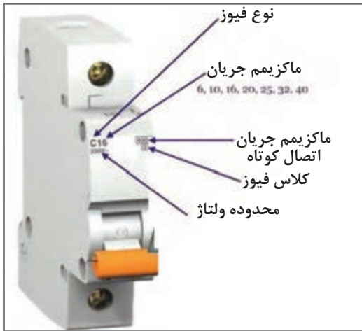
شکل ۱- مشخصات یک نوع فیوز مینیاتوری
