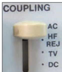
شکل ۷۴- وضعیت‌های کلید کوپلینگ
