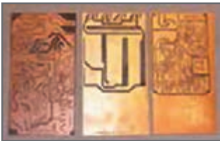
شکل ۱۱۹- انتقال طرح روی فیبر
