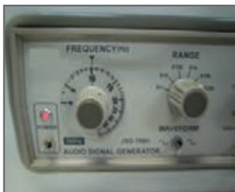
شکل ۳۹ - کلیدهای حوزه کار یا رنج فرکانس
