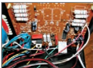
شکل ۱۳۲- برد الکترونیکی و کنترل شدت هوای فشرده
