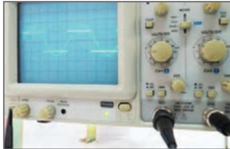
شکل ۶۱- موج سینوسی و مربعی روی صفحه نمایش
