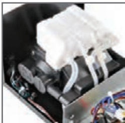
شکل ۱۲۸- مولد هوای فشرده (کمپرسور) باد
