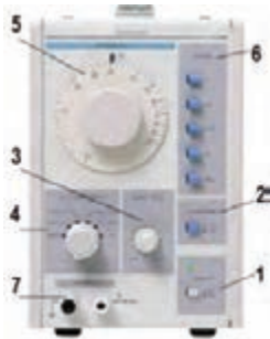
شکل ۳۸ - کلیدهای حوزه کار یا رنج فرکانس
