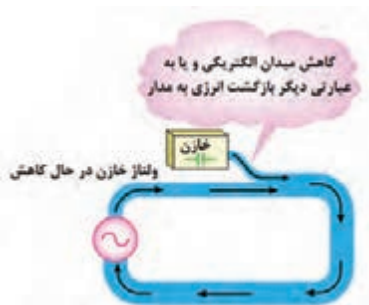
شکل ۲۹ - بازگشت انرژی به مدار
