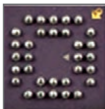
شکل ۲۱ - تصویر ظاهری انواع پکیج‌های BGA
