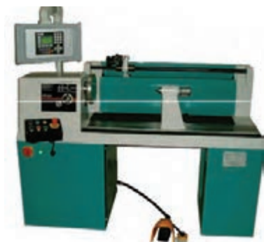
شکل ۲۸- نمونه‌ای از دستگاه بوبین پیچ
