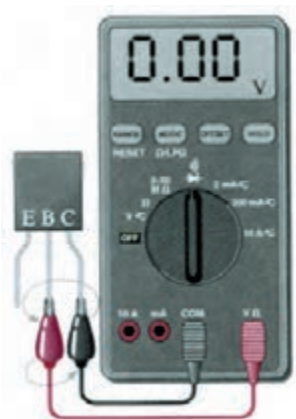
شکل ۱۲-۵۰ ترانزیستور معیوب (اتصال کوتاه)
