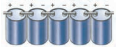
شکل ۲-۱۲۰ اتصال سری پیل‌ها
