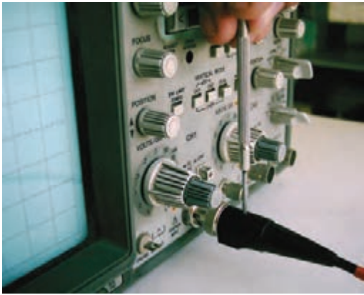
شکل ۸-۶ نحوه‌ی تنظیم پروب
