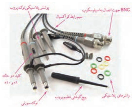
شکل ۵-۶ پروب و اجزای آن
