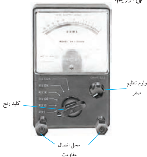
شکل ۲۰-۲ یک نمونه اهم‌تر آزمایشگاهی
