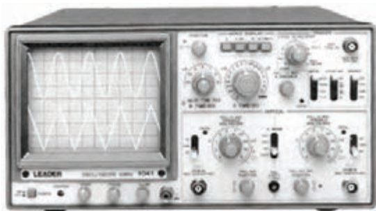
شکل ۶-۳۵ نمایش همزمان دو شکل موج توسط اسیلوسکوپ
