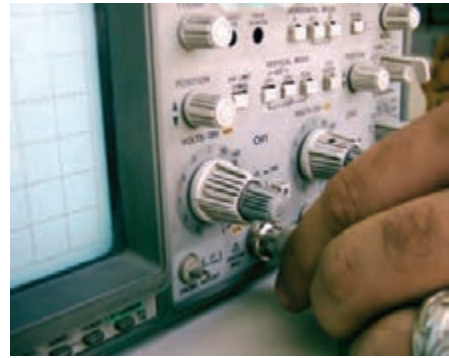
شکل ۶-۶ نحوه‌ی اتصال BNC به اسیلوسکوپ
