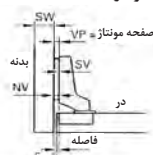
نصب لولای کابینت توکار
