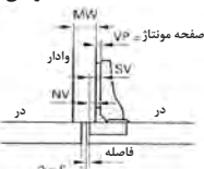
نصب لولای کابینت دو طرفه
