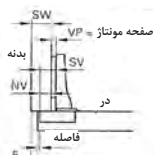
نصب لولای کابینت روکار
