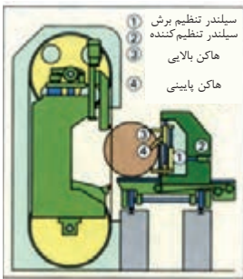
شکل ۳- شماتیک ماشین بلوک بری
