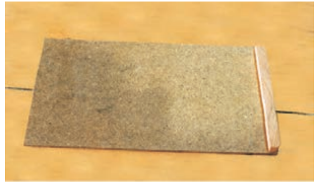
شکل ۹-۶۲- چسباندن زهوار به لبه‌ی کف جعبه.
