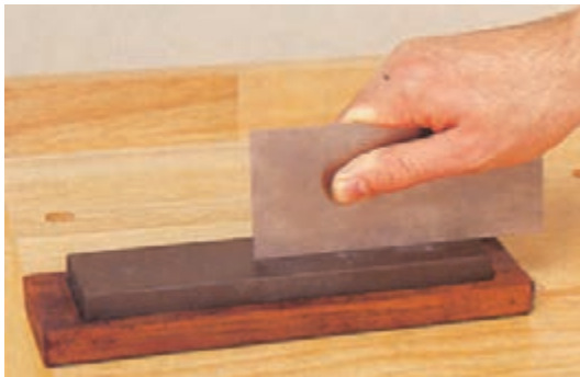
شکل ۲-۸- نمونه‌ی قرار دادن ضخامت لیسسه روی سنگ نفت.
