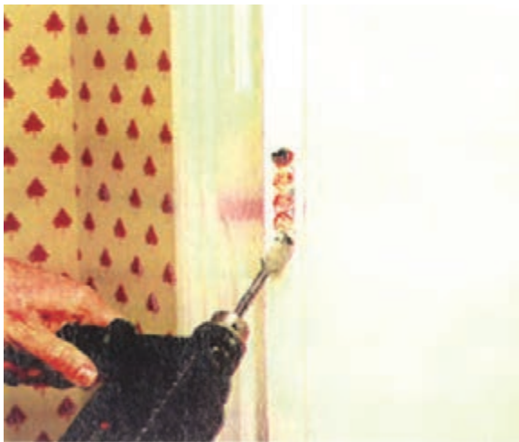
شکل ۱۰-۴۵-۱۰-۴۵. تفلیهی ممل قفل با دریل.
