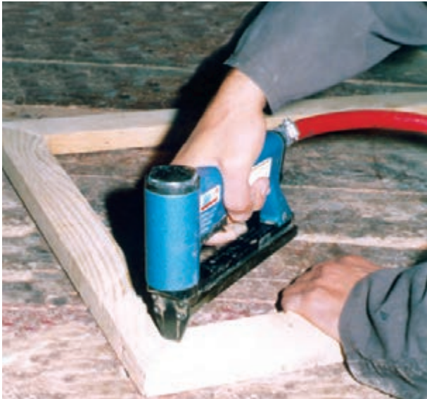
شکل ۱۶-۸. منگنه زدن روی درزهای ۴۵ درجه شده.
