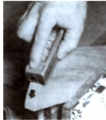
شکل ۲۵- استفاده از پوبسای رنده‌ای، برای صاف کردن قطعه‌ی قوس‌دار.
