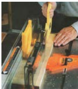
شکل ۳-۱۲- استفاده از وسایل کمکی در هنگام کار.
