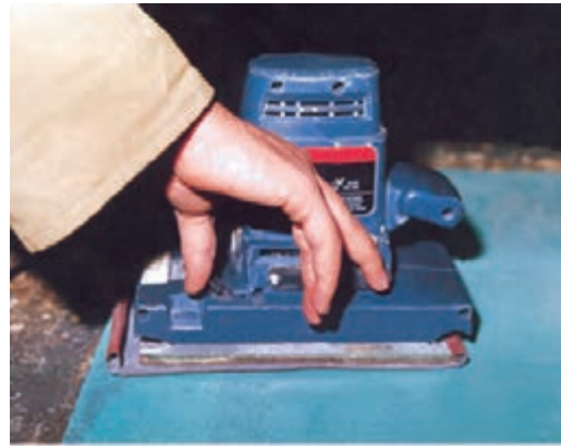
شکل ۷-۴۵- باز کردن فک‌ها به کمک ضامن‌های عقب و جلو.
