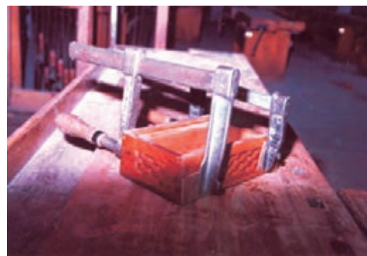
شکل ۹-۶۹- مونتاژ بدنه‌های جعبه.
