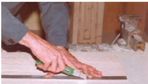
شکل ۵-۲۹- برش (روکش با کاتر)
