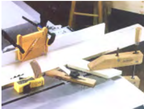
شکل ۱-۲۵- کاربرد گیره‌ی موازی چوبی، برای بستن قطعات به صفحه‌ی ماشین ااره گرد.
