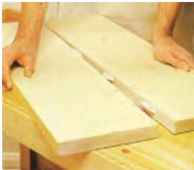
شکل ۹-۹۴- صفحه‌ی رویه، با اتصال بیسکویتی.
