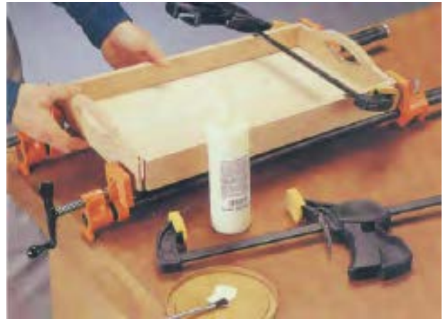
شکل ۱۴۳- برای پسباندن قطعات بزرگ، می‌توان از تنگ دستی استفاده نمود.
