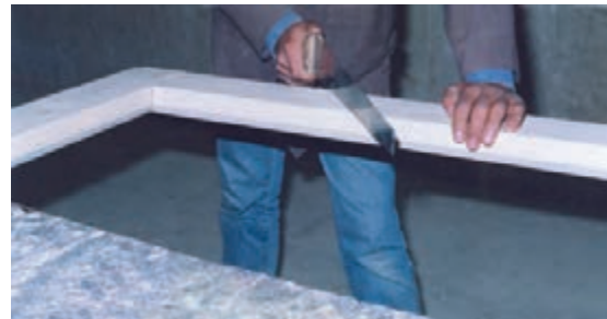
شکل ۱۱-۲۶- ایجاد شیار با اراهی دستی.
