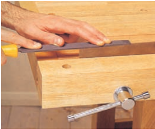
شکل ۲-۷- نمونه‌ی سوهان زدن ضخامت لیسسه.
