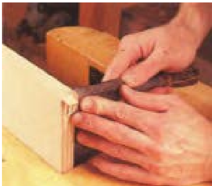
شکل ۵-۳۸- استفاده از کاتر، برای گرفتن روکش اضافی دو سر قطعه.
