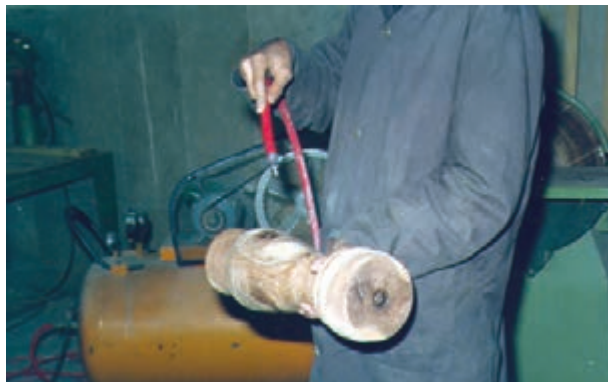
شکل ۲۸-۳. بادگیری قطعات سنباده فورده.
