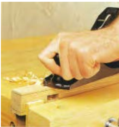
شکل ۱۰۱- سافت پایه به شکل دم گاو، با رنده.
