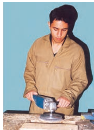
شکل ۷-۴۰- هدایت و کنترل صمغ دستگاه سنباده.
