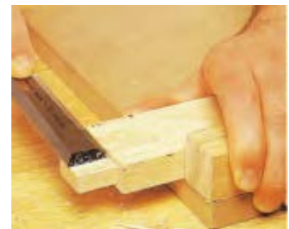
شکل ۹۸- اندازه کردن زبانه با مغار.
