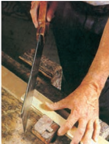
شکل ۱۱-۱۰. برش زهوار، با زاویه‌ی ۴۵ درجه.
