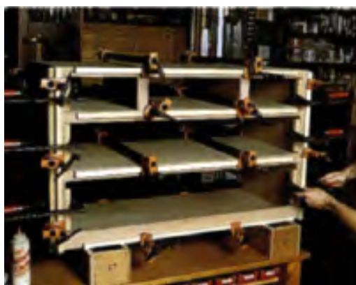
شکل ۱-۵۰- هنگام مونتاژ کابینت‌ها می‌توان برای ممک کردن و گرفتن دوئیدگی، از تنگ و پیچ‌دستی در جهات افقی و عمودی استفاده نمود.
