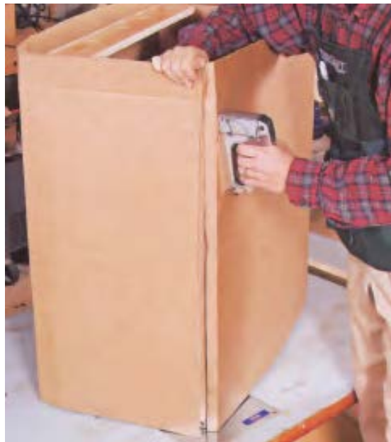
شکل ۲۲-۸- کاربرد منگنه‌ی دستی در بسته‌بندی کالاها.
