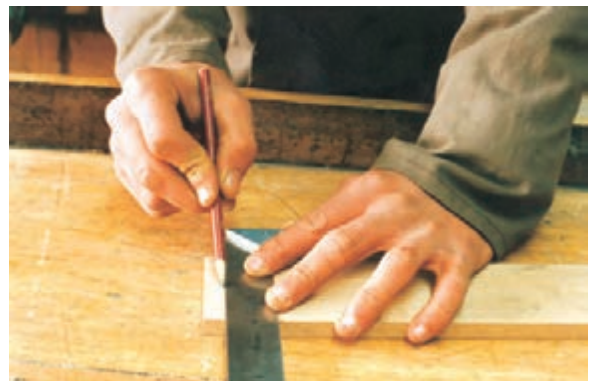
شکل ۹-۶۳- فم کشی ممل اتصال با گونیا.
