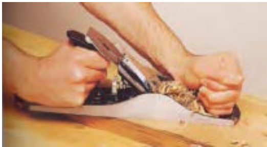
شکل ۱۸-۲- رنده در جهت الیاف، ولی اندکی کج هدایت شود.
