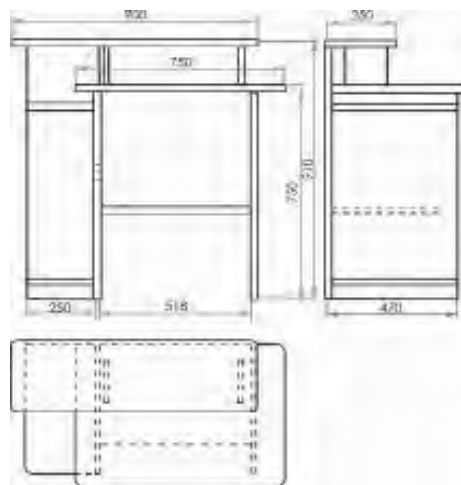
شکل ۱۲-۱۰۹- سه‌نمای میز کامپیوتر.
