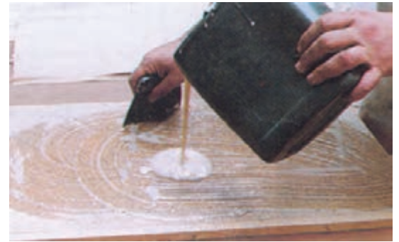
شکل ۶-۶- پفش کردن چسب به‌وسیله‌ی شانه‌ی چسب‌زنی.
