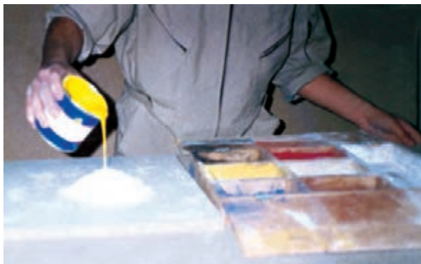
شکل ۴-۳- مواد تشکیل دهنده‌ی بتونه (روغنی).
