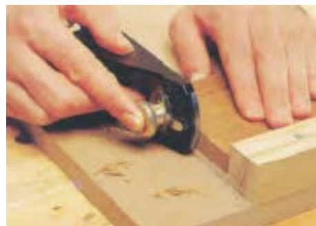
شکل ۲-۲۲- نحوه‌ی رندیدن نر تخته فرده چوب، با استفاده از چوب کمکی.
