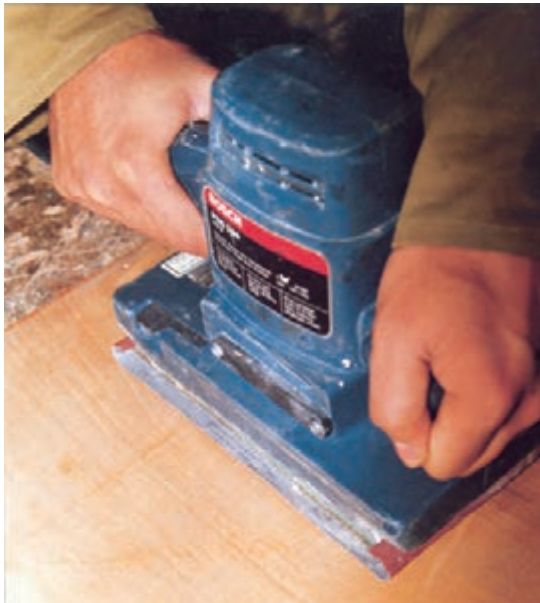
شکل ۷-۱۱. سنباده کاری در جهت الیاف.
