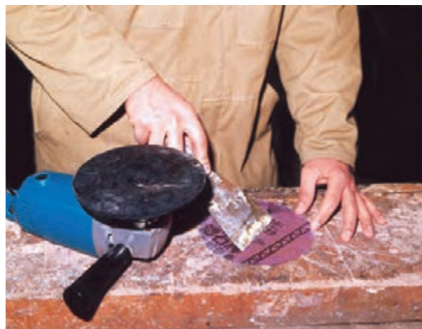
شکل ۷-۳۶- چسب به طور یکنواخت و به صورت یک لایه نازک روی سنباده گرد دستگاه پهن شود.
