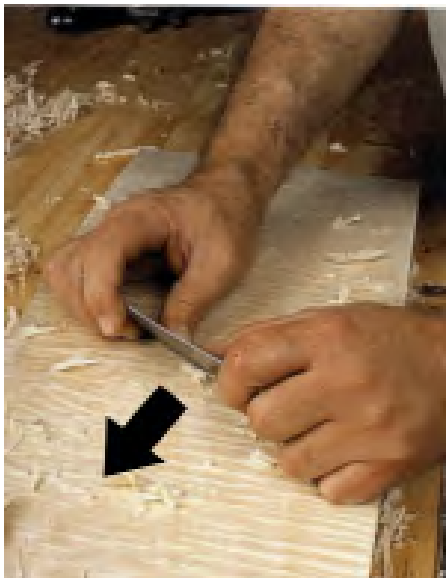
شکل ۲۸- نمونه‌ی گرفتن لیسسه با شست دست و هدایت آن.
