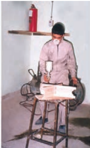
شکل ۳۷-۴- هنگام رنگ کاری، از ماسک و وسایل حفاظت ایمنی فردی لازم استفاده کنید.
