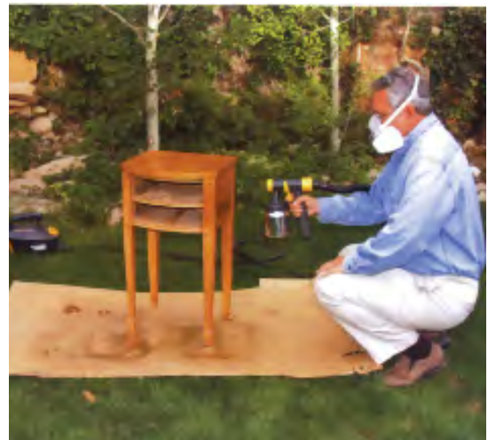
شکل ۲۳-۴. رنگ‌کاری با پیستوله (رنگ پوششی).
