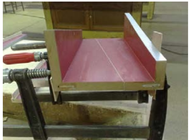
شکل ۱۲-۱۴- در اتصال قلیف، لایه‌ی روکش مصنوعی برداشته شده است.
