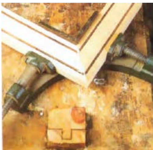
شکل ۱۴۲- برای چسباندن گوشه‌های فارسی قاب، می‌توان از گیره‌ی مخصوص گوشه با فک ۹۰ درجه استفاده کرد.
