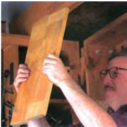
شکل ۱-۳۵- درز تفته‌ها باید طوری باشد، که نور از بین‌شان عبور نکند.
