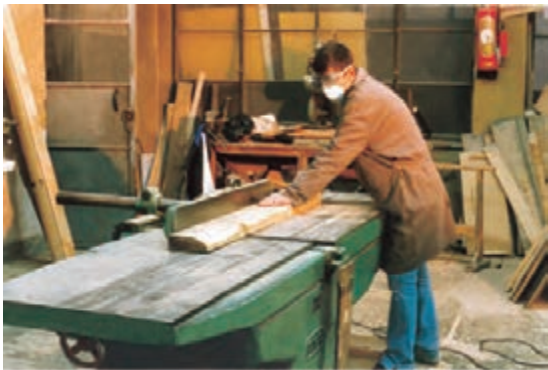
شکل ۹-۹- مقدار باز بودن زیاد گونیا، فطرآفرین است.
