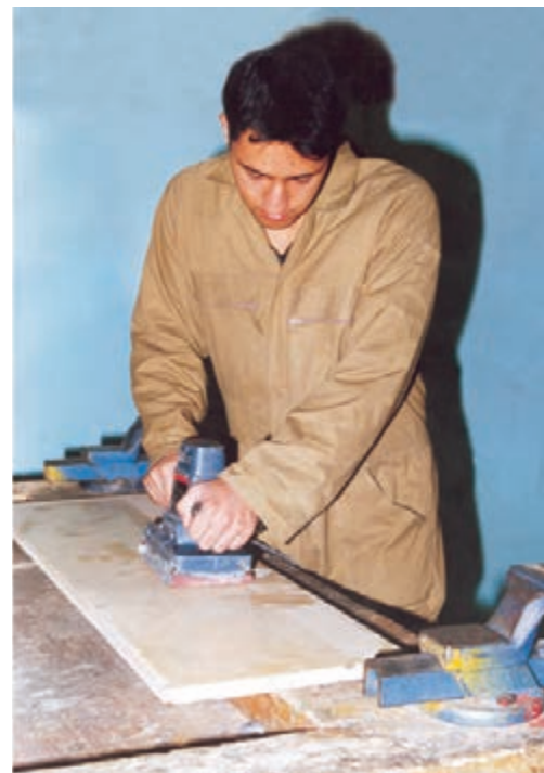
شکل ۷-۱۰. پیچونگی کنترل دستگاه سنباده لرزان.
