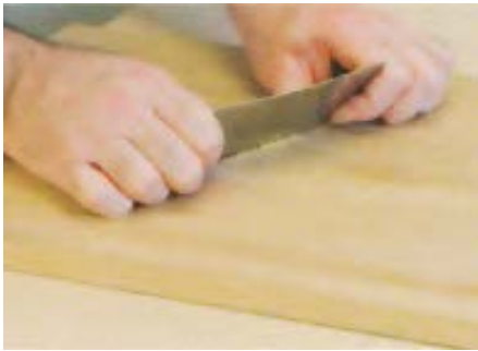
شکل ۲-۱۳- جهت حرکت لیسه، هنگام پُرزگیری.
