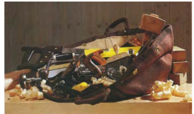
شکل ۱۶-۲- ریفتن ابزارها (روی هم، علاوه بر کاهش تیزی، از دقت آنها نیز می‌کاهد.
