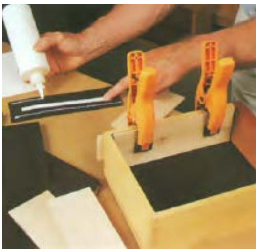
شکل ۱۴۱- برای بستن قطعات نازک، باید از گیره‌ی انبری استفاده نمود.
