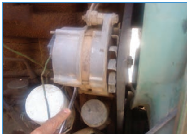
شکل ۳۱-۶ باز کردن پایه آلترناتور
