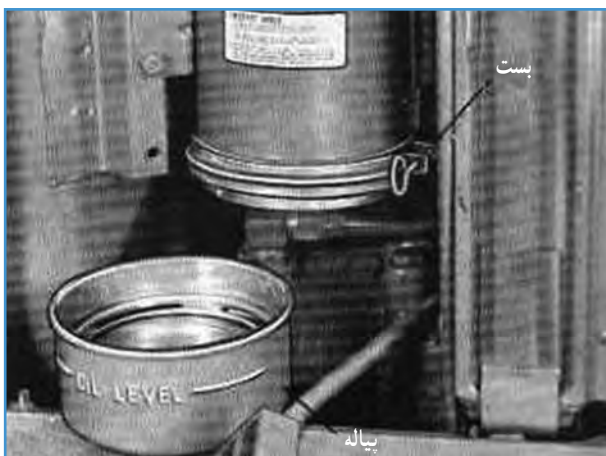
شکل ۱۷-۵- باز کردن پیاله زیر صافی
