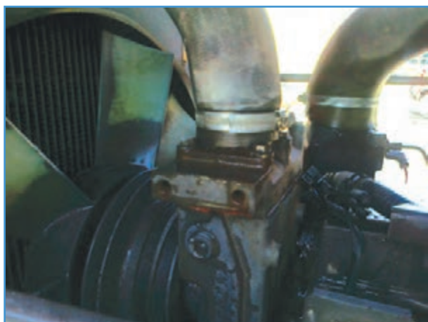
شکل ۱۱-۳- محل بست شیلنگ محفظه ترموستات
