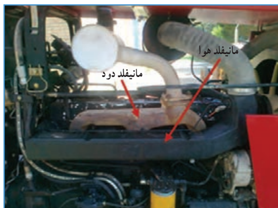
شکل ۲۷-۲- مانیفولد هوا و دود تراکتور MF399
