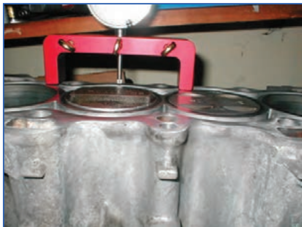
شکل ۲۰۵-۴- کنترل ارتفاع پیستون
