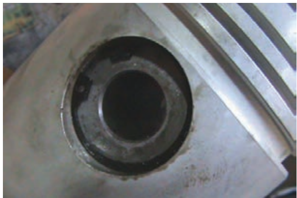
شکل ۱۲۵-۴- جا افتادن خار انگشتی در شیار پیستون
