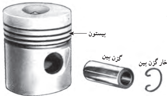
شکل ۳۰-۲- انگشتی و محل نصب آن روی پیستون
