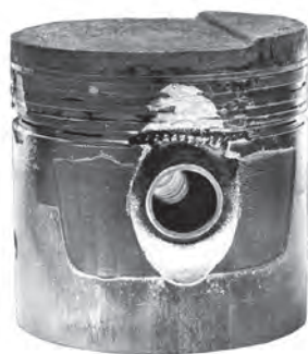
شکل ۴-۱۰۳- سایش غیریکنواخت پیستون
