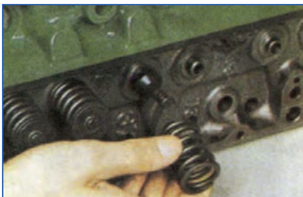
شکل ۲۱-۴- نحوه برداشتن فنر سوپاپ
