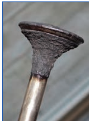
شکل ۴۵-۴- کربن گرفتن بشقابک سوپاپ
