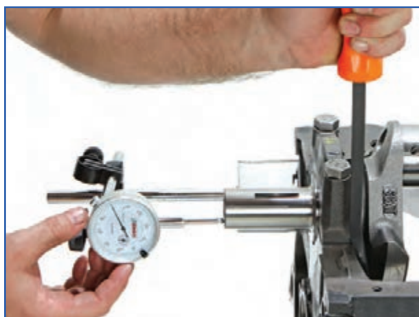
شکل ۱۷۹-۴- اندازه‌گیری لقی طولی میل‌لنگ با ساعت اندازه‌گیری
