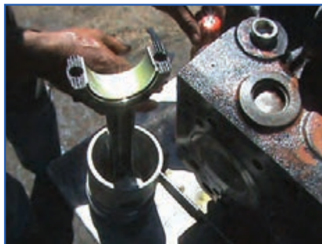
شکل ۱۹۲-۴- روغن‌کاری رینگ‌ها، پیستون و یاتاقان
