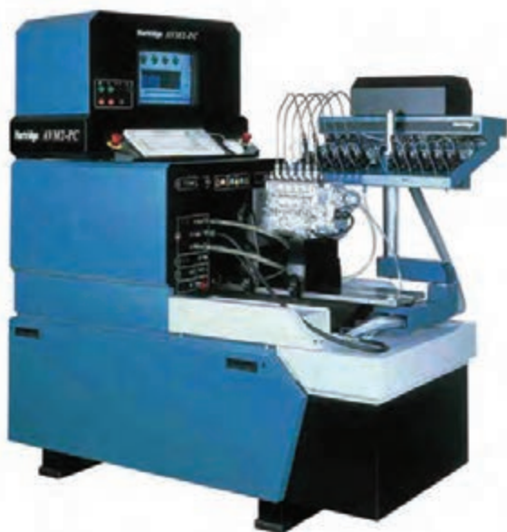
شکل ۲۴-۴- دستگاه آزمودن و تنظیم پمپ انژکتور
