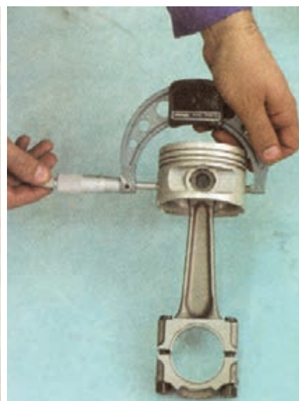
(الف) اندازه‌گیری قطر دامن پیستون
