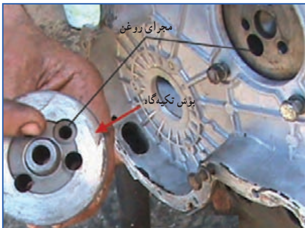
شکل ۶۸-۴- خارج کردن بوش تکیه‌گاه چرخ‌دنده واسط
