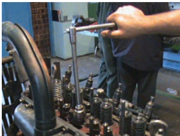
الف) باز کردن پیچ‌های سرسیلندر تراکتور U650
