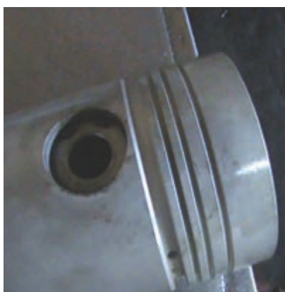
شکل ۱۲۳-۴ میزان داخل شدن انگشتی در پیستون
