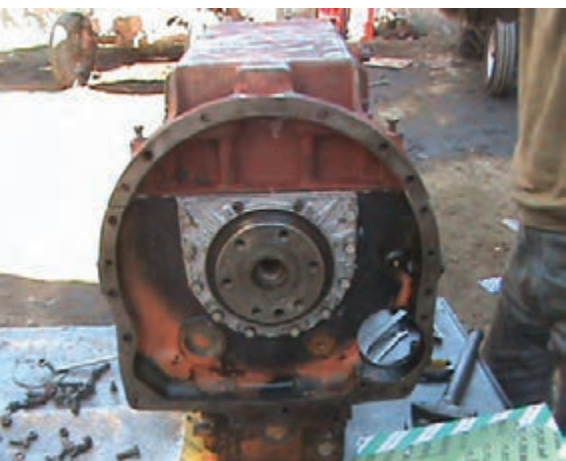
شکل ۱۵۰-۴- انتهای میل لنگ بدون چرخ لنگر
