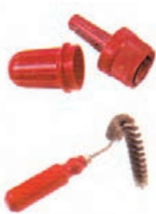
شکل ۲۳-۶- تمیز کردن قطب‌های باتری با ابزار مخصوص
