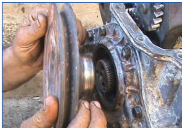
شکل ۴۶-۷- جازدن چرخ تسمه سر میل لنگ
