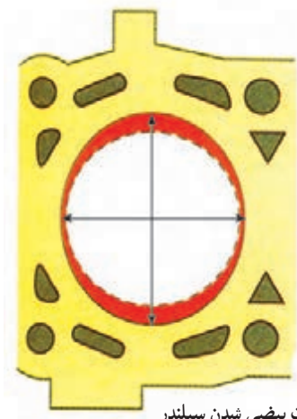
شکل ۱۴۹-۴- وضعیت بیضی شدن سیلندر
