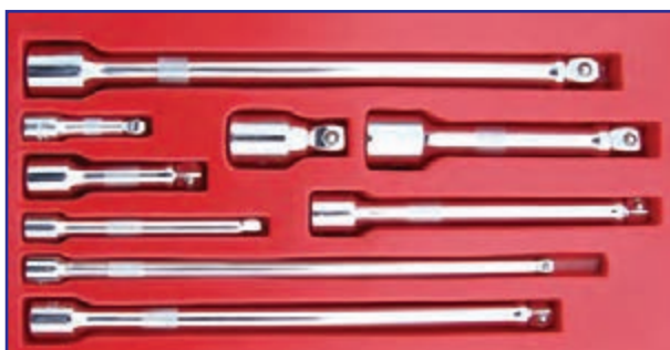
شکل ۴۷-۳- انواع رابط بکس
