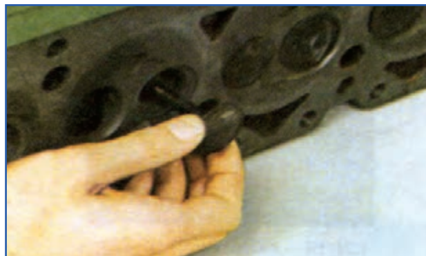
شکل ۲۳-۴- نحوه خارج کردن سوپاپ‌ها
