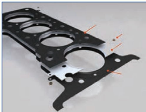
شکل ۴-۴۹ - ساختمان واشر سرسیلندر
