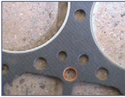
ب) سمت باریک نوار فلزی واشر سرسیلندر
