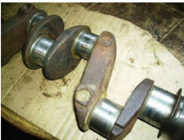
شکل ۲۱۰-۴- میل لنگ با رسوبات کربن
