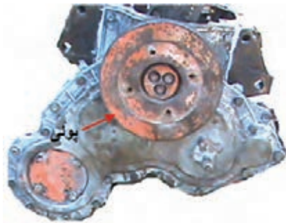
شکل ۴-۶۴- پولی نصب‌شده روی میل‌لنگ
