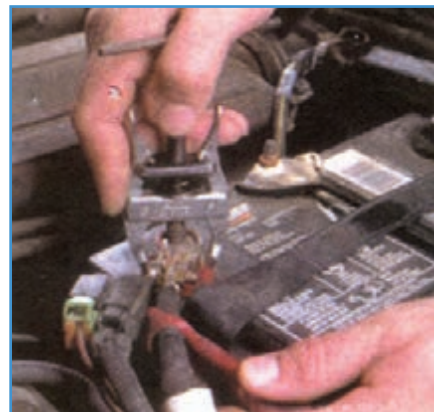
شکل ۸-۶- باز کردن بست مثبت باتری
