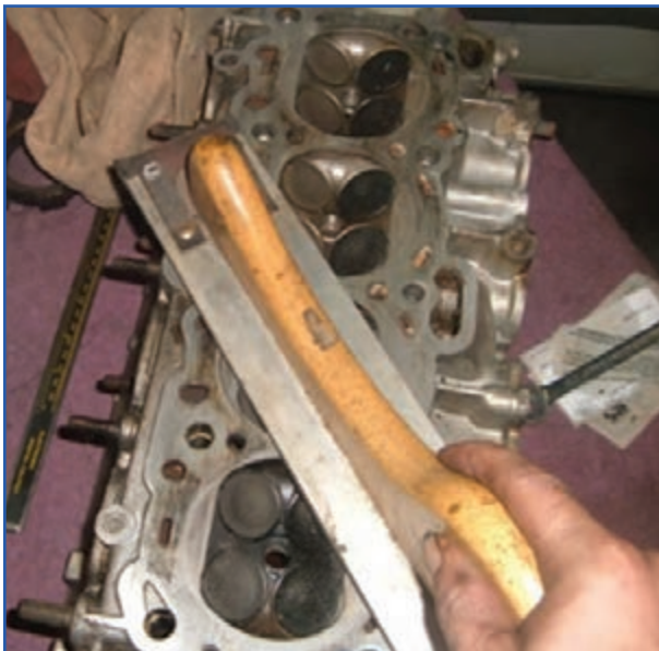
شکل ۴۴-۴- تمیز کردن سرسیلندر با سوهان نرم
