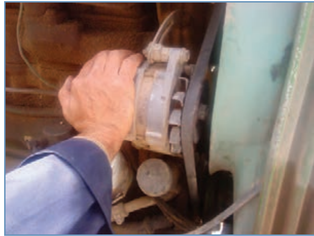
شکل ۳۰-۳- فشار دادن مولد به سمت موتور
