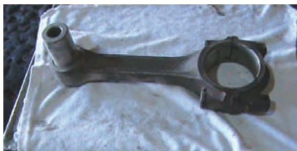
شکل ۱۲۱-۴ امتحان کردن انگشتی روی شاتون
