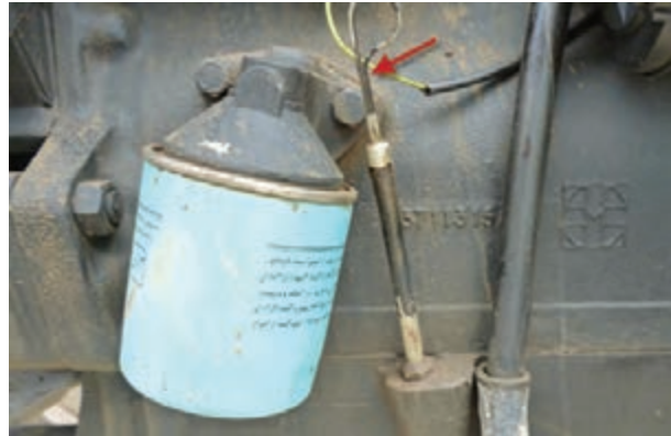
شکل ۳۰-۷- میله سنجش سطح روغن تراکتور MF285
