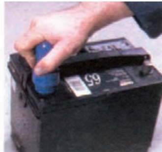
شکل ۲۳-۶- تمیز کردن قطب‌های باتری با ابزار مخصوص
