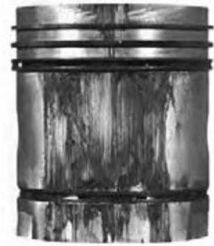
الف) خط و خش روی پیستون
