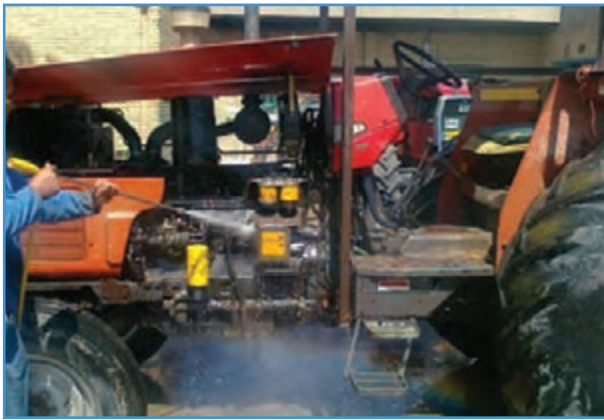
شکل ۵-۱- شستشوی موتور تراکتور
