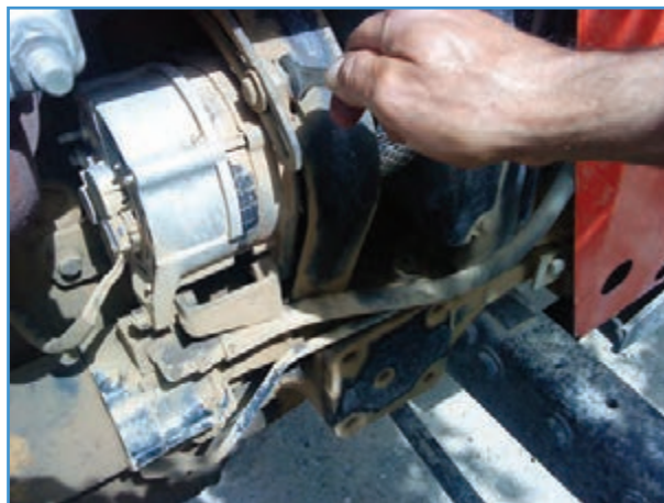
شکل ۲۹-۶ شل کردن پیچ و مهره تنظیم
