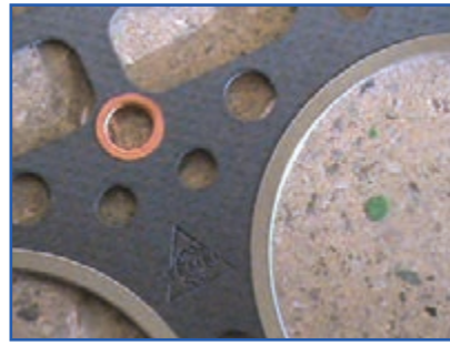
الف) سمت پهن نوار فلزی واشر سرسیلندر
