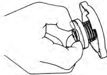
شکل ۱۷-۳ - آزمون سوپاپ مکش در رادیاتور
