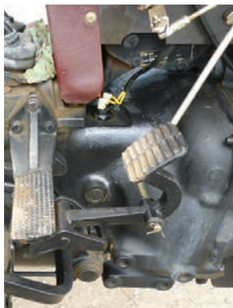
شکل ۱۱-۳- پیچ‌های اتصال موتور به جعبه‌دنده قسمت پایین
