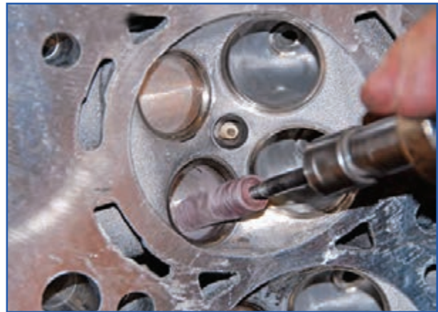
الف) نحوه تمیز کردن محفظه پشت سوپاپ
