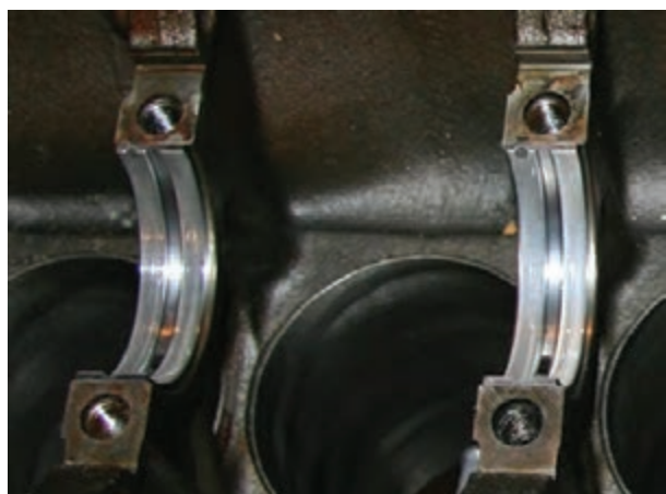
شکل ۱۸۵-۴ جازدن یاتاقان‌های ثابت
