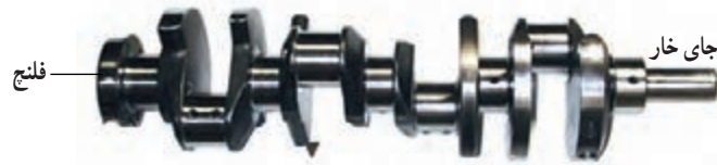
شکل ۳۵-۲ محل فلنج و جای خار روی میل لنگ
