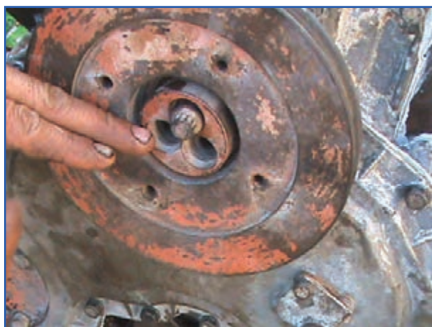
شکل ۴-۵۵- بستن پیچ سر میل‌لنگ تراکتور
