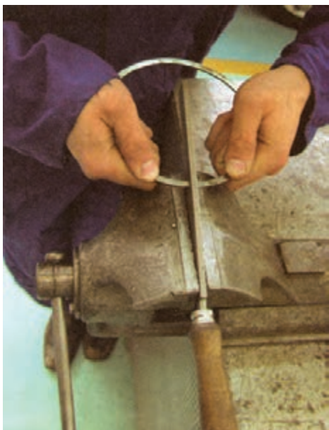
شکل ۱۳۰-۴- ساییدن دهانه رینگ با سوهان
