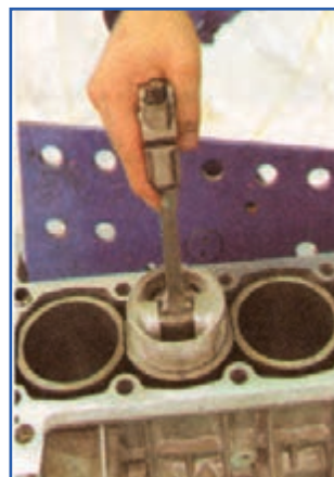
شکل ۱۲۷-۴- طرز قرار دادن رینگ داخل سیلندر
