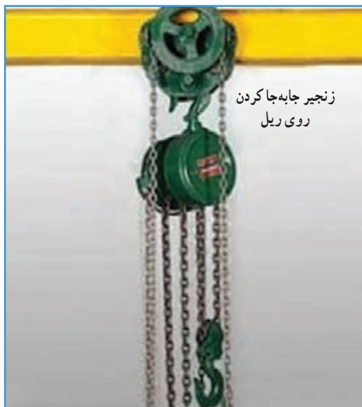
شکل ۲۰-۴- اتصال جرثقیل سقفی به ریل
