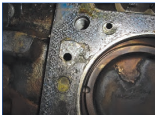
شکل ۴۲-۴- واشر سرسیلندر چسبیده به سیلندر
