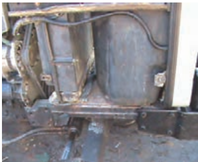
و) باز کردن بست نگهدارنده باک
