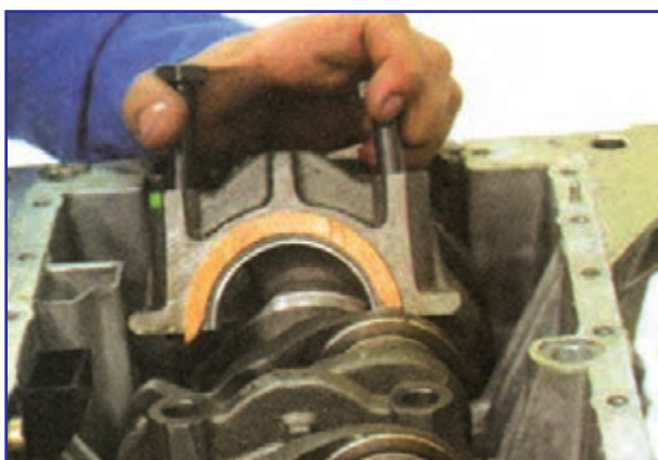
شکل ۱۸۱-۴- برداشتن کپه یاتاقان دارای بغل یاتاقانی
