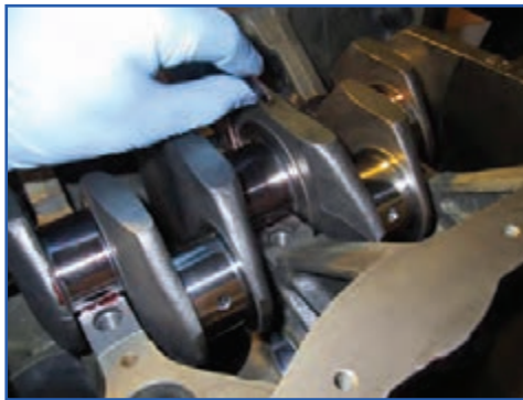
شکل ۱۸۳-۴- خارج کردن بغل یاتاقانی
