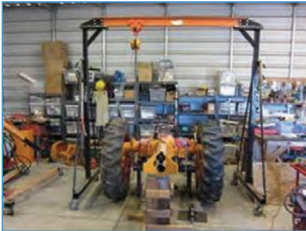
شکل ۲۴-۴ کاربرد جرثقیل دروازه‌ای متحرک
