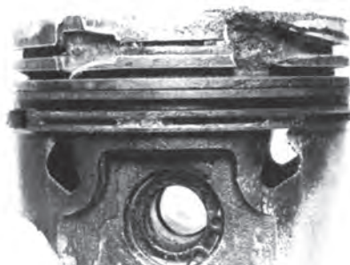
شکل ۴-۱۰۰- تخریب شدید جای رینگ
