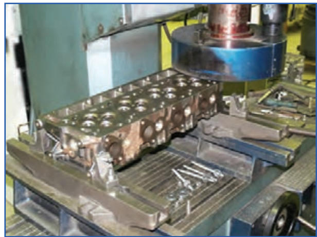
شکل ۳۲-۴- دستگاه کف تراشی سرسیلندر
