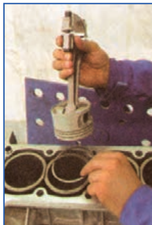
شکل ۱۲۷-۴- طرز قرار دادن رینگ داخل سیلندر
