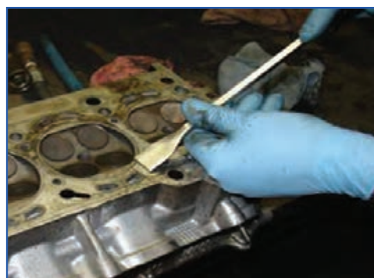
شکل ۴۲-۴- واشر سرسیلندر چسبیده به سیلندر
