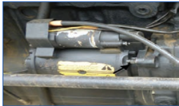
شکل ۳-۸- پیچ‌های نگهدارنده استارت‌تر تراکتور MF285
