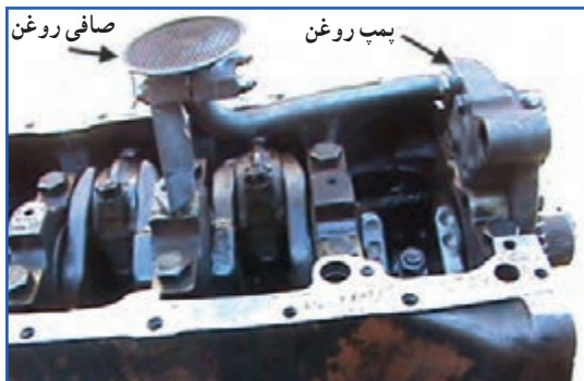
الف) محفظه میل‌لنگ بدون کارتر
