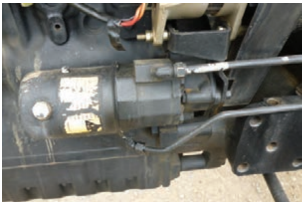
شکل ۱۴-۳- لوله‌های پمپ فرمان
