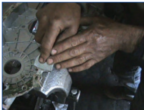
شکل ۴۱-۷- تمیز کردن واشر سینی جلو با کاردک
