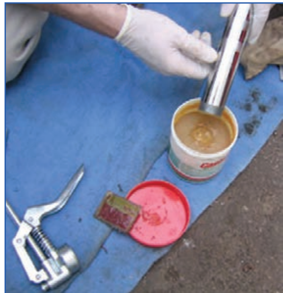
شکل ۴۸-۷- مراحل پر کردن گریس پمپ دستی
