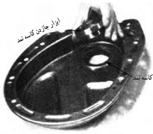
شکل ۴۳-۷- نحوه جازدن کاسه نمد روی سینی جلو
