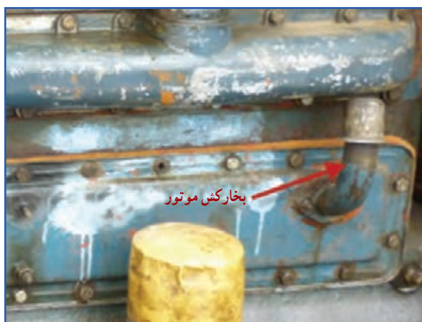
شکل ۲۶-۷- تهویه محفظه کارتر تراکتور U650M
