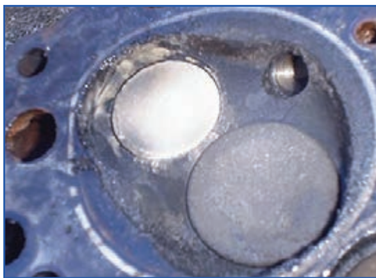
شکل ۴۱-۴- تمیز کردن اتاق احتراق
