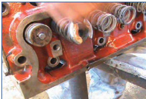
شکل ۱۹-۴- باز کردن اهرم فنر جمع کن
