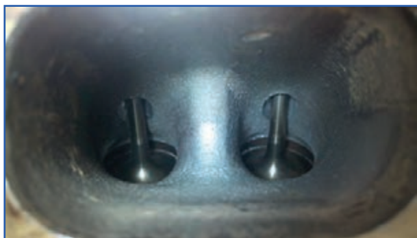
ب) محفظه تمیز پشت سوپاپ‌ها
