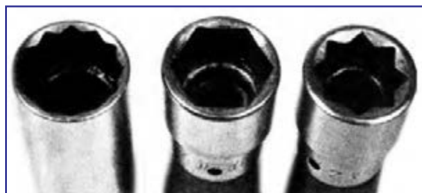
شکل ۳۵-۳- آچار بکس شش، هشت و دوازده گوش
