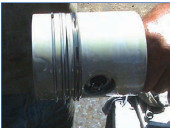
شکل ۱۴۰-۴- روغن‌کاری همه رینگ‌ها و پیستون
