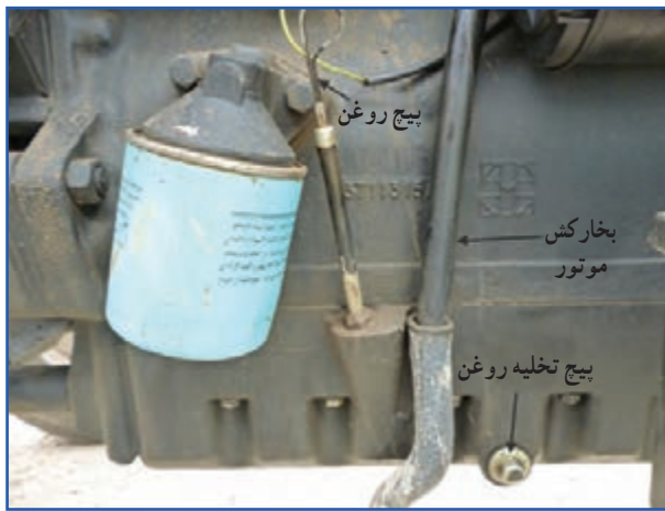
شکل ۲۷-۷- پیچ تخلیه روغن کارتر MF285
