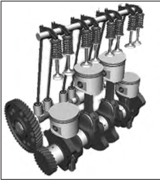
شکل ۸-۲ - قطعات مکانیزم باز و بسته شدن سوپاپ‌ها
