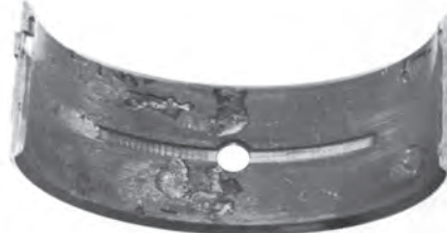
شکل ۱۶۷-۴- نقاط ذوب‌شده روی یاتاقان
