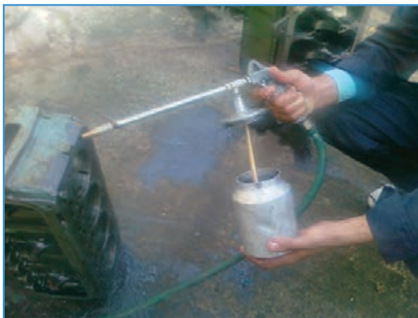
شکل ۱-۳- باز کردن مخزن پیستوله شستشو
