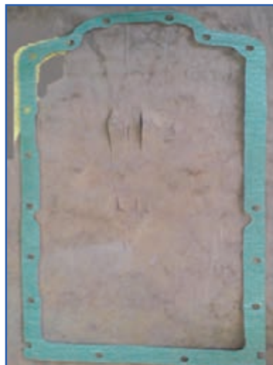
ب) واشر کارتر چوب‌پنبه‌ای MF285
