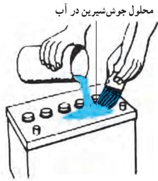
ب) تمیز کردن با قلم مو و محلول جوش شیرین
