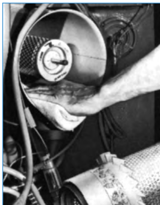
شکل ۱۳-۵- تمیز کردن بدنه صافی با پارچه
