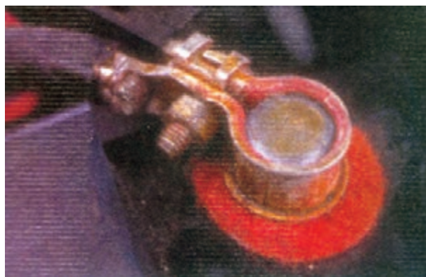
شکل ۱۰-۶- مالیدن گریس به بست باتری
