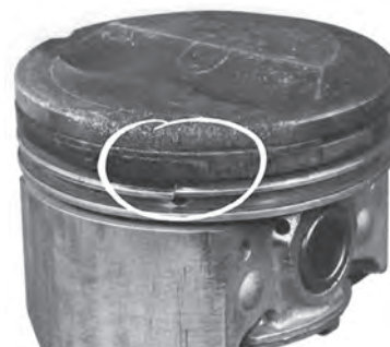
شکل ۴-۹۹- شکستن رینگ و تخریب جای رینگ
