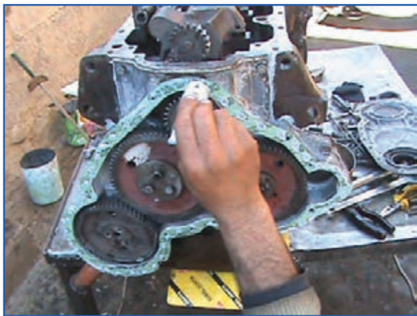
شکل ۴۴-۷- چسب زدن به محل نصب سینی جلو
