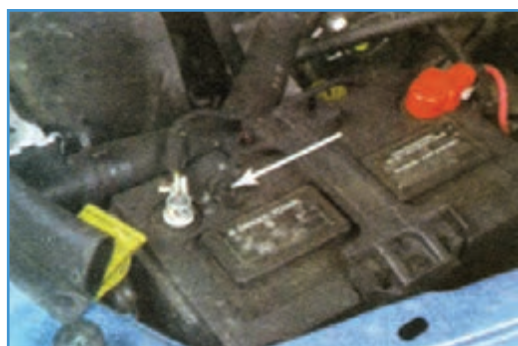
شکل ۳-۶- محل دریچه شیشه‌ای در باتری خشک و طرز تعیین شارژ یا دشارژ بودن باتری توسط آن
