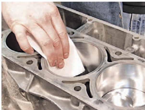
شکل ۲۰۸-۴- تمیز کردن داخل سیلندر
