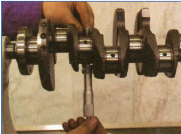
شکل ۱۶۲-۴- اندازه‌گیری قطر محورهای میل‌لنگ
