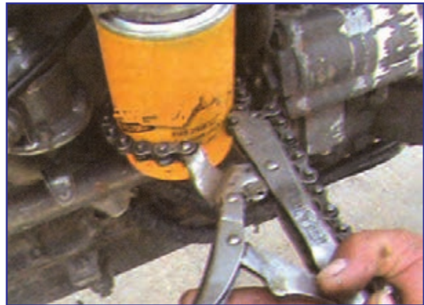
شکل ۱۶-۷- باز کردن صافی روغن با آچار مخصوص
