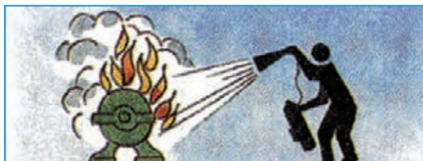
شکل ۱۴-۱- خاموش کردن آتش با دی اکسید کربن
