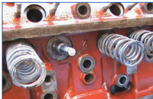
شکل ۲۱-۴- نحوه برداشتن فنر سوپاپ
