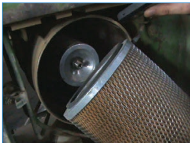
شکل ۵-۵ - صافی خشک و محل قرار گرفتن آن
