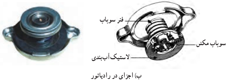
شکل ۳-۵- در رادیاتور و طرز کار سوآپ‌های آن
