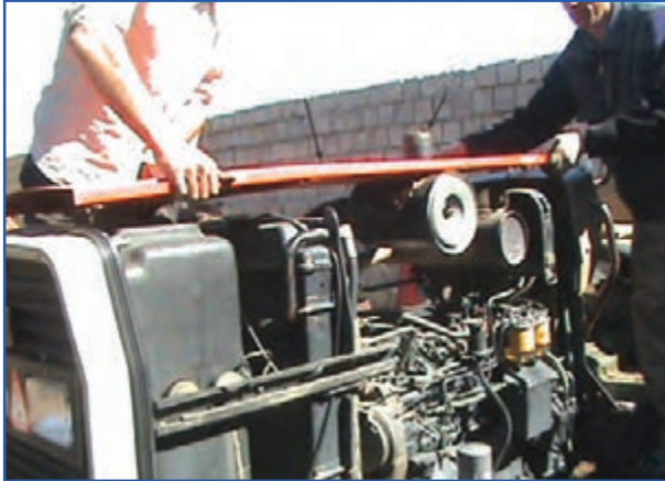
شکل ۱-۴- برداشتن کاپوت از روی موتور
