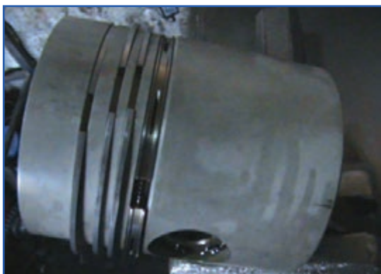
شکل ۱۳۹-۴- ترتیب قرار گرفتن رینگ‌ها روی شیار پیستون
