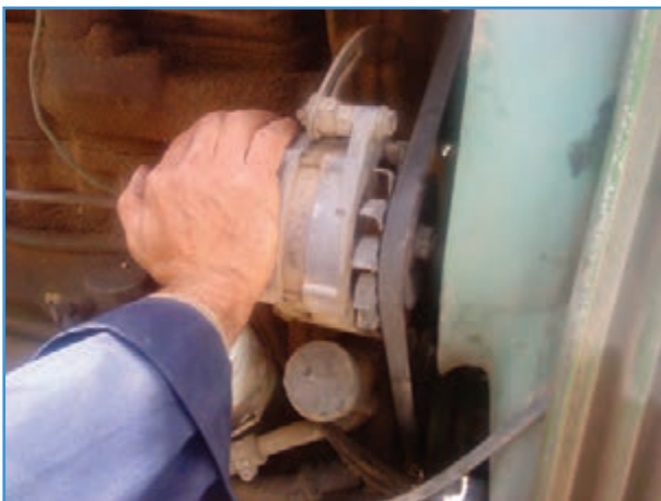
شکل ۳۰-۶ فشار دادن آلترناتور به عقب
