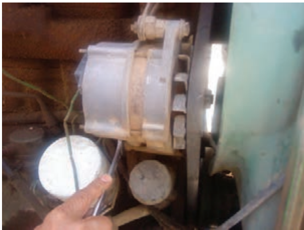
شکل ۳۹-۶ سفت کردن پیچ پایه
