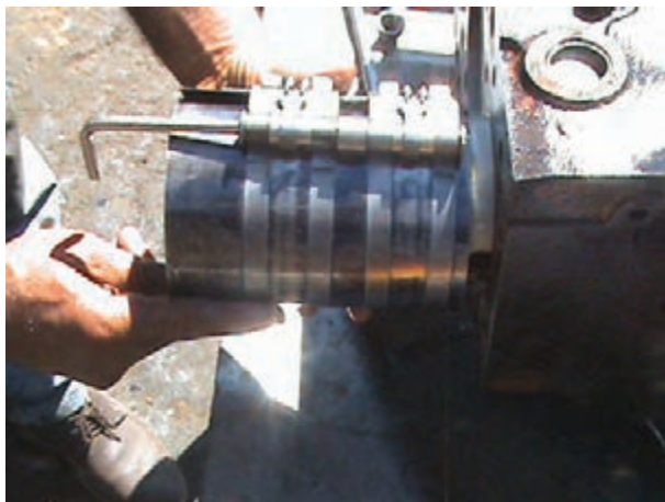
شکل ۱۹۸-۴- جمع کردن رینگها با رینگ جمع کن
