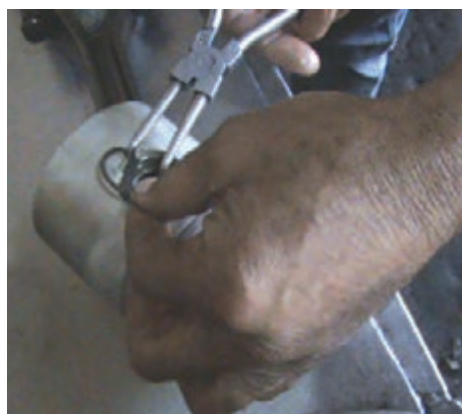
شکل ۱۲۵-۴ طرز جازدن خار انگشتی
