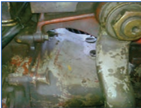
شکل ۹-۳- پیچ‌های اتصال موتور به جعبه‌دنده قسمت بالا
