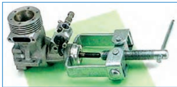
شکل ۷۷-۳- خارج کردن بلبرینگ با بلبرینگ کش
