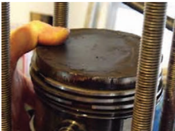
شکل ۲۰۷-۴- رسوبات کربن روی سطح پیستون
