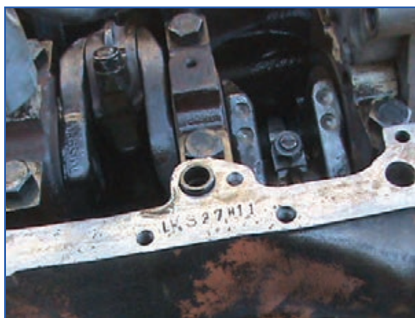
شکل ۸۲-۴- محفظه میل‌لنگ بدون بلمپ روغن
