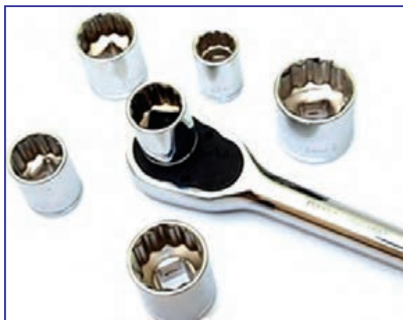
شکل ۴۸-۳- اتصال بکس به دسته بکس جفجغه ای
