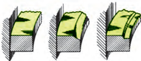
شکل ۱۳۲-۴- فرم خاص در لبه داخلی رینگ
