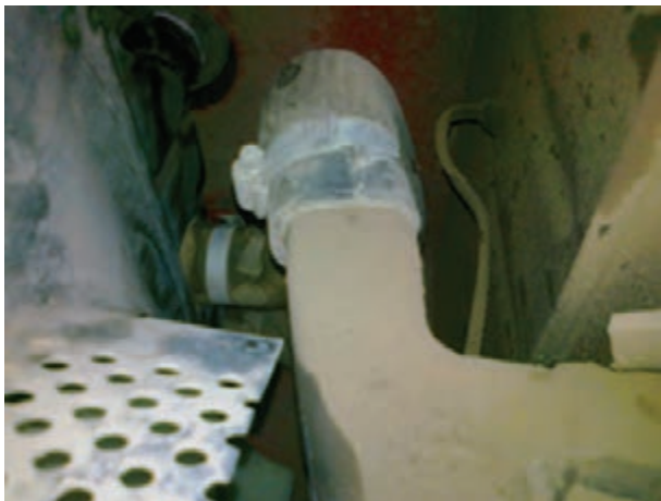
شکل ۱۵-۳- اتصال شیلنگ رادیاتور
