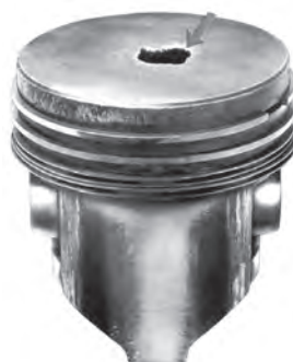
شکل ۴-۱۰۲- سوراخ شدن سر پیستون
