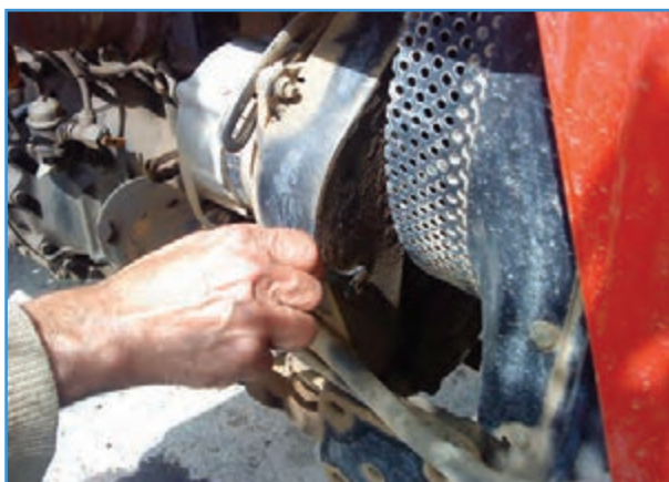
شکل ۳۲-۶ باز کردن روکش محافظ تسمه
