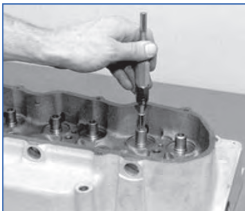
شکل ۴۰-۴- تمیز کردن گیت سوپاپ
