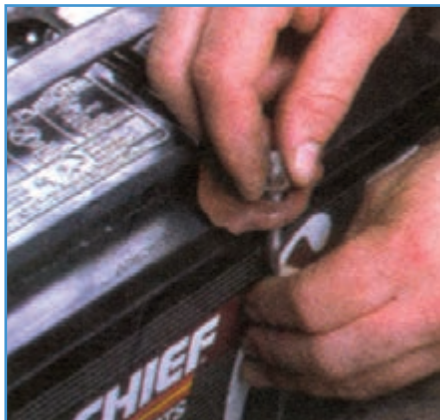
شکل ۹-۶- باز کردن بست نگهدارنده باتری
