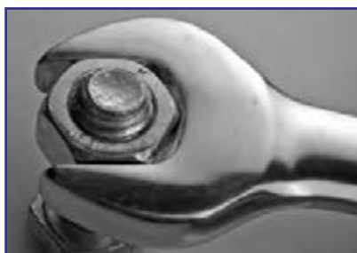
شکل ۲۸-۳ آچار تخت با سر زاویه دار (اینجی)
