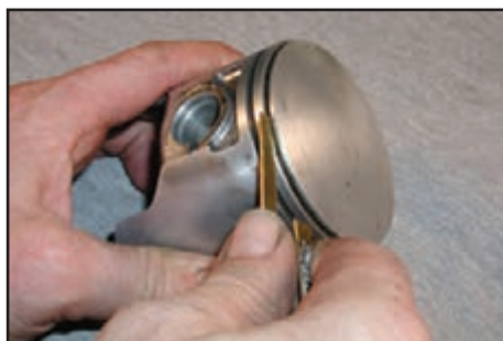
(د) تمیز کردن شیپار با ابزار برنجی
