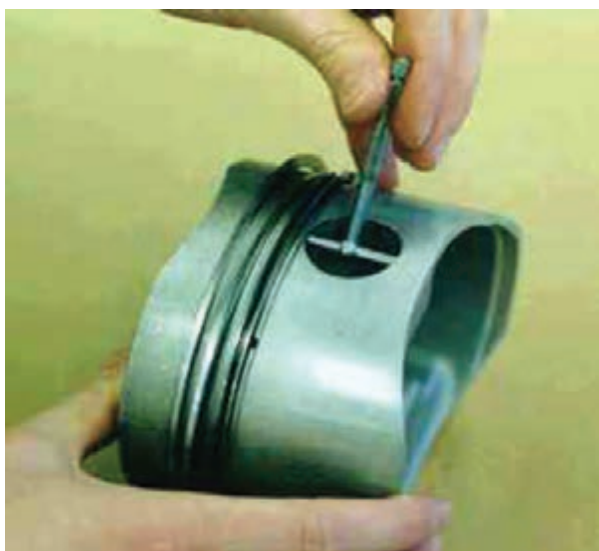
شکل ۱۱۷-۴- اندازه‌گیری سوراخ انگشتی روی پیستون
