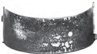
شکل ۱۶۸-۴- اثرات سوختگی روی یاتاقان
