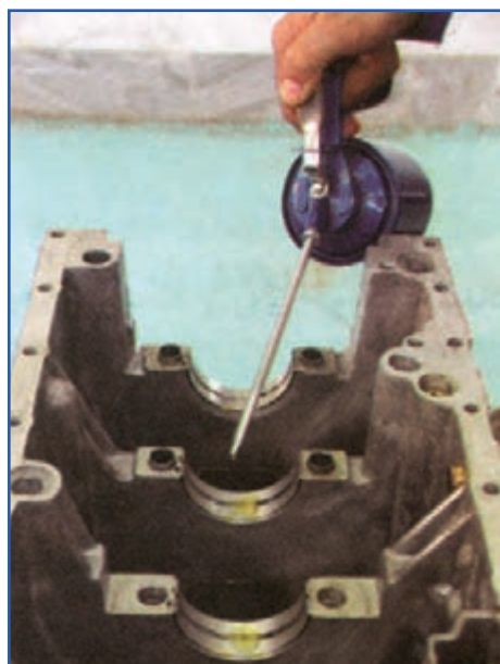
شکل ۱۸۷-۴ روغن کاری یاتاقان‌های ثابت
