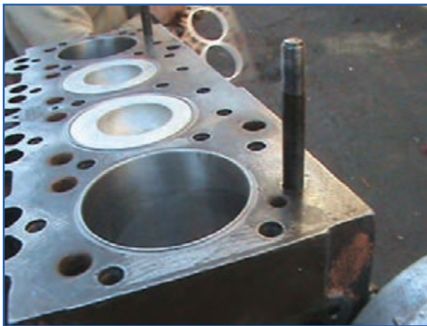
شکل ۵۳-۴- کنترل تمیز بودن سطح سرسیلندر و باز بودن مجاری
