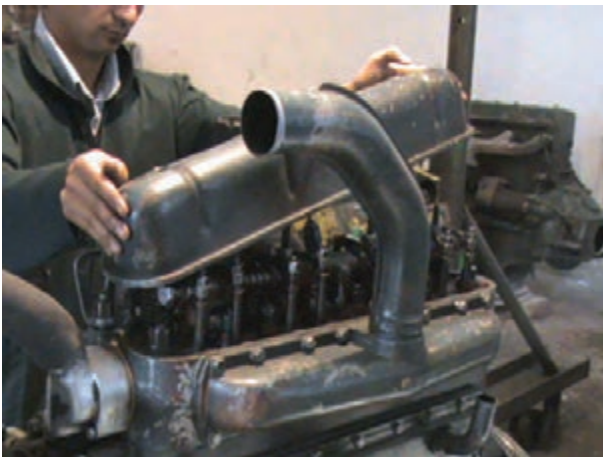
شکل ۴-۷- برداشتن درپوش سوپاپ
