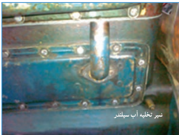
شکل ۸-۳- شیر تخلیه آب سیلندر تراکتور U650
