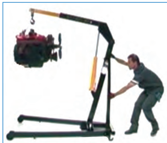
شکل ۱۸-۴- کاربرد از جرثقیل متحرک دستی
