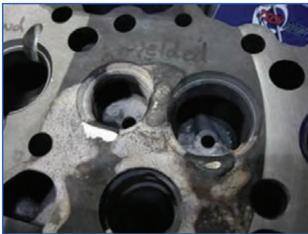
شکل ۲۶-۴- ترمیم ترک سرسیلندر با جوشکاری
