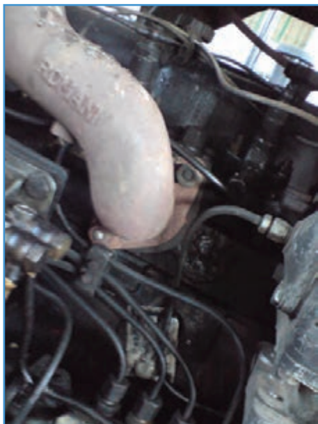
شکل ۳۱-۵- محل اتصال مانیفولد به سرسیلندر تراکتور U650
