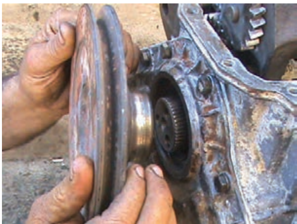
شکل ۴-۵۷- خارج کردن پولی میل‌لنگ
