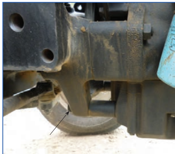
شکل ۱۷-۳- محل پیچ‌های اتصال موتور به جلوی تراکتور
