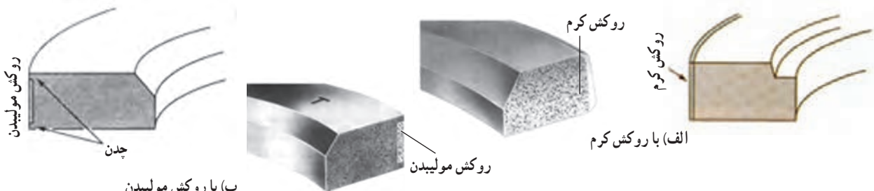
شکل ۲۴-۲- مقطع رینگ‌های تراکم روکش‌دار
