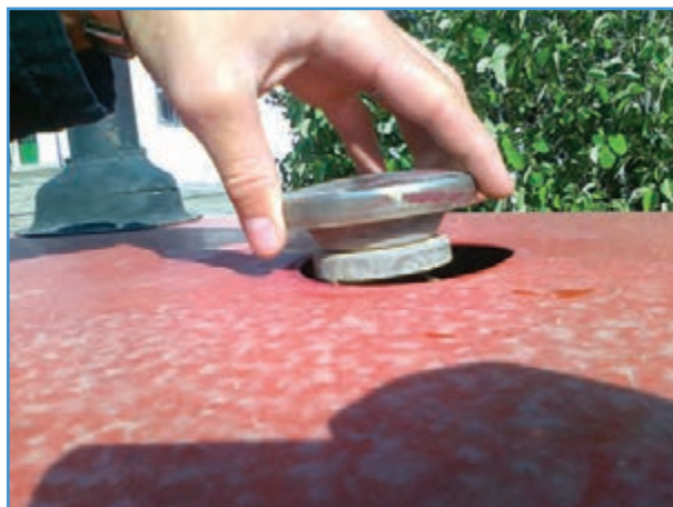
شکل ۷-۳- باز کردن در رادیاتور تراکتور MF285
