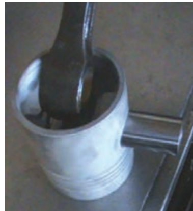
شکل ۱۲۲-۴ اتصال شاتون به پیستون و جازدن انگشتی
