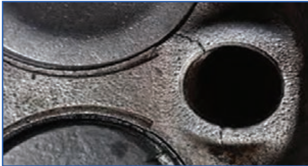
ب) ترک بین سیلندر و سوراخ پیچ سرسیلندر
