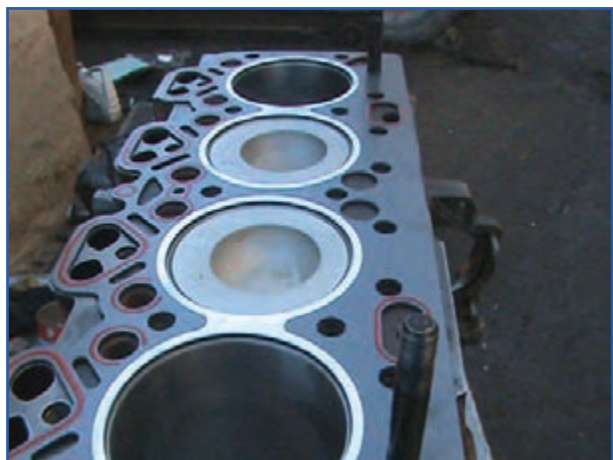
شکل ۵۲-۴- قرار دادن واشر سرسیلندر روی بدنه سیلندر
