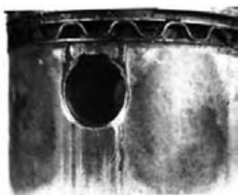
شکل ۱۱۹-۴- خراب شدن جای خار انگشتی
