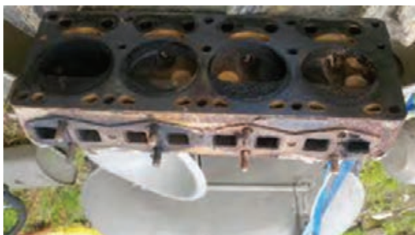
شکل ۲۰۹-۴- رسوبات کربن سطح سرسیلندر
