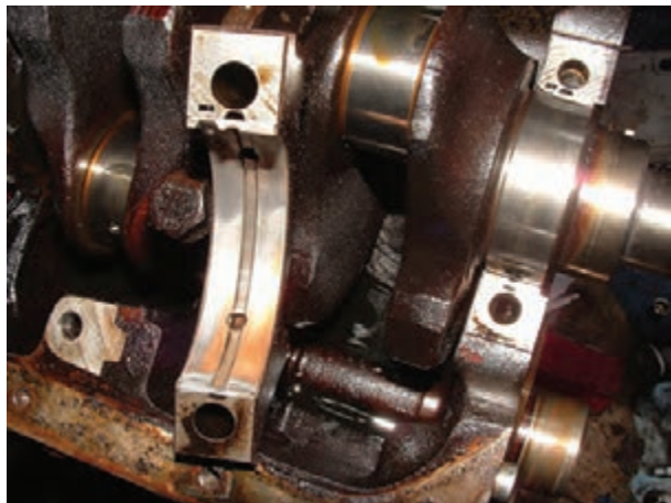
شکل ۱۸۲-۴- باز کردن کپه یاتاقان ثابت
