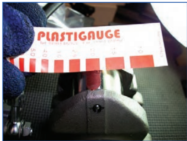
شکل ۱۷۶-۴- اندازه گیری دو بهنی پلاستی گیج شابلون
