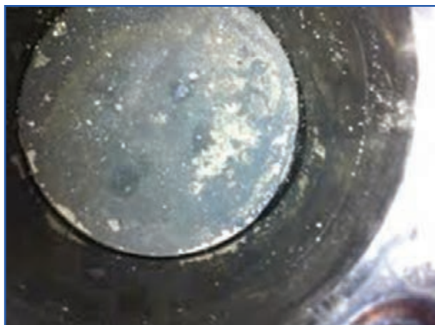
شکل ۲۰۶-۴- رسوبات کربن روی سطح پیستون
