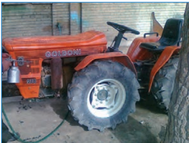
شکل ۱-۴- شستشوی موتور تراکتور با پیستوله شستشو
