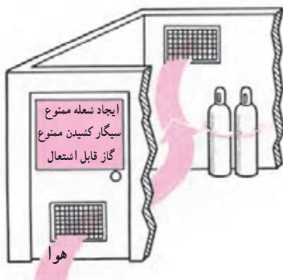
شکل ۸۷-۲- چگونگی بستن کپسول به دیوار و تهویه‌ی انبار کپسول‌ها
