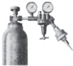
شکل ۲-۴۴- شیر یک طرفه بعد از رگولاتور
