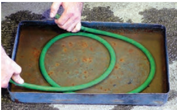
شکل ۲-۹۹ – کنترل نشتی شیلنگ در آب
