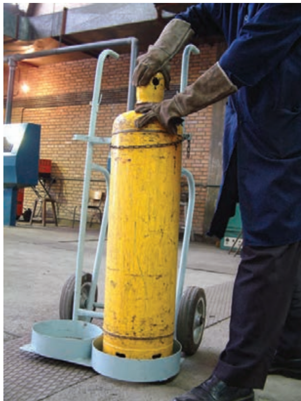
شکل ۱۹-۲- کپسول استیلن و کلاهک آن
