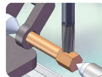
چند وجهی کردن قطعه با دستگاه تقسیم مستقیم
