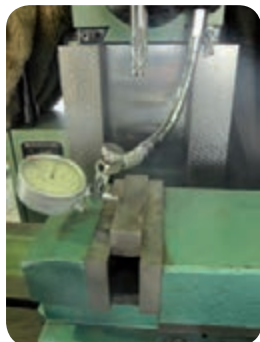
استفاده از بلوک‌های گونیایی برای کنترل فک‌های گیره
