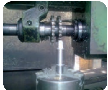
زدن دو سطح بغل به صورت هم زمان (استرادل)
