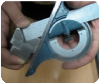
کنترل شیب قطعه با زاویه سنج انیورسال
