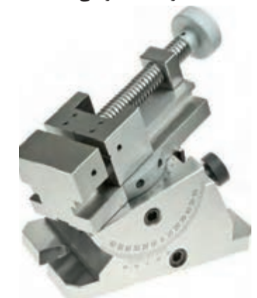
استفاده از زیر سری زاویه‌دار برای شیب‌تراشی
