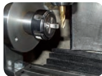
چهارگوش کردن قطعه به کمک دستگاه تقسیم
