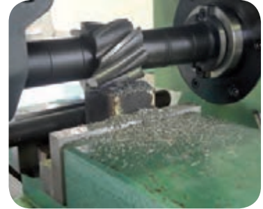
کف تراشی با تیغه فرز غلطکی و با استفاده از ماشین فرز افقی
