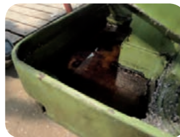
پایه ماشین محلی برای ذخیره مایع خنک کننده
