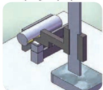
اندازه گیری عمق شیار
