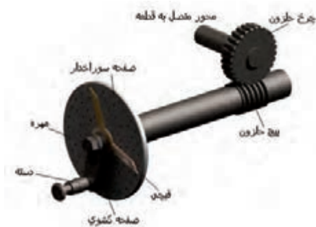
نمای کامل تری از سیستم چرخ حلزون و پیچ حلزون در دستگاه تقسیم غیر مستقیم
