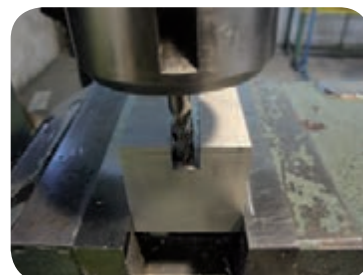
شیار تراشی با تیغه فرز انگشتی
