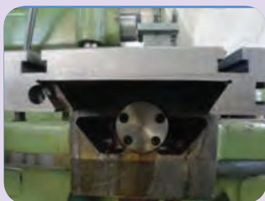
کاربرد شیار دم چلچله ای در سوپرت دستگاه
