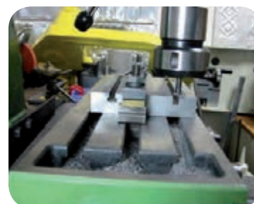
زدن شیار راست گوشه در ابتدای ایجاد شیار T
