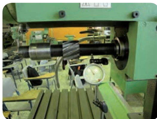
کنترل لنگی میله فرزگیر با ساعت اندازه گیری
