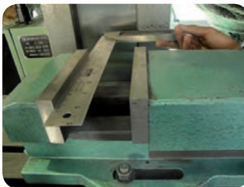
تنظیم فک‌های گیره با استفاده از گونیا
