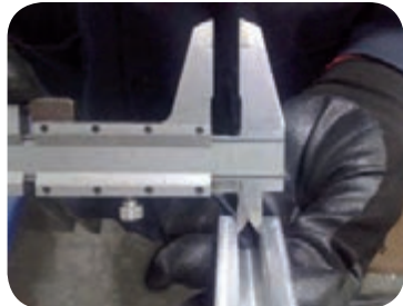
اندازه گیری پهناي شیارها با کولیس ورنیه دار
