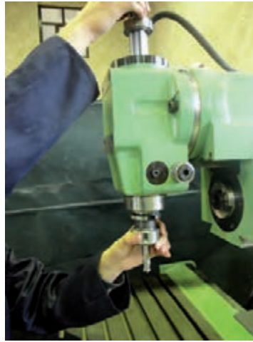
نحوه بستن کُلت بر روی دستگاه
