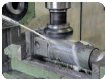
اعمال مایع خنک‌کننده بر سطح قطعه کار
