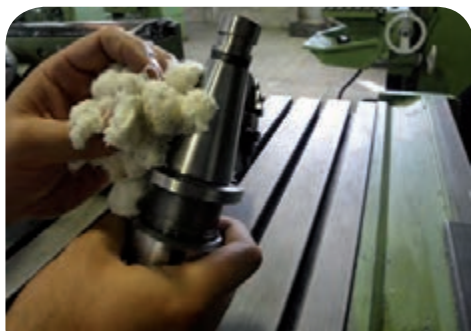
تمیز کردن دنباله میله فرزگیر
