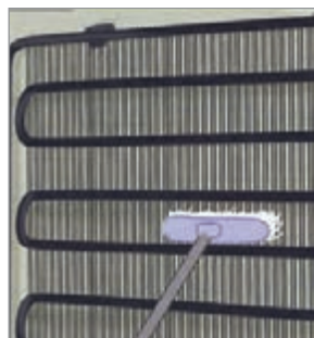
شکل ۵-۶ - تمیز کردن کندانسور یخچال
