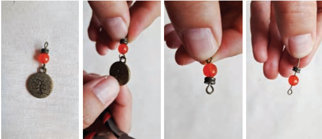
شکل ۹۵- مراحل ساخت اتصالات آویز گردن‌بند و مهره (مراحل کار از سمت راست به چپ)
