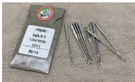
شکل ۲۱- سوزن ماشین دوخت
