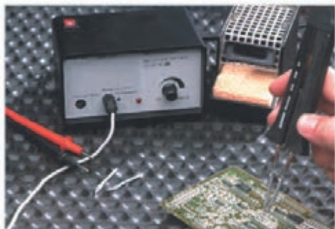
شکل ۵-۸- ابزار مورد نیاز برای کشیدن قطعات SMD از روی بُرد
