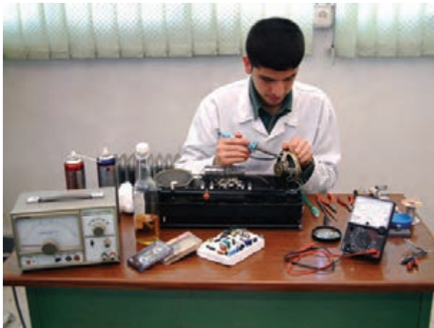
شکل ۱-۵- تعمیر و نگهداری یک دستگاه ضبط صوت
