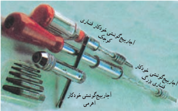
شکل ۴۰-۱- انواع پیچ گوشتی خودکار دستی
