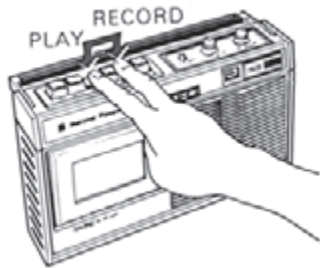
شکل ۳-۴۳- فشردن همزمان کلیدهای فشاری پخش (Play) و ضبط (Record)
