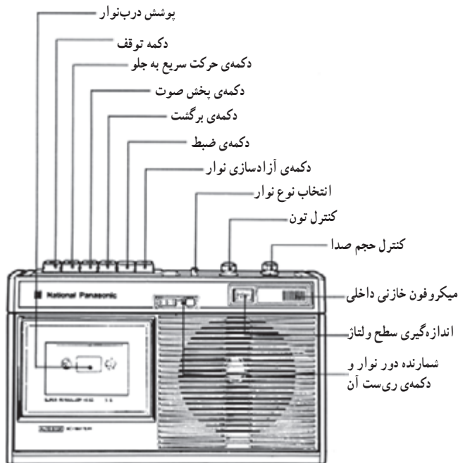
شکل ۲۷-۳- دستگاه ضبط صوت و دکمه‌های فشاری
