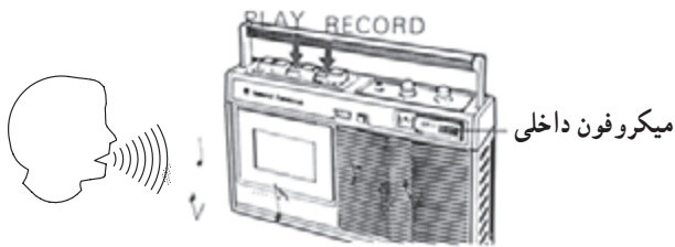
شکل ۲۶-۴- ضبط سیگنال از طریق میکروفون داخلی
