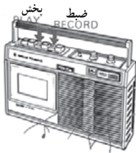
شکل ۲۵-۴ - فشردن کلیدهای ضبط و پخش
