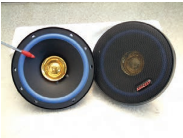
شکل ۱-۳۷- خود بلندگو را از نظر وجود سوراخ، آسیب‌مخروط، جدا شدن و یا قطع شدن در سیم‌پیچ بررسی کنید.
