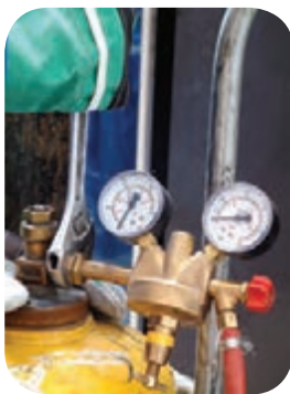
محکم کردن اتصالات رگولاتور به کپسول گاز
