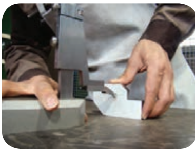
ترسیم خطوط موازی و انتقال اندازه ها بر روی قطعه کار
