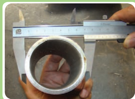
اندازه گیری قطر خارجی لوله توسط کولیس
