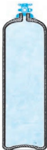
کپسول فولادی مخصوص برای ذخیره اکسیژن
