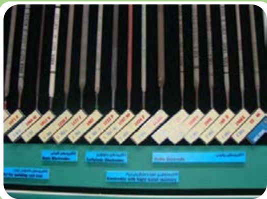
انواع مختلف الکترودهای روپوش‌دار از نظر نوع ترکیب پوشش
