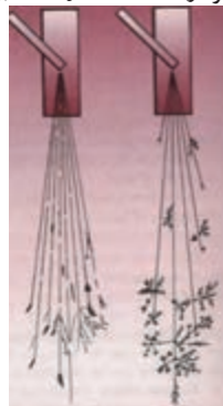
جرقه های ناشی از سنگ زدن روی فولادهای منگنز دار و تندبر
