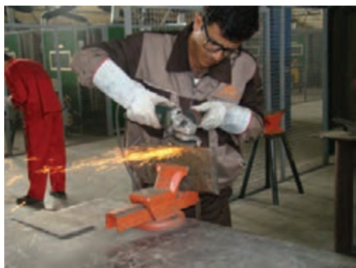
تشخیص نوع فولاد بر اساس آزمایش جرقه
