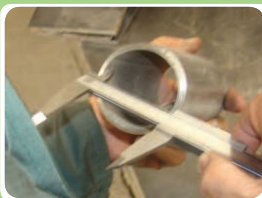
اندازه گیری قطر داخلی لوله توسط کولیس
