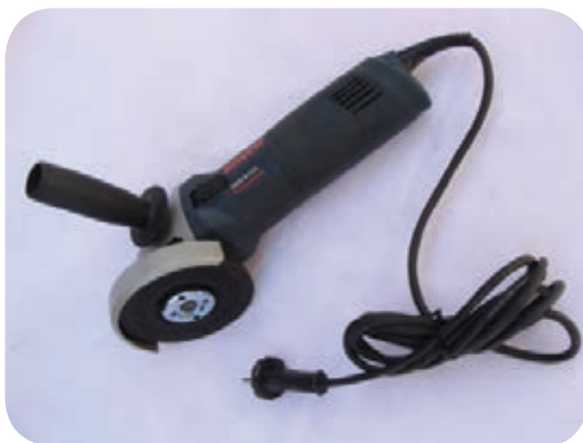
سنگ سنباده دستی و اجزای مربوط به آن
