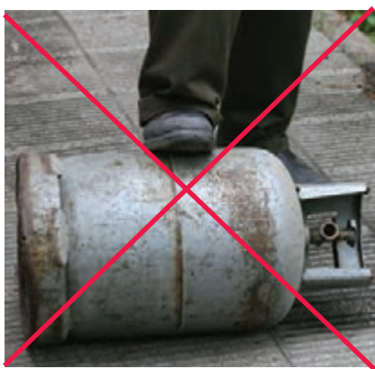
شکل ۱-۶۹ حمل و نقل نادرست کپسول گاز مایع
