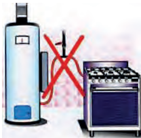
شکل ۳-۹ نصب نادرست آب‌گرم‌کن زمینی به جای
