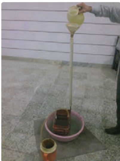
شکل ۱۷- اسید خروجی از ظرف دوم باید بدون کف باشد.
