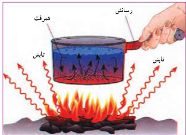
شکل ۱۱- انتقال گرما به هر سه روش
