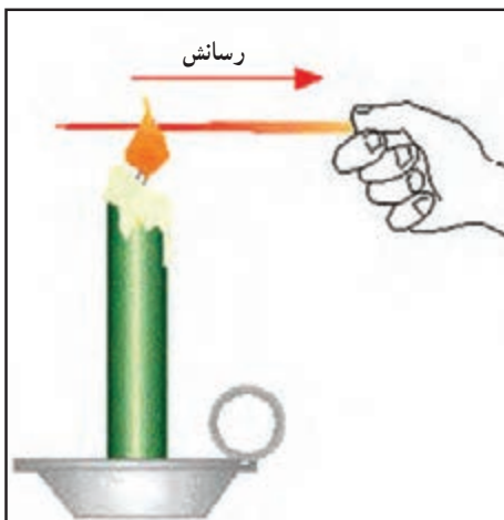
شکل ۸- رسانش در یک میله فلزی
