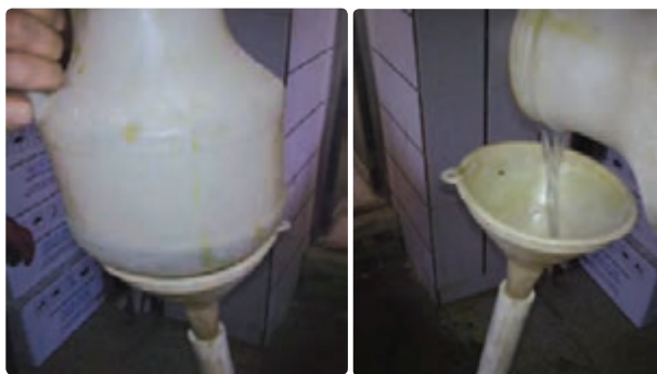
شکل ۱۸- شست و شوی مبدل بعد از رسوب‌زدایی
