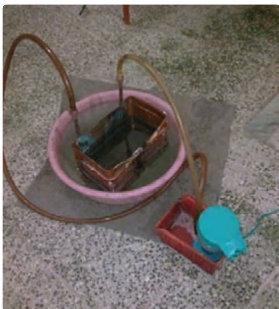
شکل ۱۹- رسوب‌زدایی با پمپ
