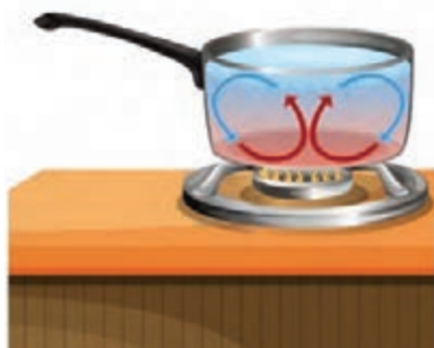
شکل ۹- همرفت در یک ظرف آب در حال گرم شدن
