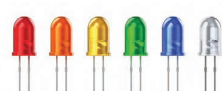
شکل ۲۸- دیودهای نوردهنده در انواع مختلف
