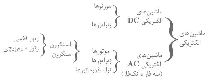
شکل ۳- تقسیم‌بندی کلی از ماشین‌های الکتریکی
