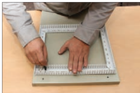
شکل ۴۱- داکت کشی روی صفحه نصب
