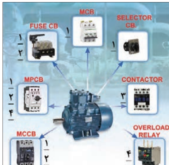
شکل ۱۰- قطعات مورد استفاده در تابلوهای راه انداز موتوری
