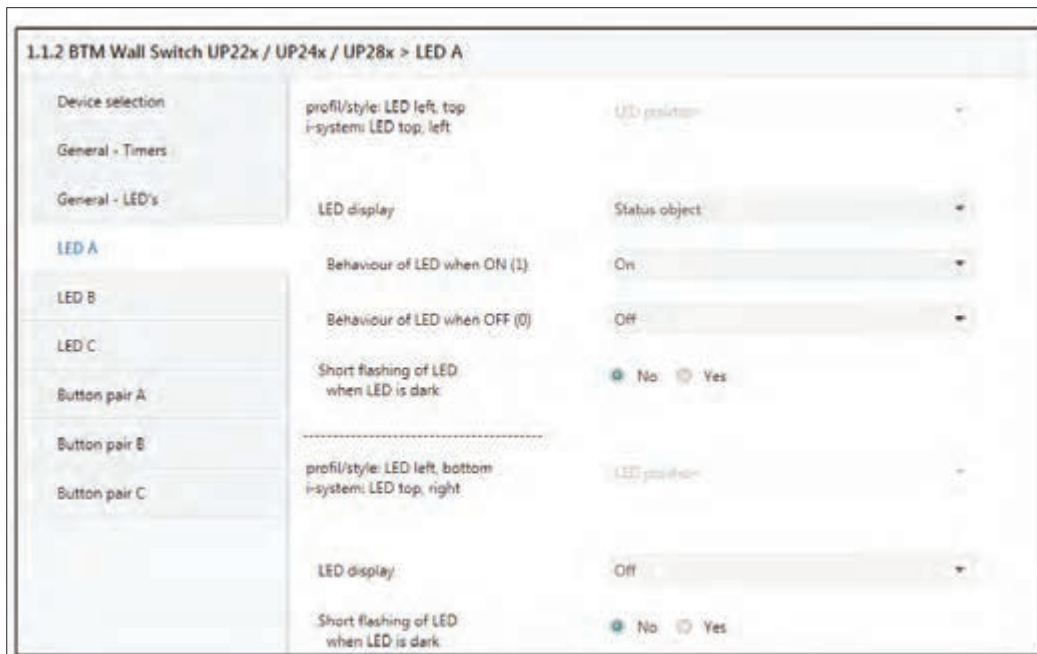
شکل ۶۰- ب - تنظیمات پارامترهای کلید دیواری
