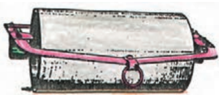
شکل ۵-۳- غلتک معمولی صاف
