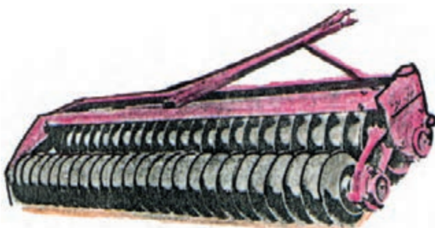
شکل ۵-۴- غلتک پره‌ای دو ردیفه
