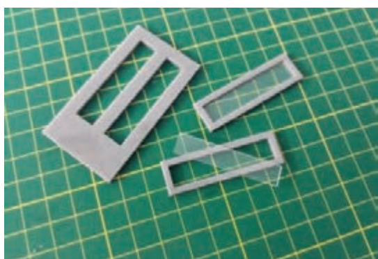
شکل ۵-۷۰- برش اجزای بدنه و درها
