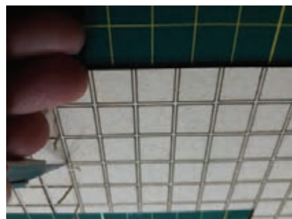
شکل ۹۲-۵- ایجاد شیار روی سقف
