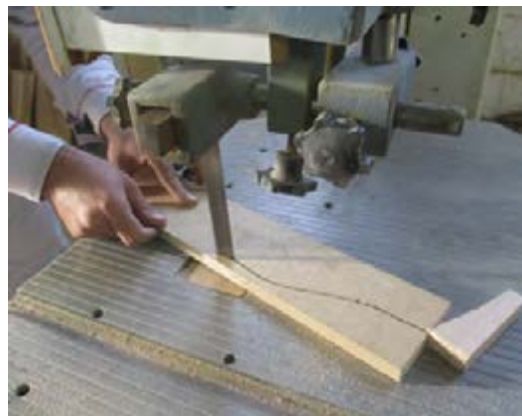
شکل ۶۲- عملیات قوس‌بری با دستگاه اره نواری
