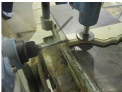
شکل ۶۵- عملیات اتصال دوبل با دستگاه کم‌کن
