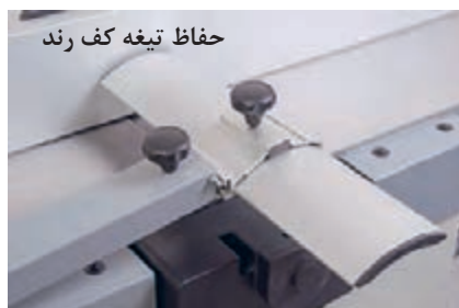
شکل ۳- نمونه‌هایی از حفاظ‌های مخصوص تیغه هر دستگاه
