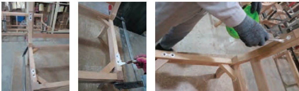
شکل ۵۹- چسب زدن محل اتصالات دسته مبل
