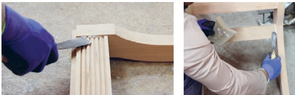
شکل ۶۷- تمیز کردن چسب اضافی با کاردک
