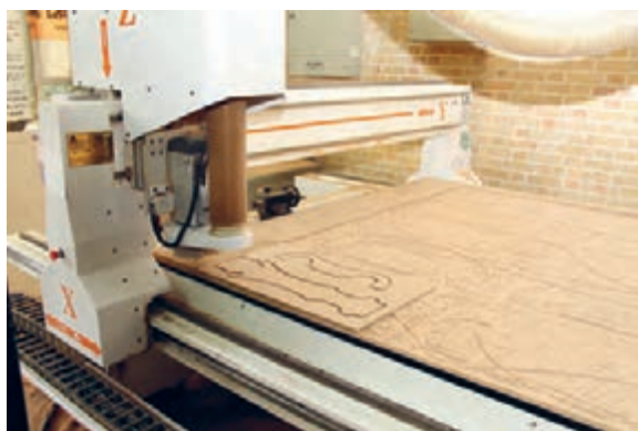
شکل ۶۷- تهیه شابلون با دستگاه فرز CNC
