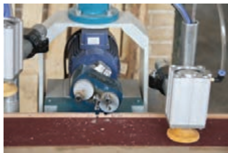
شکل ۳۸- ایجاد اتصال با دستگاه دوپل زن نیمه‌اتوماتیک
