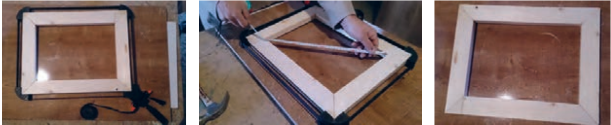
شکل ۲۵- کنترل دوئیدگی و صحیح بودن قاب
