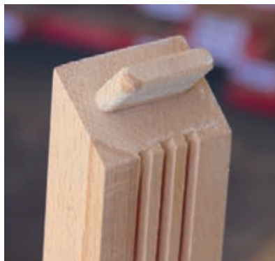
شکل ۵۹- اتصال کام تحت زاویه ۴۵ درجه
