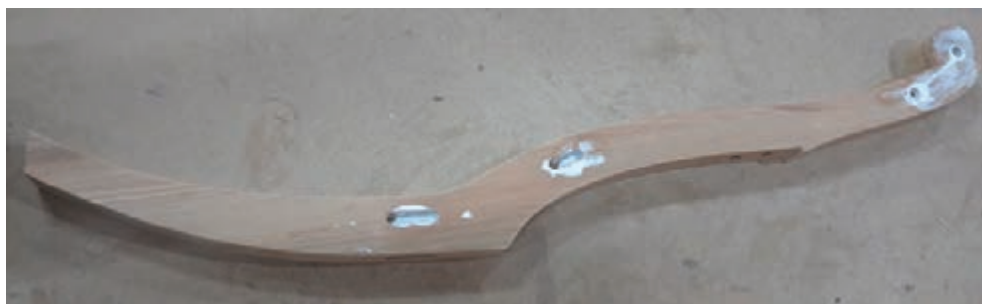
شکل ۴۶- روش چسب زدن اتصال دوبل پایه‌های عقب
