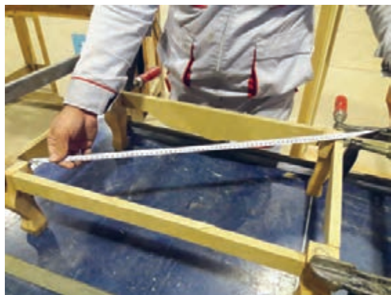
شکل ۷۲- مونتاژ به وسیله گیره دستی و کنترل دوئیدگی
