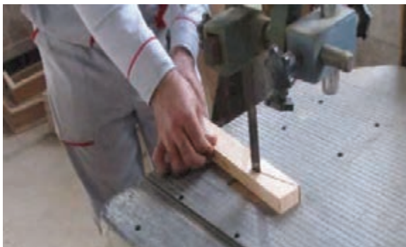
شکل ۶۳- پایان قوس بری با دستگاه اره نواری
