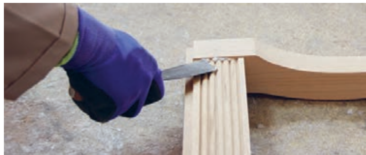
شکل ۱۰۲- تمیز کردن چسب اضافی با کاردک
