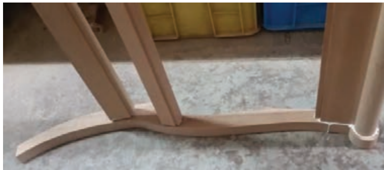
شکل ۴۸- جا زدن پشتی مبل
