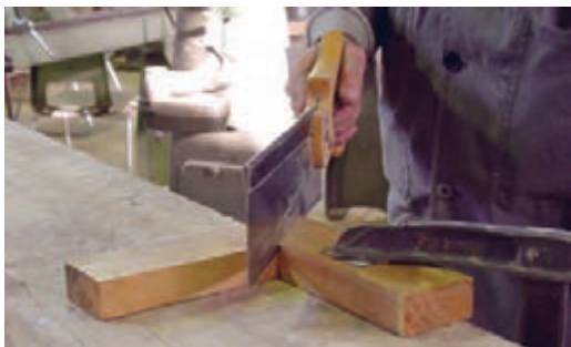
شکل ۲۱ - چگونگی اره‌کشی درز بین اتصال
