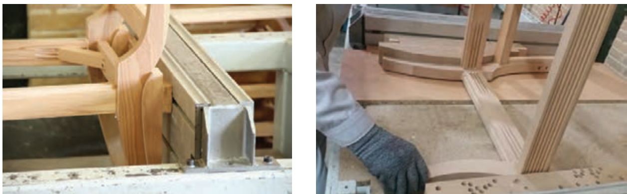
شکل ۵۵- جا زدن اتصالات با تنگ پنوماتیکی
