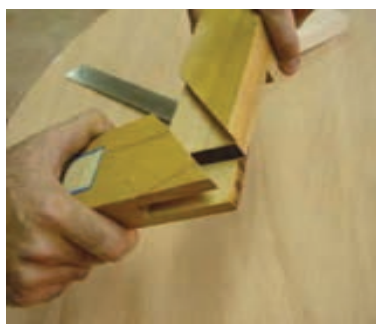
شکل ۱۸- چگونگی خط کشی و مونتاژ اتصال یک رو فارسی
