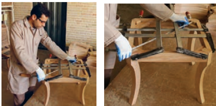
شکل ۶۹- کنترل دوئیدگی با متر
