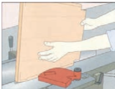
پرداخت کردن کفی با دستگاه کفرند
