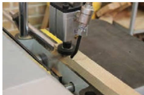
شکل ۴۰- اتصال کام با دستگاه کام کن نیمه اتوماتیک
