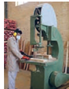
شکل ۷۷- وضعیت گرفتن چوب و هدایت آن با چوب کمکی و ابعاد استاندارد چوب کمکی
