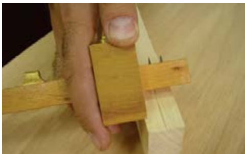
شکل ۵۳- اندازه‌گذاری به وسیله خط‌کش تیره‌دار
