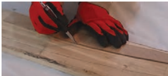
شکل ۴۳- انتقال الگوی پایه میز عسلی، از شابلون به روی
