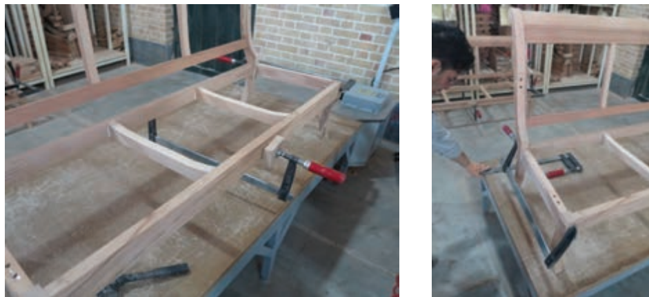
شکل ۵۶- جا زدن اتصالات با گیره دستی
