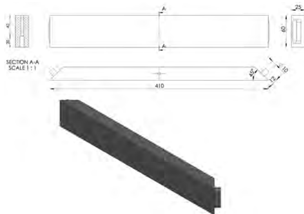
شکل ۱۵- پرسپکتیو قید اسکلت به همراه برش و اندازه گذاری
