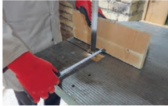
شکل ۷۴- اندازه‌گیری فاصله تیغه با گونیا
