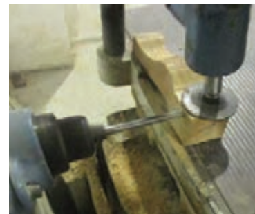
شکل ۶۵- عملیات اتصال دوبل با دستگاه کم‌کن
