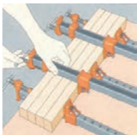
شکل ۱۴- چسباندن و عریض کردن چوب ها به وسیله چسب و گیره دستی
