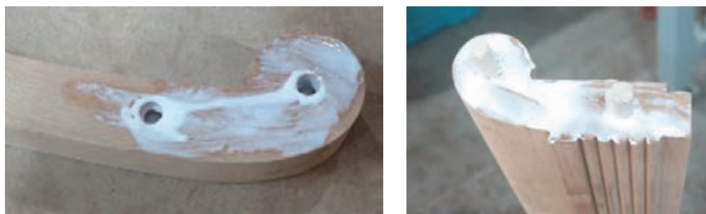
شکل ۴۶- روش چسب زدن اتصال دوبل پایه‌های عقب
