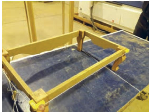
شکل ۷۱- مونتاژ به وسیله گیره کمربندی
