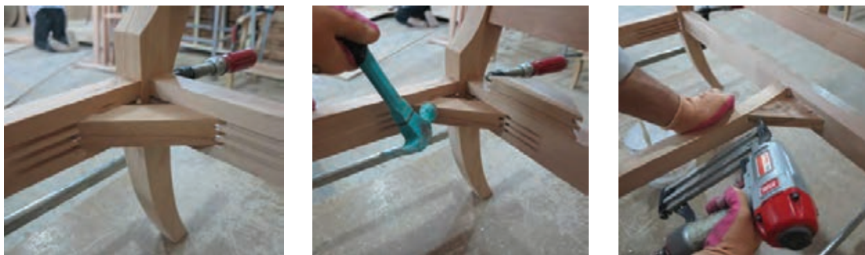
شکل ۵۸- جا زدن نبشی‌های گوشه
