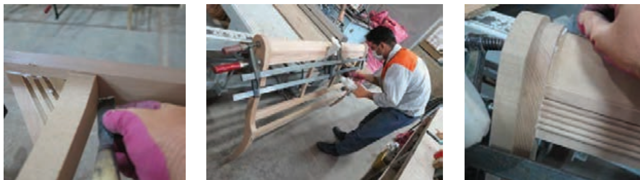
شکل ۵۲- تمیز کردن چسب اضافی روی قطعه کار
