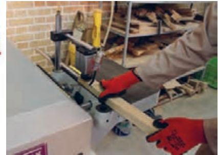
شکل ۵۴- کام کندن چوب با دستگاه کام کن نیمه اتوماتیک
