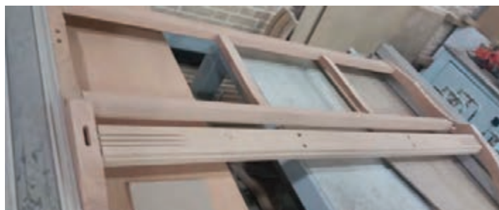
شکل ۵۰- جا زدن پشتی مبل با تنگ پنوماتیک
