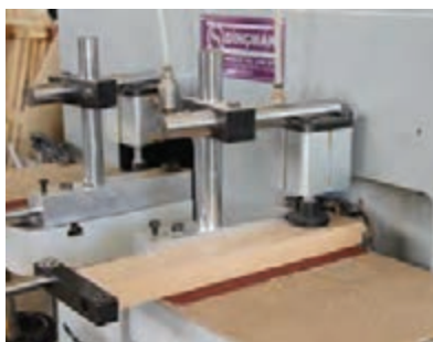
شکل ۴۲- ساخت زبانه با دستگاه زبانه زن نیمه اتوماتیک
