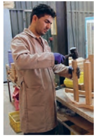
شکل ۱۰۱- استفاده از چکش لاستیکی برای جا زدن زبانه‌ها و مراحل مونتاژ پایه‌ها و قیده‌های جلو
