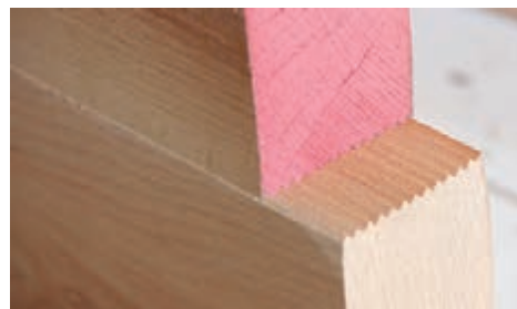
شکل ۱۳- اتصال انگشتی ساخته شده با دستگاه فرز
