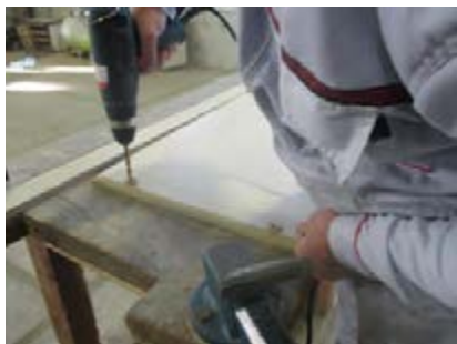
شکل ۶۶- عملیات اتصال دوبل به وسیله دریل دستی
