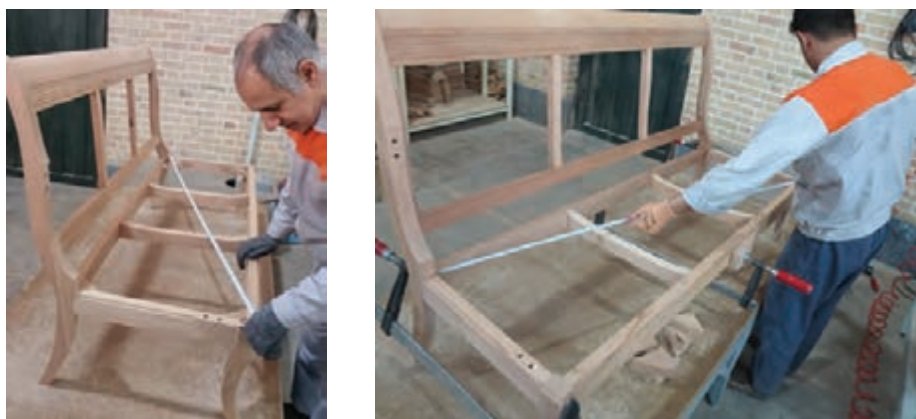
شکل ۵۷- کنترل دوئیدگی (گونیا)ی کردن کار) با متر
