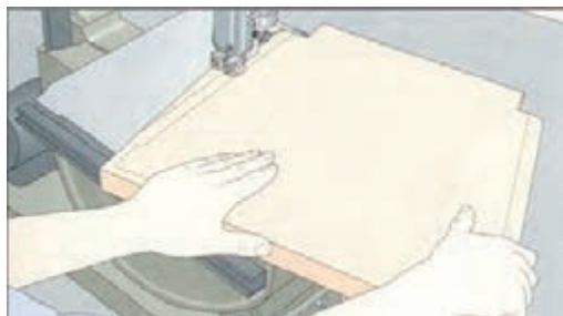
بریدن کفی توسط دستگاه اره نواری
