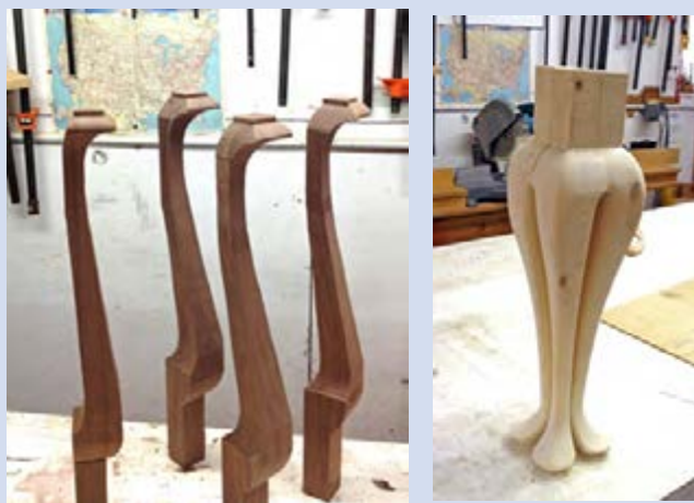
شکل ۵۱- آماده شدن پایه‌ها برای ایجاد کام
