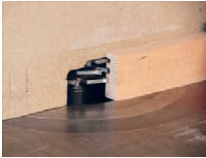
شکل ۶۱- تیغ فرز مخصوص زهوار صفحه
