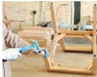
شکل ۱۱۳- نصب پایه پلاستیکی کف پایه با چکش فلزی
