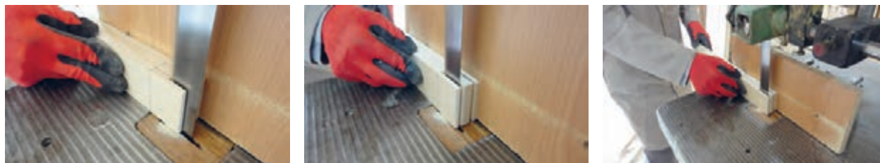
شکل ۹۰- عملیات برش زبانه با دستگاه اره نواری
