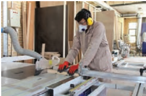
شکل ۳۶- یک اندازه کردن قیدها با دستگاه اره مجموعه‌ای
