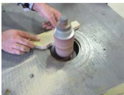
شکل ۶۴- عملیات پرداخت با دستگاه فرز میزی (تویی سنپاده)
