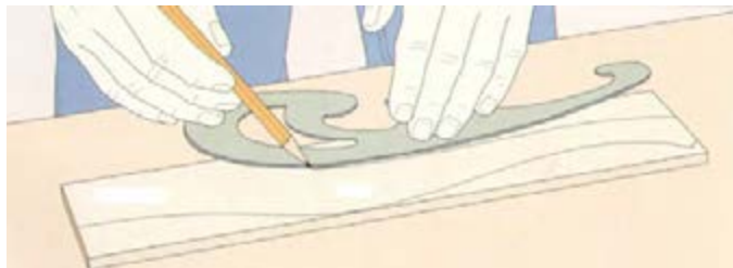
شکل ۴۲- آماده کردن الگوی پایه به وسیله پیستوله
