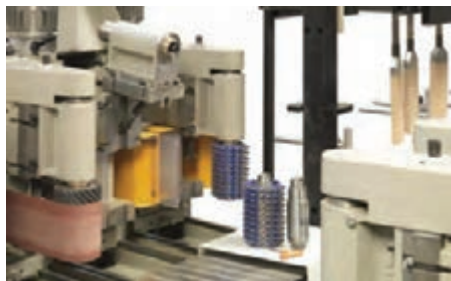
شکل ۳۹- پرداخت قطعه کار به وسیله دستگاه اتوماتیک شیپر
