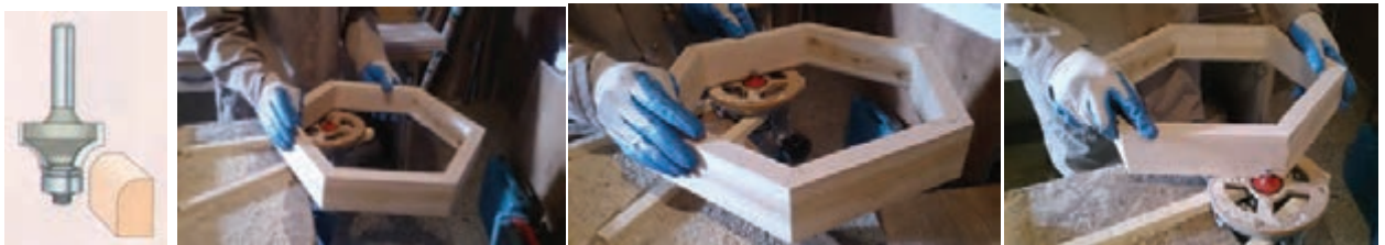
شکل ۳۹- پرداخت با تیغ نیم‌گرد به وسیله دستگاه اورفرز دستی
