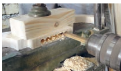
شکل ۸۸- عملیات کم کنی با دستگاه سه کاره
