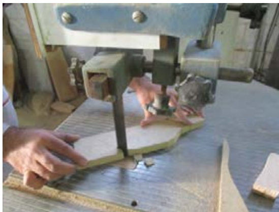
شکل ۶۲- عملیات قوس‌بری با دستگاه اره نواری
