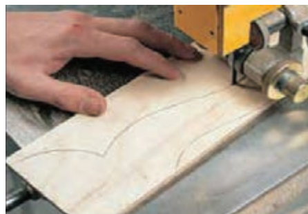
شکل ۳۵- برشکاری و پرداخت پایه جلو مبل یک نفره
