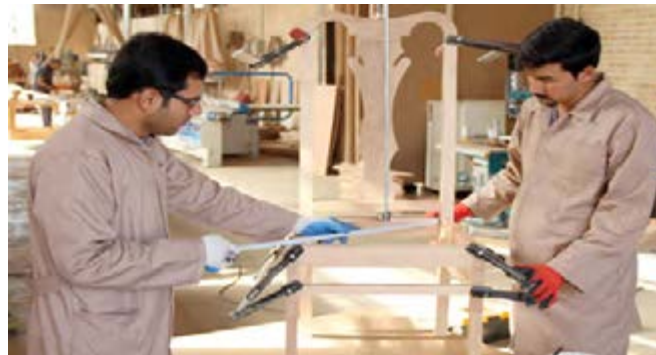
شکل ۱۰۹- کنترل دوئیدگی با متر
