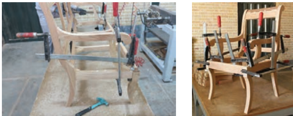
شکل ۶۲- بستن دسته و زیر دسته با گیره دستی
