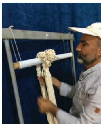
شکل ۳-۴- انتقال سردار بر روی دار فندک دار
