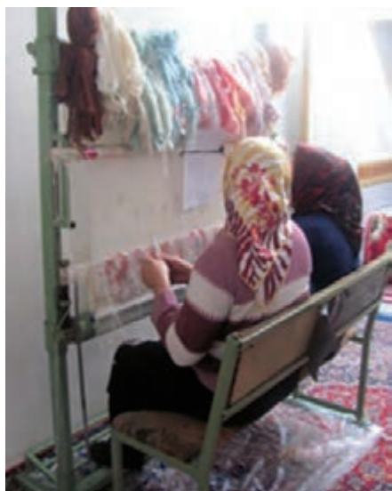
شکل ۱۲-۱- زیر دار و سردار هر دو گردان (شفتی)
