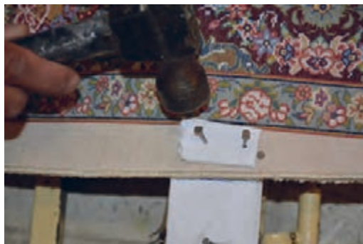
شکل ۲۴-۵ - ثابت کردن فرش با میخ
