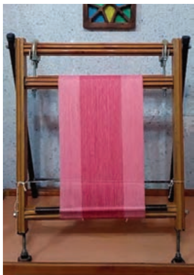
شکل ۱-۴- دار قالی بافی عمودی
