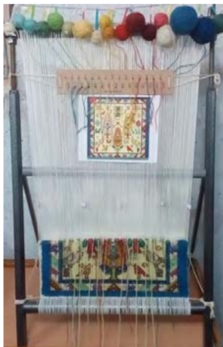
شکل ۹-۱- زیر دار ثابت و سردار متحرک (مدل ۱)
