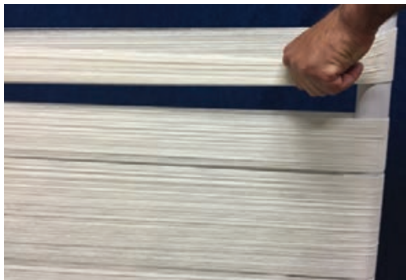
شکل ۳۰-۲- تنظیم تارها بر روی میله
