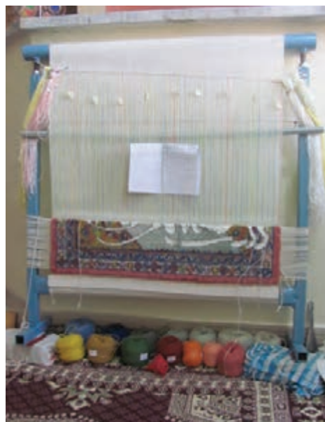
شکل ۱۰-۱- زیر دار ثابت و سردار متحرک (مدل ۲)
