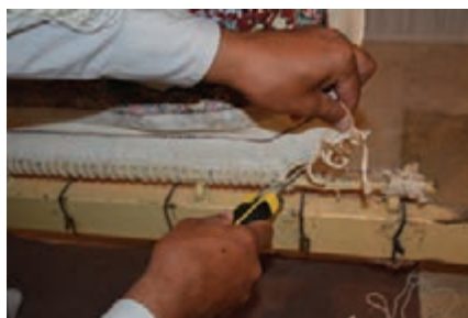
شکل ۱۳-۵ - بریدن دوخت ابتدای چله
