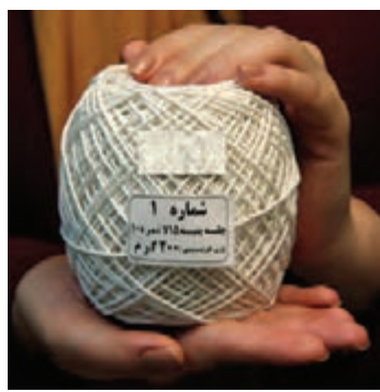
شکل ۱۷-۲- توپک ۲۰۰ گرمی، چله پنبه ای ۱۵ لا نمرة ۱۰
