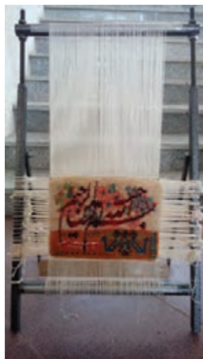
شکل ۱۵-۴- پیچیدن پودها به دور راست روها
