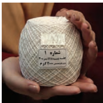
شکل ۱۸-۲- توپک ۲۰۰ گرمی، چله پنبه ای ۱۸ لا نمرة ۲۰
