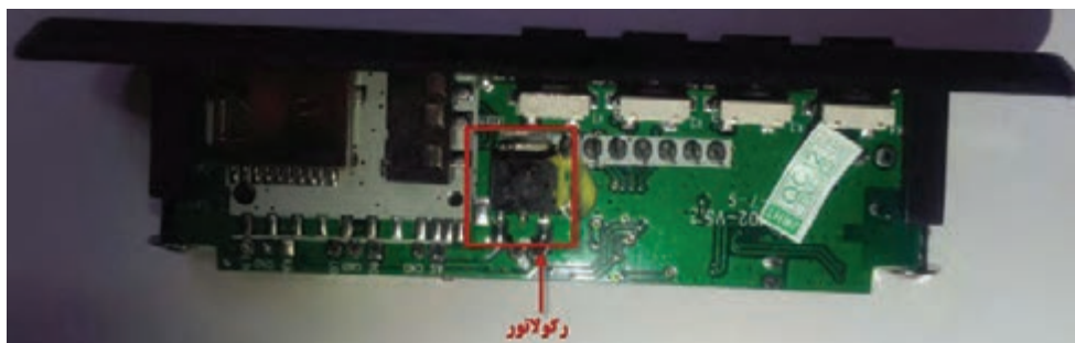
شکل ۵-۸- برد MP۳ با رگولاتور ۷۸۰۵ داخلی
