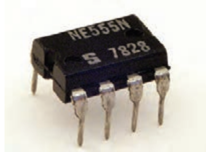
شکل ۲-۲۰- آی سی تایمر NE۵۵۵
