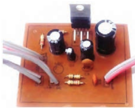
شکل ۴-۹۰- مدار مونتاژ شده تقویت کننده
