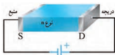
شکل ۴-۱۷- نیمه‌هادی با ناخالصی N به عنوان کانال
