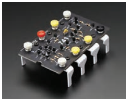
شکل ۵۴-۴ مدار داخلی آی سی ۷۴۱ با قطعات مجزا
