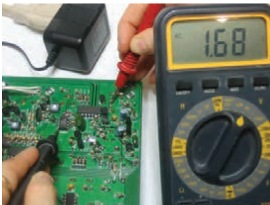
شکل ۵-۵- ولتاژگیری در مدار
