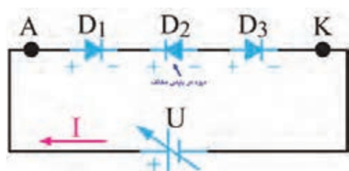
شکل ۷-۴ دیود چهار لایه در بایاس موافق
