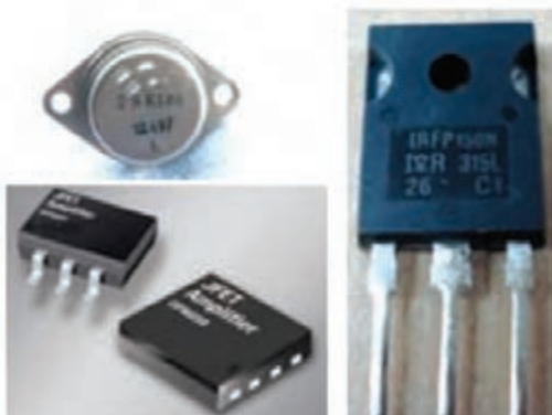
شکل ۴-۴۳ نمای ظاهری چند نمونه MOSFET
