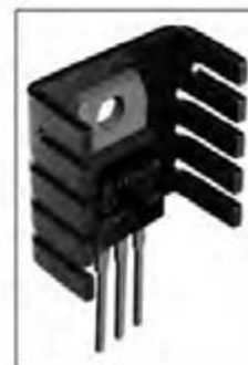
شکل ۷-۶۸ ترایاک متصل شده به گرماگیر
