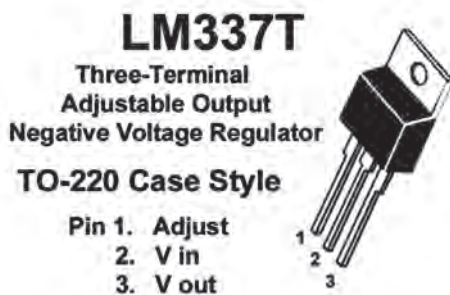
شکل ۱۶-۲: شکل ترانسفورماتور کاهنده ۲۲۰ به ۱۸ ولت دوبل شکل ۱۷-۲: ترتیب پایه های آی سی رگولاتور LM337
