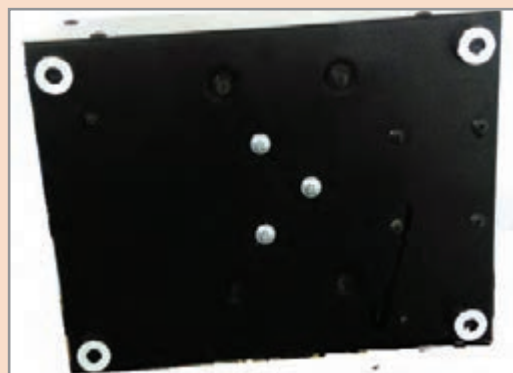
شکل ۱-۴ سه پیچ قفل کننده کمپرسور به بدنه
