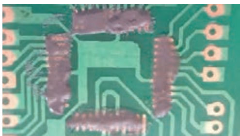
شکل ۳-۹ قرار گرفتن خمیر قلع روی تمامی پدها
