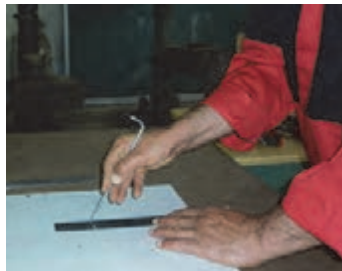
شکل ۱۴- استفاده از خطکش و سوزن خطکش
