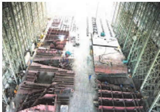
شکل ۵- جوش کاری بلوک کشتی
