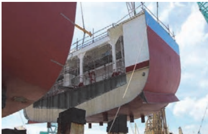
شکل ۸- اتصال بلوک‌های کشتی
