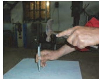
شکل ۱۳- استفاده از سنبه برای نشانه‌گذاری
