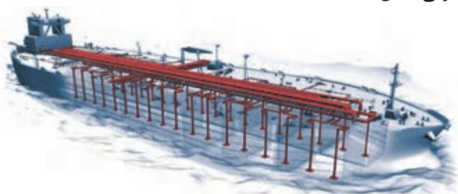
شکل ۲۱- خم کاری لوله در ساختمان یک نفتکش
