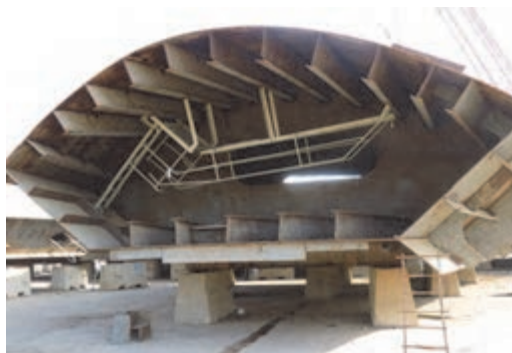
شکل ۶- اتمام جوش کاری بلوک کشتی
