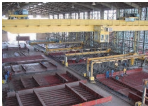
شکل ۴- اسمبل کردن بلوک کشتی
