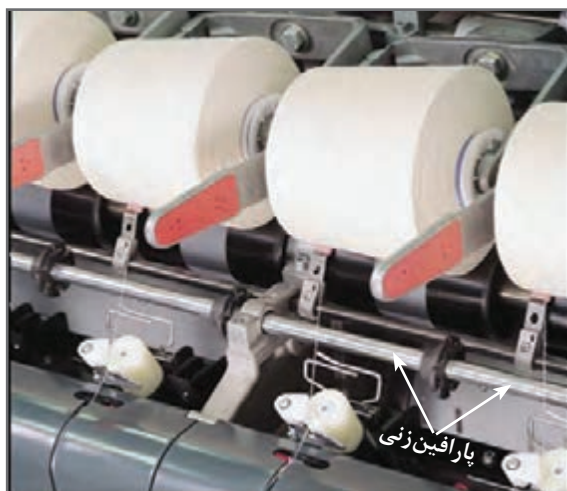
شکل ۳۰ - پارافین زدن به نخ
