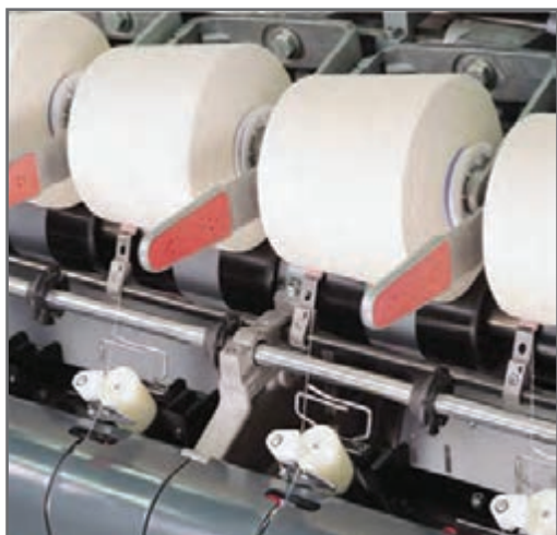
شکل ۲۵ - راهنمای متحرک پیچش نخ (تراورس)
