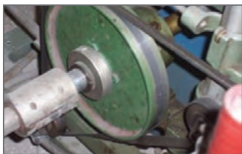
شکل ۱۸- پولی و تسمه انتقال حرکت
