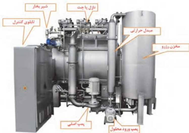
شکل ۷ تصویر قسمت‌های اصلی یک ماشین رنگری جت
