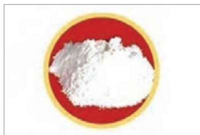
شکل ۱۳-۴ روان ساز پودری مورد استفاده در زردجوش
