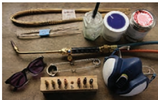
شکل ۷-۴- تجهیزات مورد استفاده فرایند زردجوش
