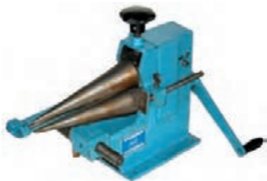
شکل ۲-۲۲ نورد خاص در تولید مخروط ناقص
