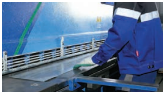
شکل ۲-۱- برش‌کاری با گیوتین
