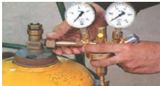
شکل ۳-۱۸- بستن رگولاتور به کپسول
