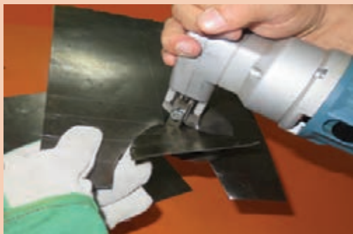
شکل ۳۵-۱- برش کاری با قیچی نیبلر
