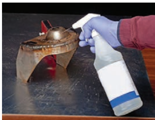
شکل ۴-۲۲- تمیزکاری بعد از جوشکاری توسط محلول شیمیایی
