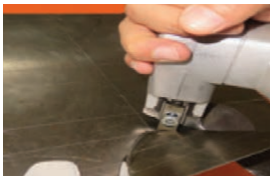
شکل ۱-۳۱- روش برش کاری با نیبلر دستی
