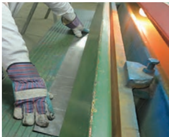
شکل ۷-۱- تنظیم خط برش با چشم توسط اپراتور
