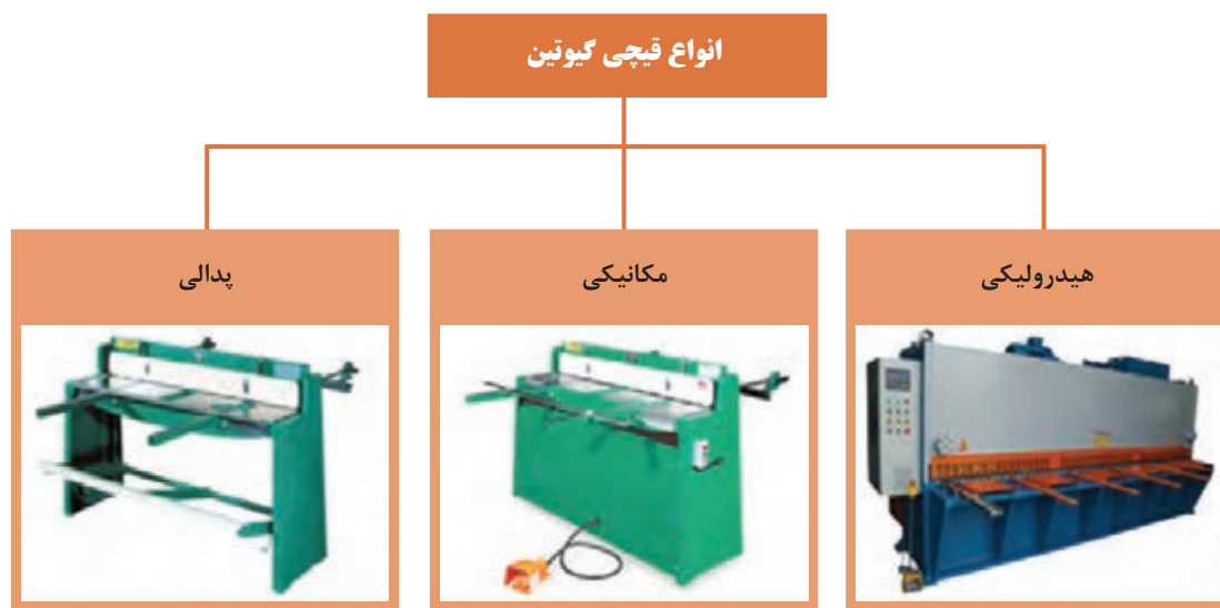
شکل ۳-۱- انواع گیوتین از نظر نحوه انتقال قدرت
