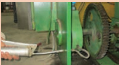
شکل ۱-۱۶- سرویس دوره‌ای گیوتین
