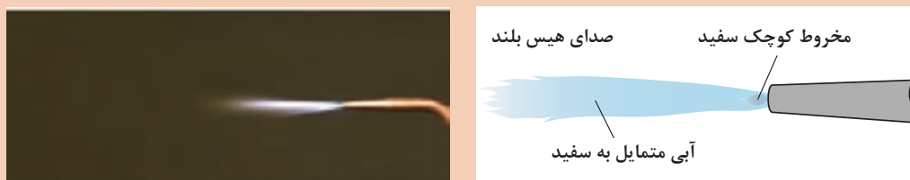
شکل ۳-۴۰- تنظیم شعله اکسید
