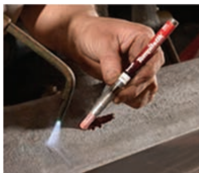
شکل ۴-۱۸- اندازه‌گیری دما توسط گچ‌های حرارتی
