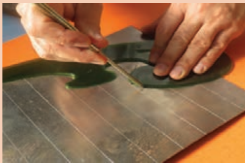
شکل ۳۴-۱- خط کشی ورق فلزی با پیستوله
