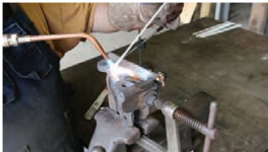
شکل ۴-۱۵- فیکسچر مورد استفاده شده در فرایند زردجوش
