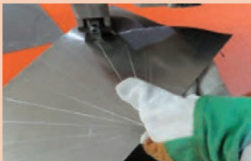
ب) برش کاری منحنی با نیبلر
