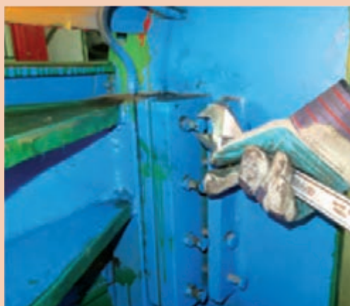
شکل ۱-۱۸- رفع عیوب برش کاری
