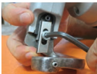
شکل ۱-۲۸- تنظیم فاصله افقی و عمودی تیغه‌ها
