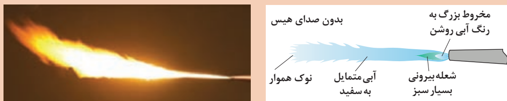
شکل ۳-۳۹- تنظیم شعله احیا (کربن ده)
