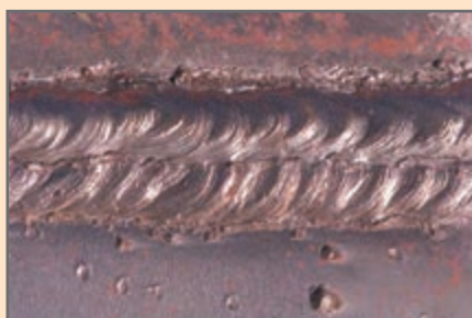
شکل ۴۰-۱ اندازه گرده جوش در پاس پوششی
