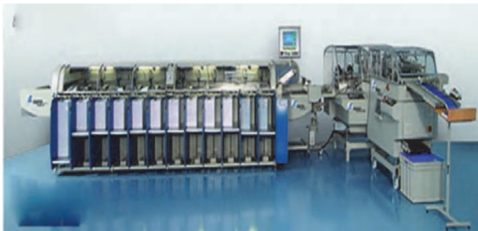
شکل ۶۹- ماشین ترتیب افقی
