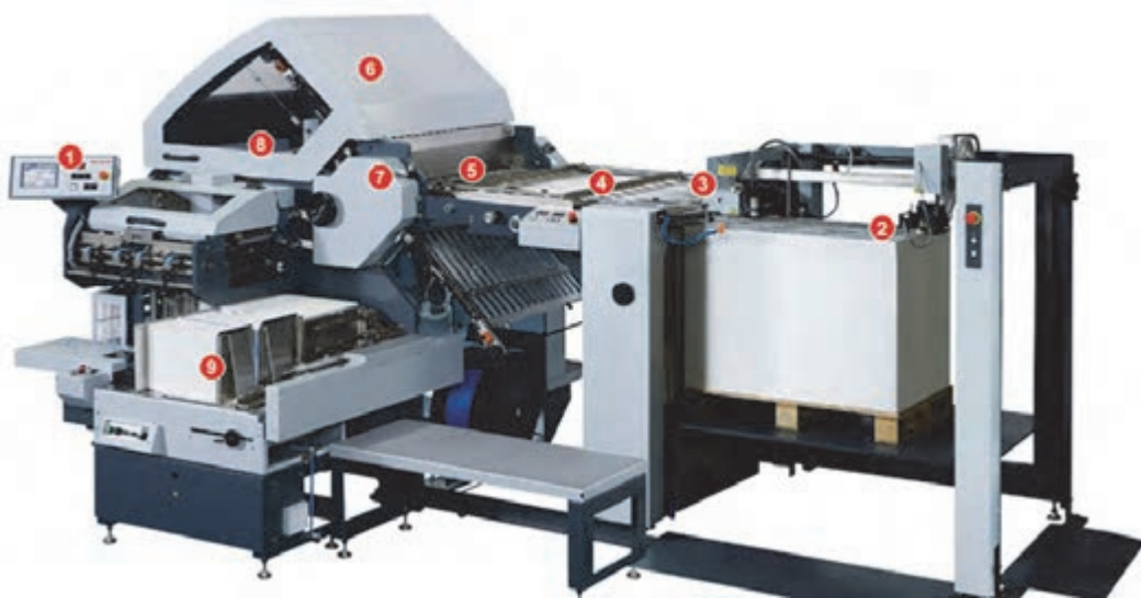
شکل ۵۰- قسمت های اصلی ماشین ورق تاکنی
