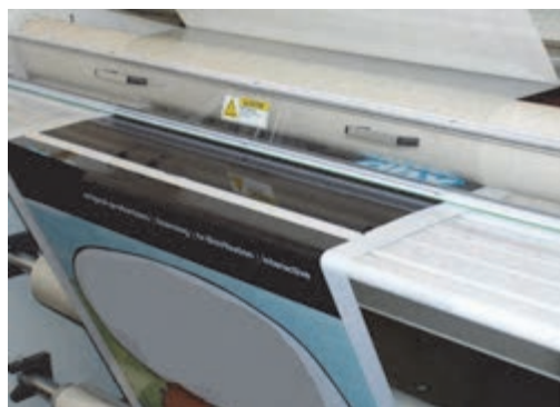
شکل ۴۳ - لمینیتور رول سرد
