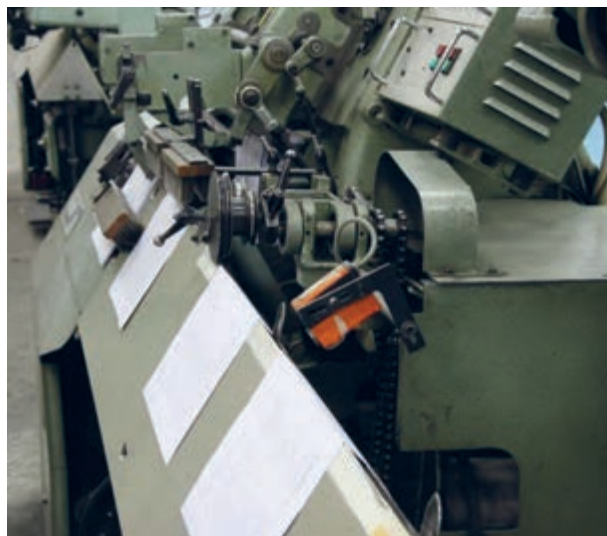
شکل ۲۴- صفحه انتقال دهنده فرم و قطعات آن
