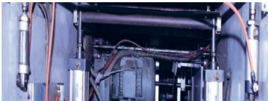
شکل ۳۸- جک های هیدرولیک سیلندر ضربه زننده
