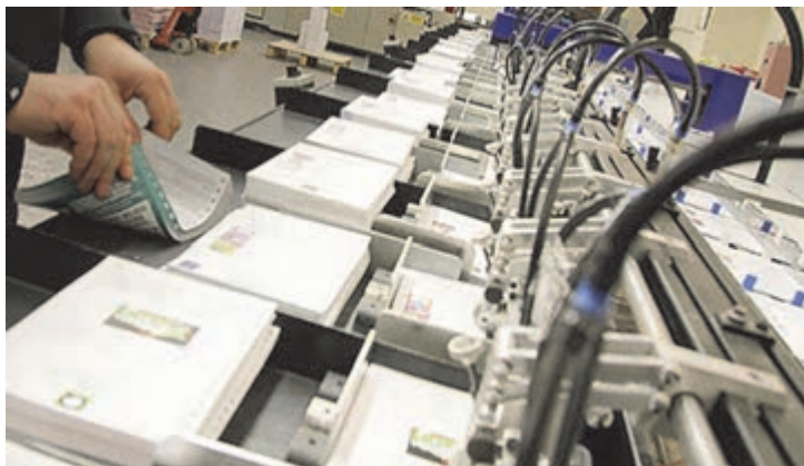
شکل ۷۱- ماشین ترتیب‌کن افقی
