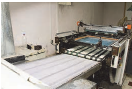
شکل ۱۷- سیستم شابلونی ورنی زنی را به همراه پنجه‌ها و روزنه‌های سیلندر
