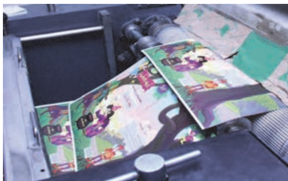
شکل ۱۴- تنظیم قسمت تحویل دستگاه ورنی زنی اسکرین
