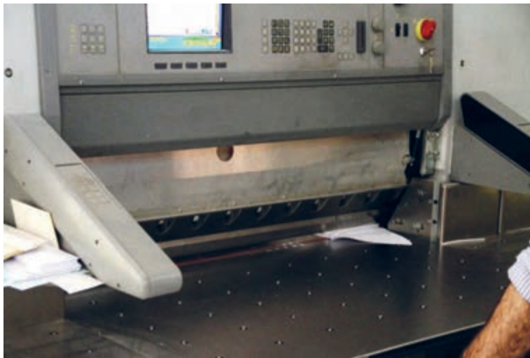
شکل ۷- برش گیوتینی در حال برش بلوک
