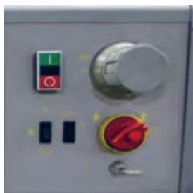
شکل ۳۸- درجه تنظیم فشار دستگاه برش
