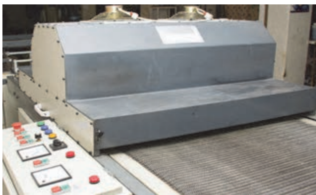
شکل ۱۰- تنظیم به‌کارگیری تعداد لامپ‌های خشک‌کن
