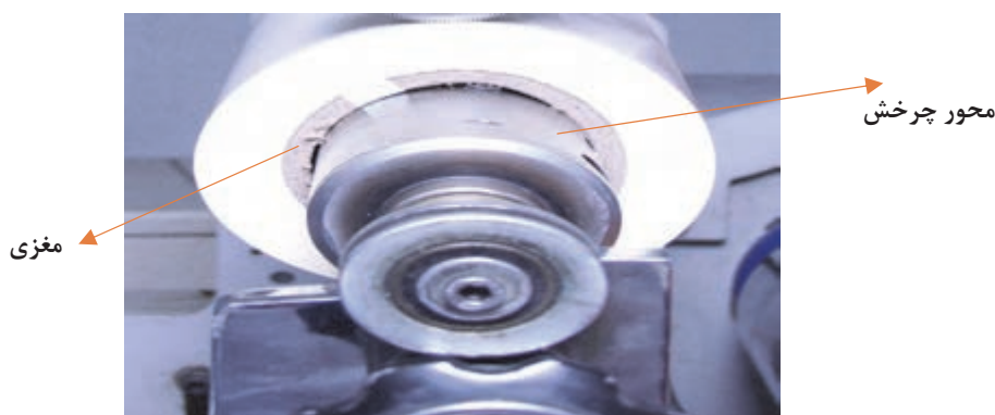
شکل ۲۹- تناسب مغزی سلفون با محور چرخشی دستگاه
