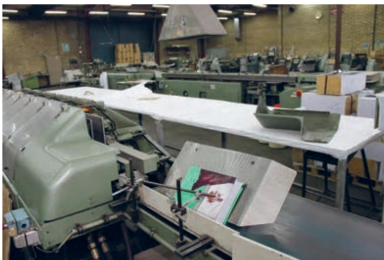
شکل ۶۴- قسمت تحویل دستگاه جلدگذاری
