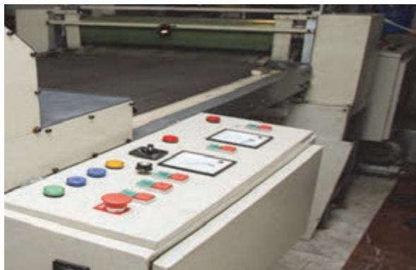
شکل ۹- صفحه انتقال و تنظیم سرعت
