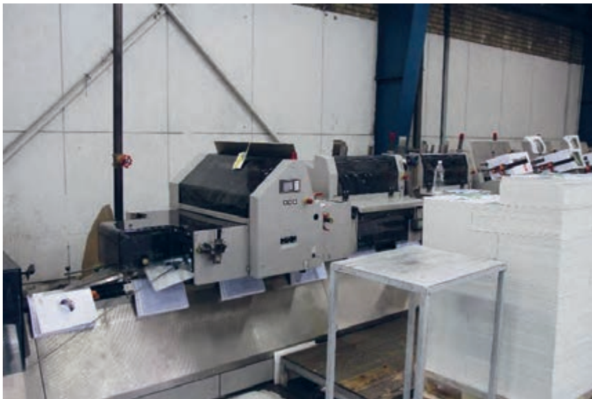
شکل ۴۰- ماشین‌های مفتول‌زنی اتومات
