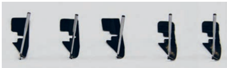
شکل ۳۱- تیغه‌های برش دستگاه دوخت
