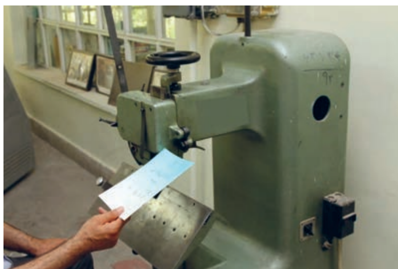
شکل ۳۸- تنظیم‌کننده ضخامت بلوک و طول مفتول
