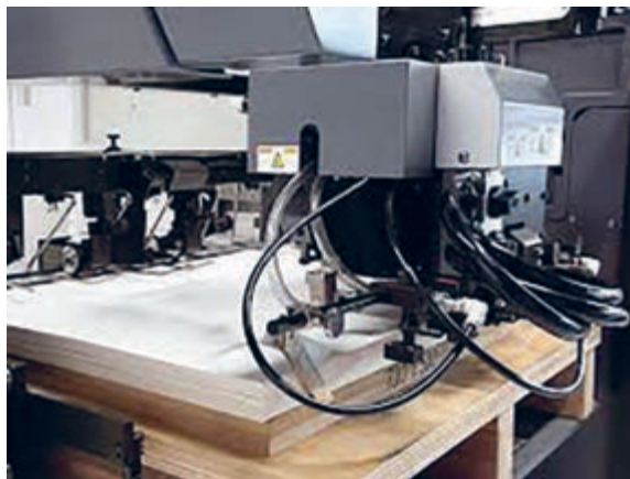
شکل ۳- نحوه قرارگیری کاغذ در تخته تغذیه ماشین افست
