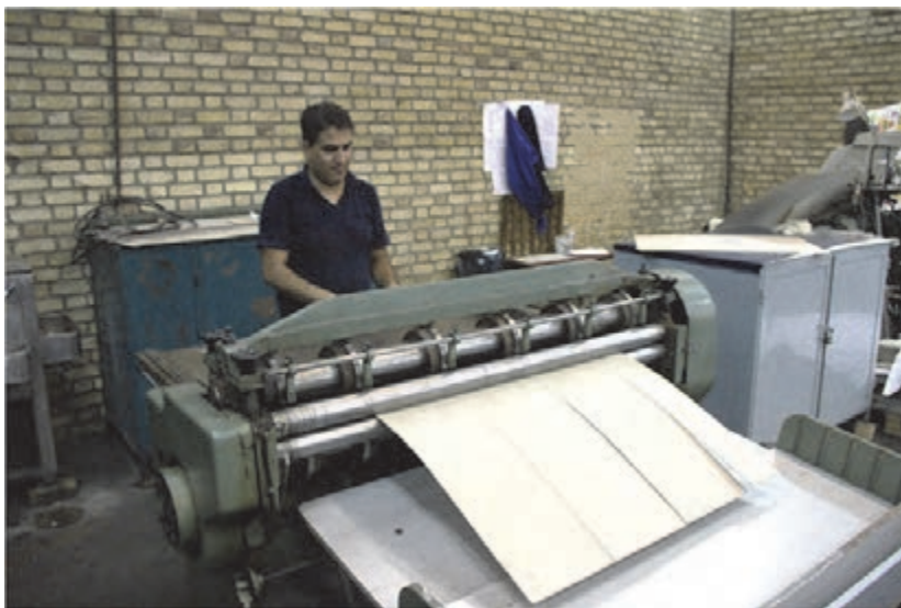
شکل ۴۶- برش لتهای جلد با دستگاه مقوایر
